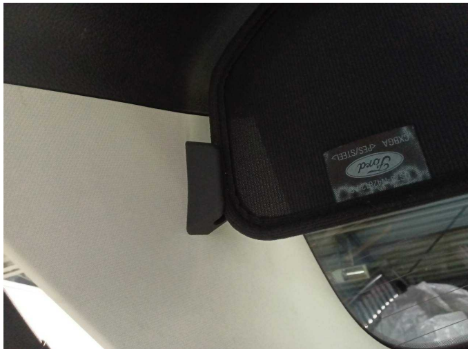
Damage 1: Misc.: Misc. (Sonnenblende befestigung) - Missing - Replace
