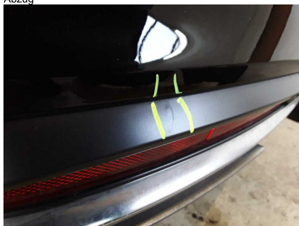
Beschädigung #5: Stossfänger hinten: Spoiler (Druckstellen) - Wertminderung
