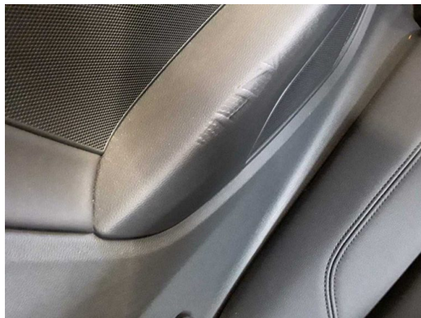
Beschädigung #2: Interieur: Innenraum (Druckstellen) - kein Abzug
