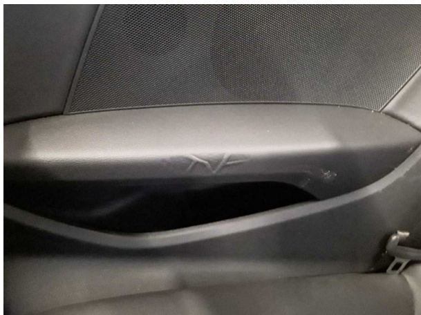
Beschädigung #2: Interieur: Innenraum (Druckstellen) - kein Abzug
