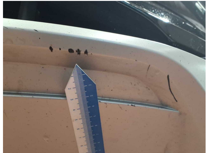
Damage 7: Front bumper: Spoiler (rechts + Rammschutz) - Scratch(es) - Paint
