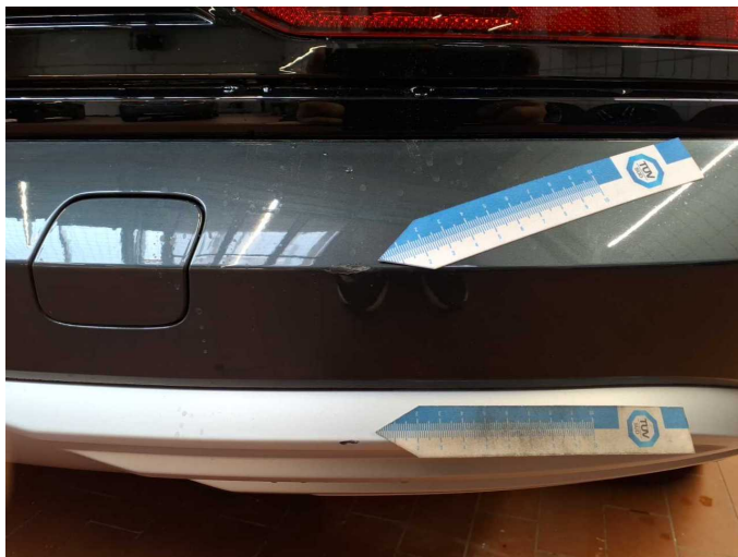
Damage 8: Rear bumper: Rear bumper (Oben+unten+Spoiler ersetzen) - Scratch(es) - Paint
