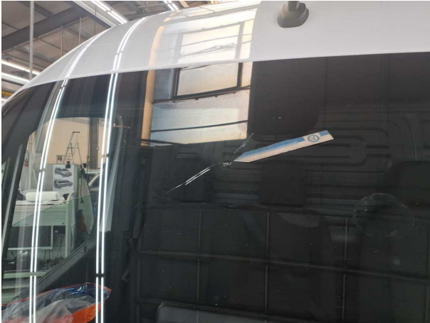
Beschädigung #22: Verglasung: Frontscheibe mit Spurhalteassistent - gebrochen / gerissen - erneuern
