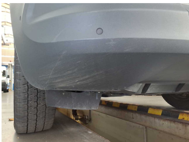
Beschädigung #18: Stossfänger vorn: Stossfänger mit Parktronic - verkratzt / verschürft - Smart Repair
