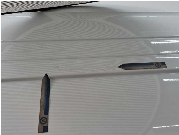
Beschädigung #14: Fahrzeugdach: Dach (Seitenteil hinten links) - Delle / Lackschaden - Smart Repair
