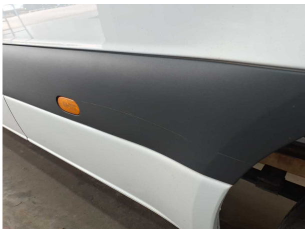
Beschädigung #10: Seitenwand links: Schutzleiste (Vorn) - verkratzt / verschürft - erneuern
