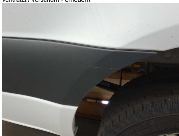
Beschädigung #9: Seitenwand rechts: Schutzleiste (Hinten) - verkratzt / verschürft - erneuern
