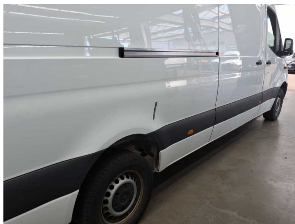
Beschädigung #6: Seitenwand rechts: Seitenwand - Delle(n) - Smart Repair
