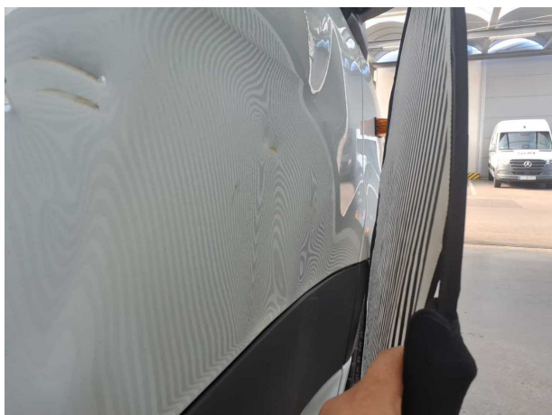
Beschädigung #23: Tür vorn rechts: Tür - verformt - erneuern
