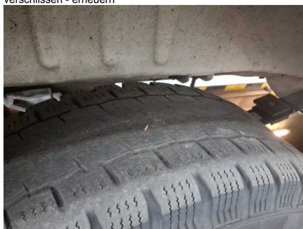
Beschädigung #19: Rad/Reifen: Reifen hinten links - verschlissen - erneuern
