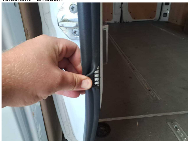
Beschädigung #12: Schiebetür rechts: Türdichtung - gebrochen / gerissen - erneuern
