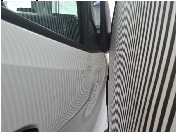
Beschädigung #23: Tür vorn rechts: Tür - verformt - erneuern
