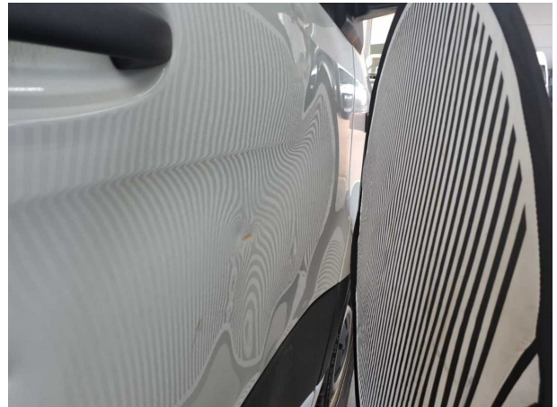
Beschädigung #23: Tür vorn rechts: Tür - verformt - erneuern
