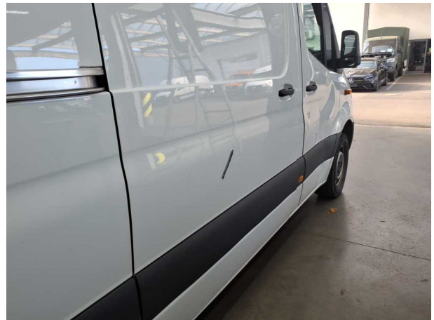
Beschädigung #15: Schiebetür rechts: Schiebetür - Delle(n) - Smart Repair
