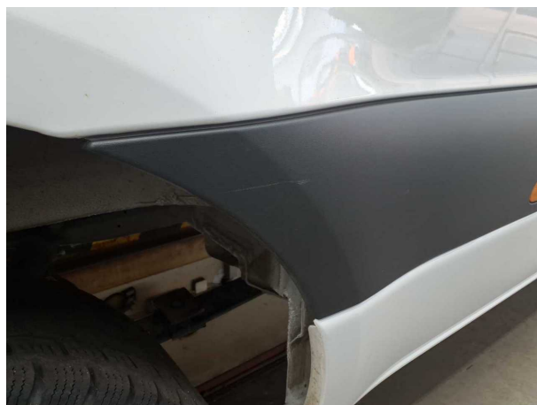
Beschädigung #11: Seitenwand rechts: Schutzleiste (Vorne) - verkratzt / verschürft - erneuern
