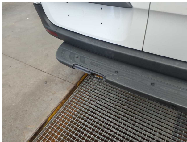
Beschädigung #21: Stossfänger hinten: Stossfänger Auftritt mit Parktronic (komplett) - gebrochen / gerissen - erneuern
