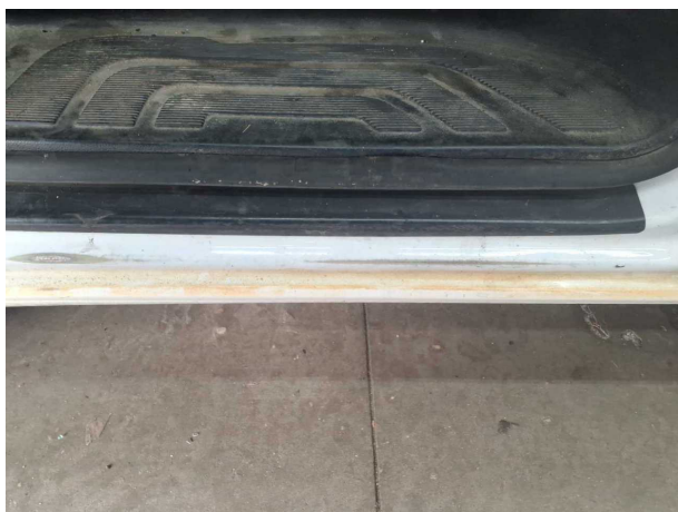
Beschädigung #20: Schweller links: Einstieg - verkratzt / verschürft - lackieren
