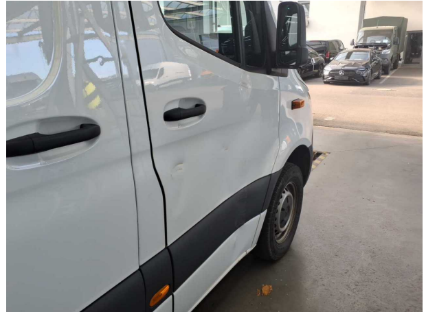
Beschädigung #23: Tür vorn rechts: Tür - verformt - erneuern
