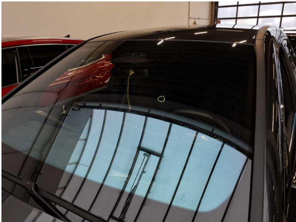
Beschädigung #1: Verglasung: Frontscheibe (Blendwirkung) - Steinschlag - erneuern
