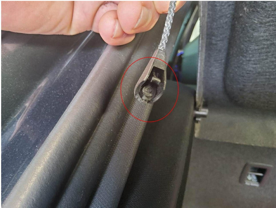
Bild 15 : Halteseil Gepäckraumabdeckung, abgerissen
