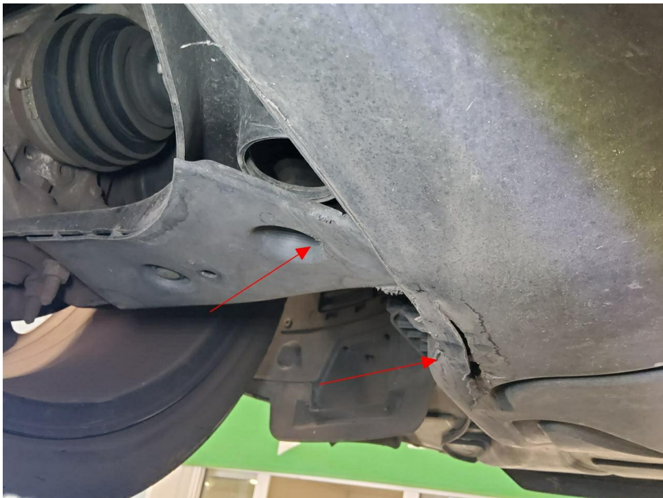
Bild 16 : Unterfahrschutz vorne, Abdeckung Querlenker vorne links, verschrammt, gebrochen
