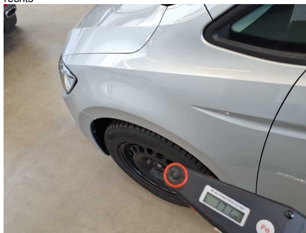
Nachlackierung 1: Kotflügel links, Tür vorne links, Tür vorne rechts
