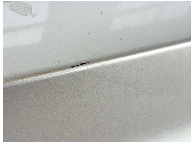
Beschädigung #2: Stossfänger hinten: Stossfänger hinten - Kratzer - instandsetzen und lackieren
