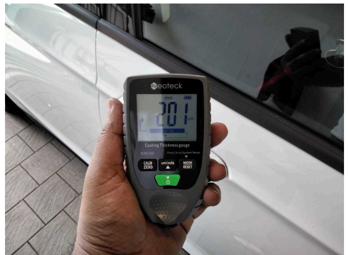
Door - front right side: 201 \mu\text{m}
