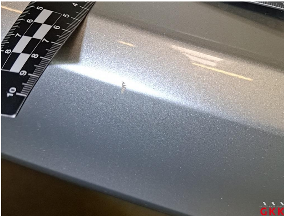
Bild 22 Stoßfänger hinten, Verkleidung -lackiert-, verkratzt, lackieren
