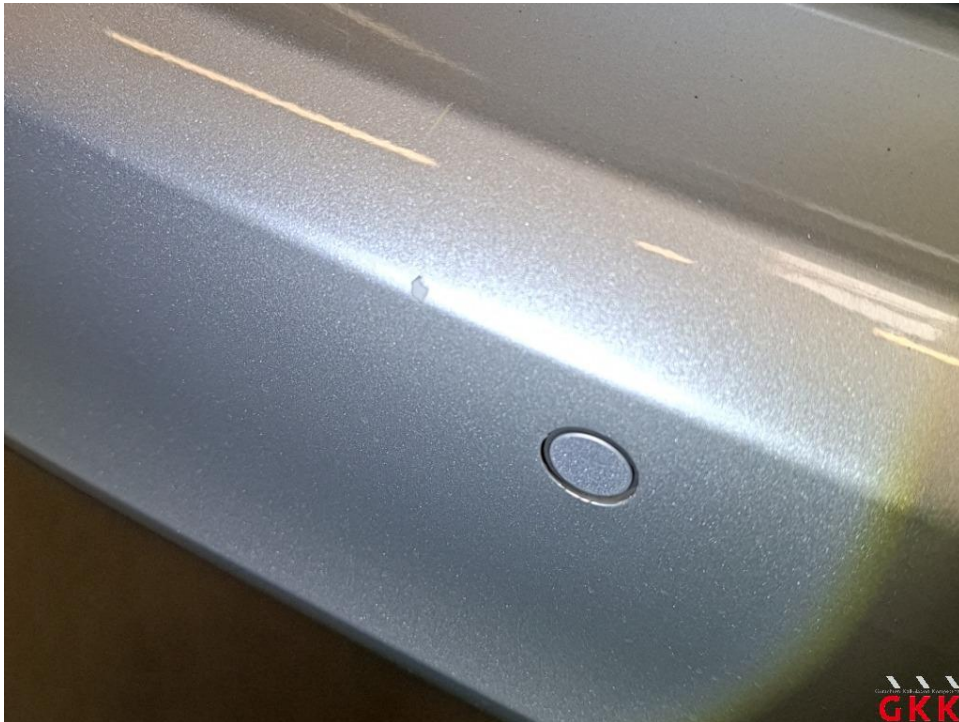
Bild 23 Stoßfänger hinten, Verkleidung -lackiert-, verkratzt, lackieren
