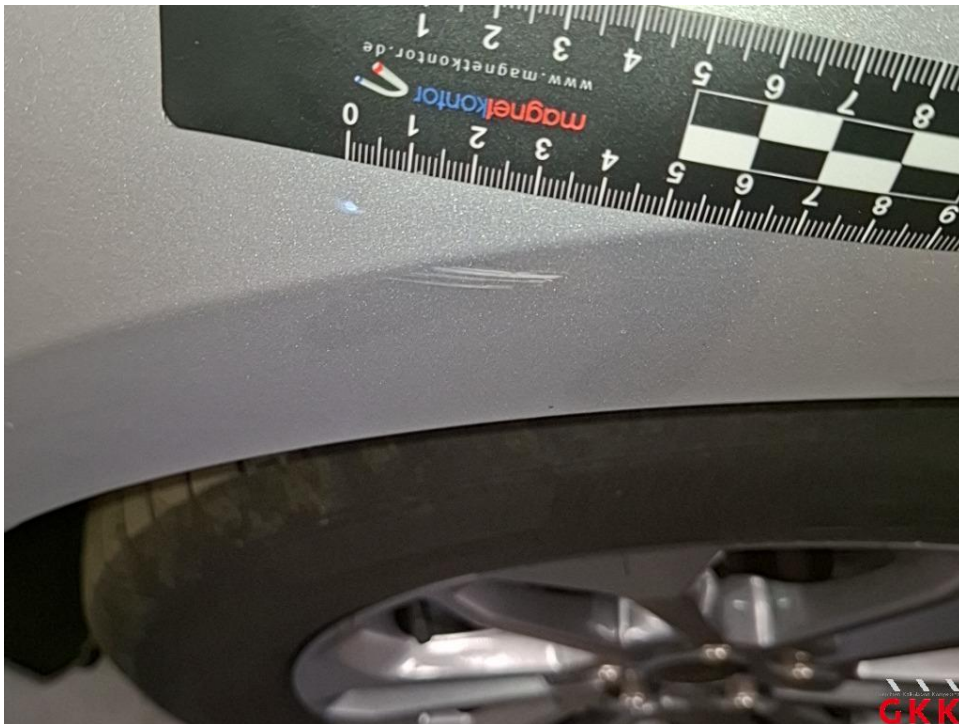
Bild 20 Kotflügel vorne links, verkratzt, lackieren
