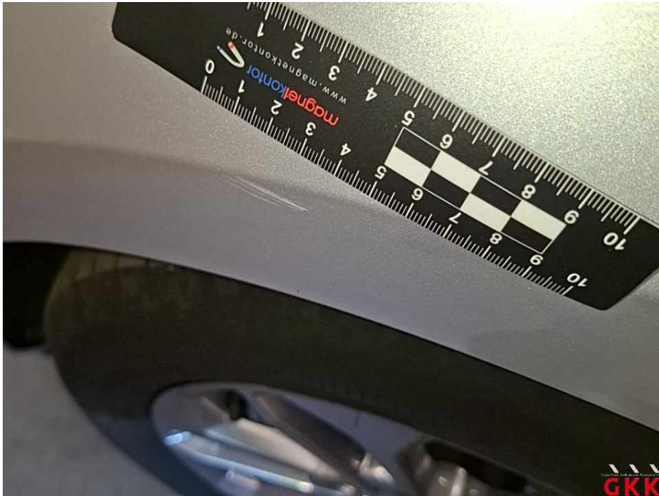
Bild 19 Kotflügel vorne links, verkratzt, lackieren
