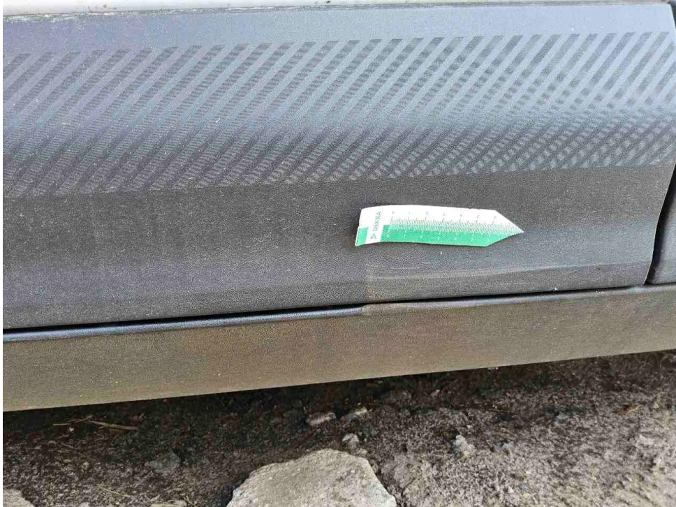
Bild 13 : Blende Tür vorne links und Seitenschwellerverkleidung links, zerkratzt/gekerbt
