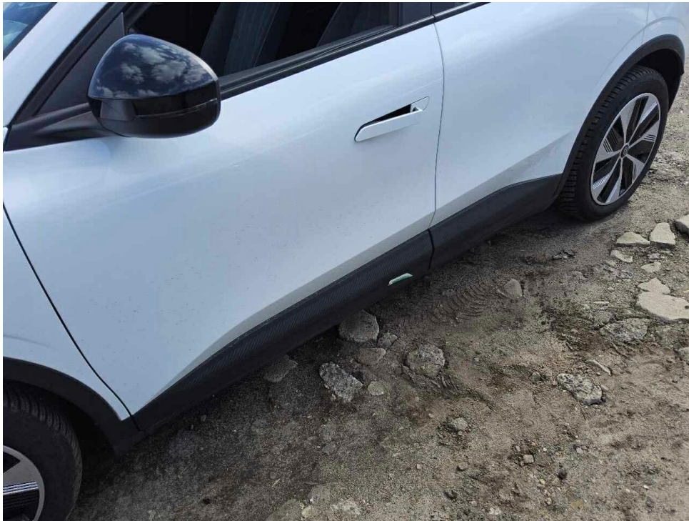
Bild 11 : Blende Tür vorne links und Seitenschwellerverkleidung links, zerkratzt/gekerbt
