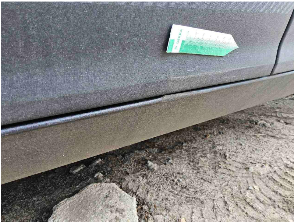
Bild 12 : Blende Tür vorne links und Seitenschwellerverkleidung links, zerkratzt/gekerbt
