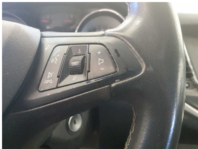
Damage 4: Steering system: Steering wheel (Knöpfe abgenutzt) - Paint defect - Loss in value
