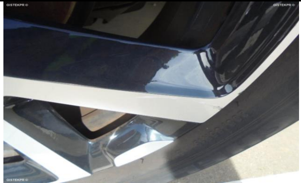
Foto daños externos 1
