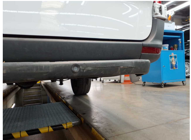
Beschädigung #26: Stossfänger hinten: Stossfänger Auftritt mit Parktronic (komplett) - beschädigt - erneuern
