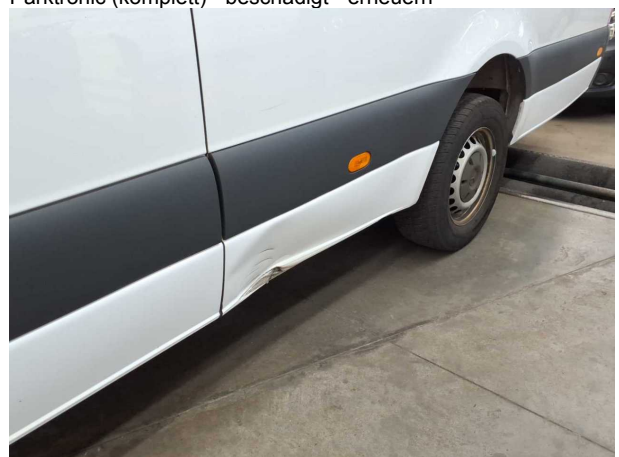
Beschädigung #27: Seitenwand links: Seitenwand (Beplankung unten mitte) - verformt - erneuern
