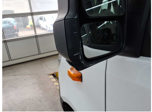
Beschädigung #1: Außenspiegel links: Rahmen - verkratzt / verschürft - erneuern
