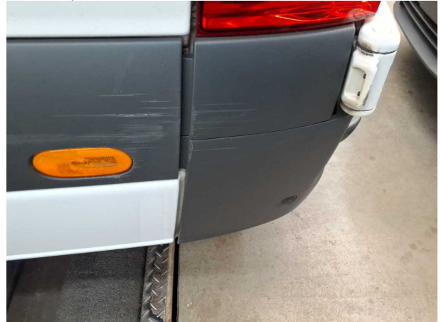
Beschädigung #7: Stossfänger hinten: Stossfänger hinten links - verkratzt / verschürft - Smart Repair
