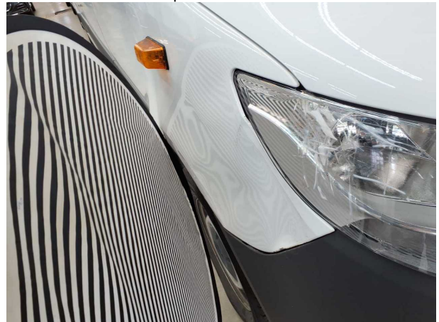
Beschädigung #17: Kotflügel rechts: Kotflügel rechts - verformt - erneuern
