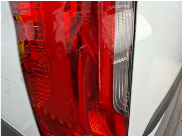
Beschädigung #10: Heckleuchte: Heckleuchte links - verkratzt / verschürft - erneuern
