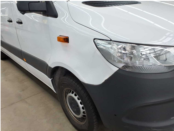
Beschädigung #17: Kotflügel rechts: Kotflügel rechts - verformt - erneuern
