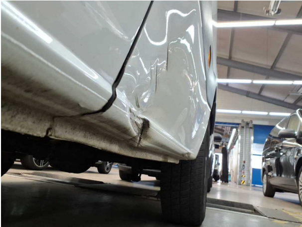
Beschädigung #27: Seitenwand links: Seitenwand (Bepankung unten mitte) - verformt - erneuern
