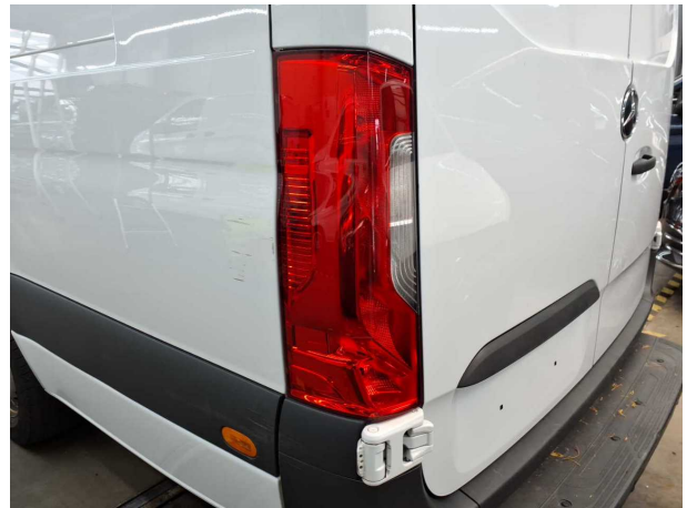
Beschädigung #10: Heckleuchte: Heckleuchte links - verkratzt / verschürft - erneuern
