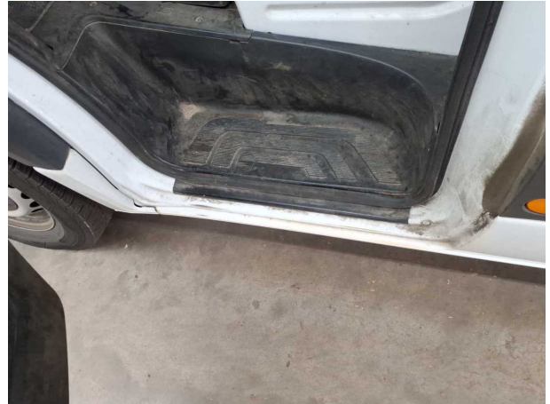
Beschädigung #13: Schweller links: Einstieg - verkratzt / versch... - lackieren
