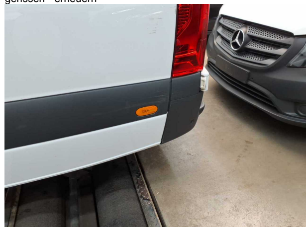
Beschädigung #12: Seitenwand links: Schutzleiste (inkl. Leuchte... verkratzt / verschürft - erneuern
