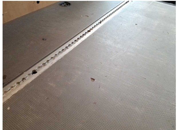
Beschädigung #20: Interieur: Laderaumboden - beschädigt - instandsetzen
