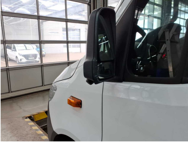
Beschädigung #1: Außenspiegel links: Rahmen - verkratzt / verschürft - erneuern
