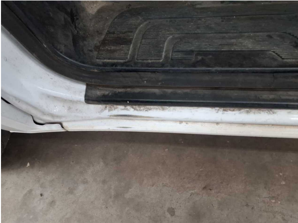
Beschädigung #13: Schweller links: Einstieg - verkratzt / verschürft - lackieren
