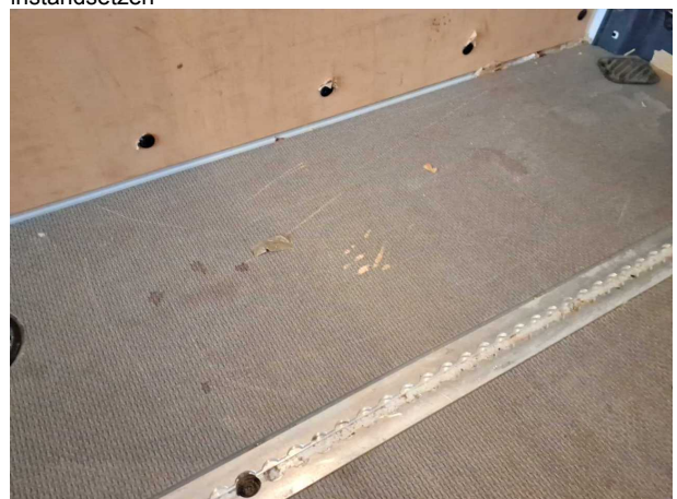
Beschädigung #20: Interieur: Laderaumboden - beschädigt - instandsetzen
