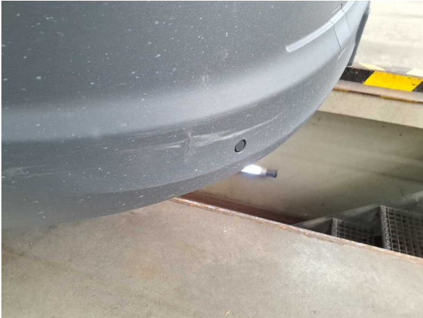
Beschädigung #23: Stossfänger vorn: Stossfänger vorn - verformt - erneuern
