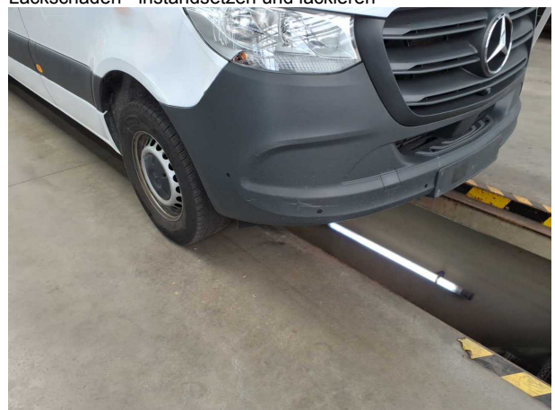
Beschädigung #23: Stossfänger vorn: Stossfänger vorn - verformt - erneuern
