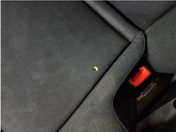
Beschädigung #6: Sitz vorn: Sitzbezug rechts (2er) - Brandloch - Smart Repair
