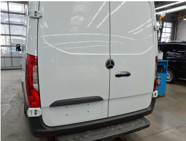
Beschädigung #9: Heckklappe/-tür: Schriftzug (und links) - fehlt - erneuern
