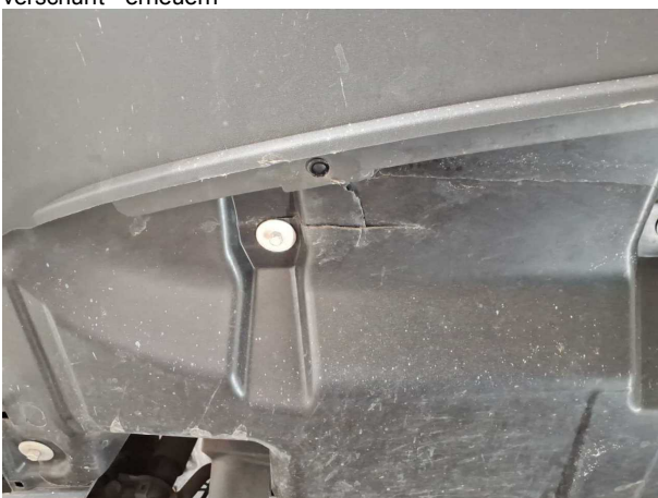
Beschädigung #11: Motor: Motorverkleidung unten - gebrochen / gerissen - erneuern
