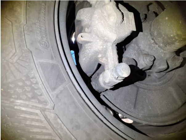
Beschädigung #21: Bremsanlage: Bremsscheiben und Beläge hinten... verschlissen - erneuern
