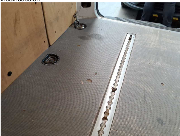
Beschädigung #20: Interieur: Laderaumboden - beschädigt - instandsetzen
