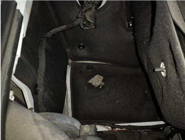
Beschädigung #5: Kotflügel rechts: Innenkotflügel - Marderschaden - erneuern
