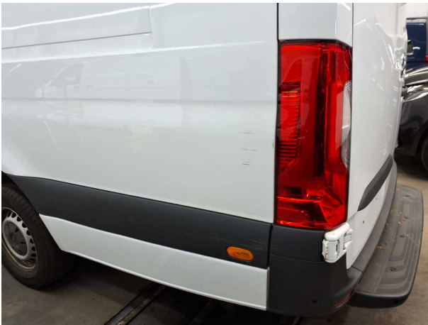
Beschädigung #25: Seitenwand links: Seitenwand - Delle / Lackschaden - instandsetzen und lackieren
