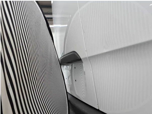
Beschädigung #22: Heckklappe/-tür: Hecktür links - Delle / Lackschaden - instandsetzen und lackieren
