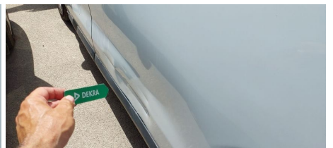
Panel lateral / Izquierda / Abolladura
