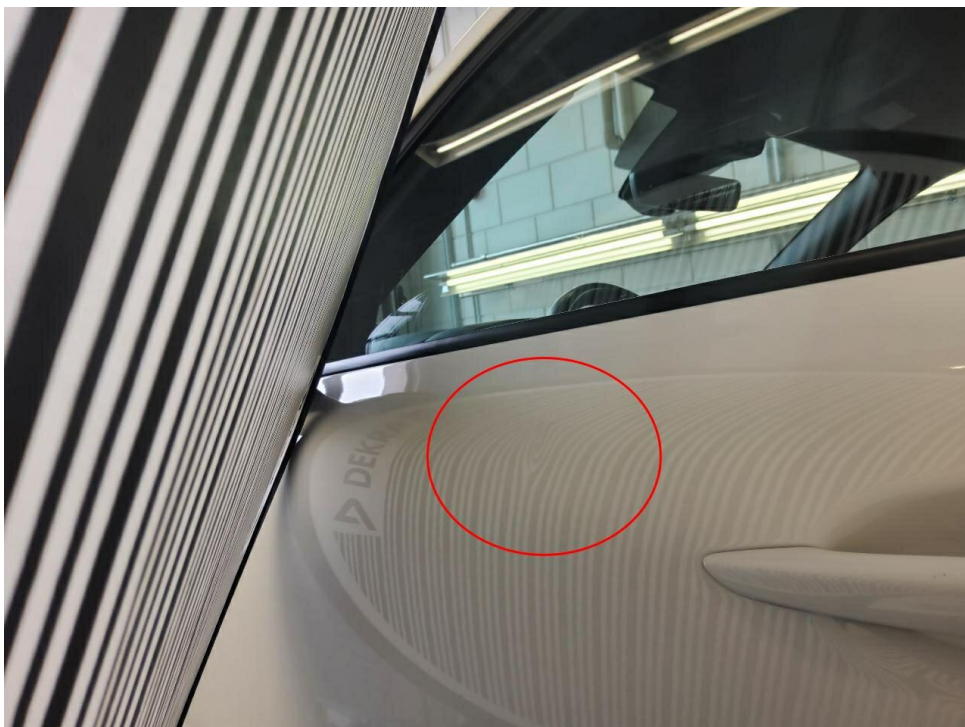
Bild 18 : Tür vorne links verformt
