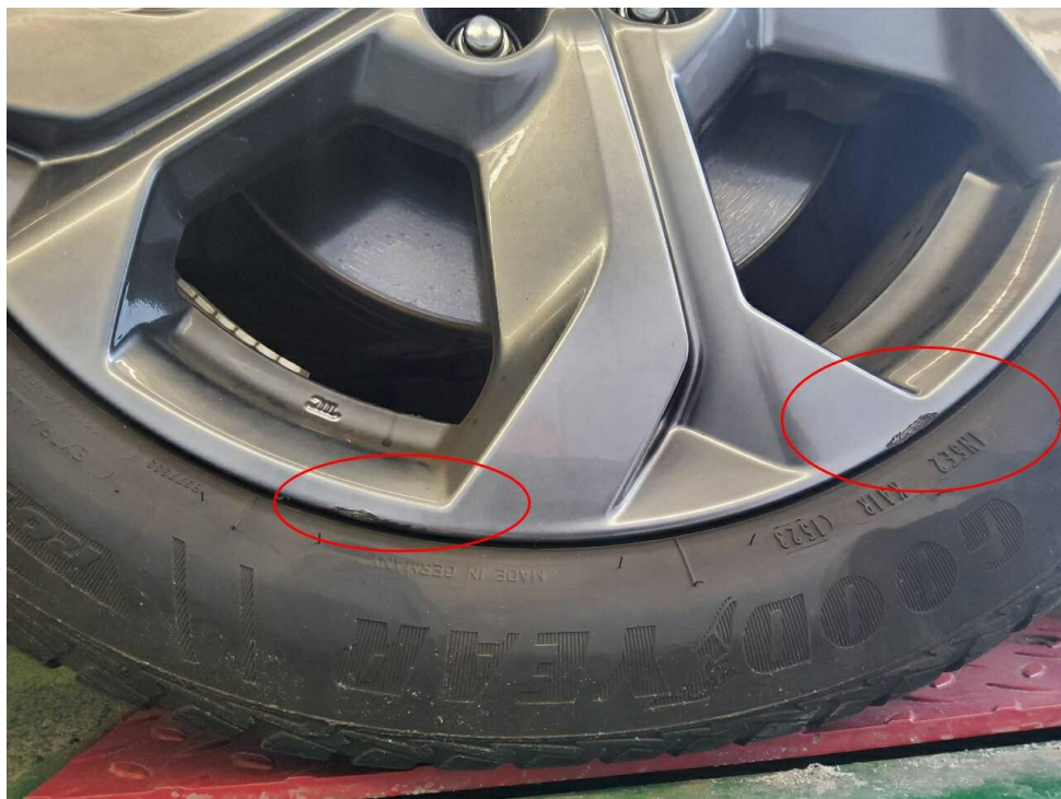
Bild 20 : Felge vorne rechts verschrammt
