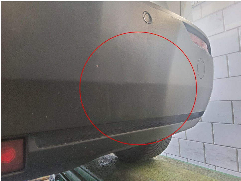
Bild 16 : Stoßfänger hinten Kratzer
