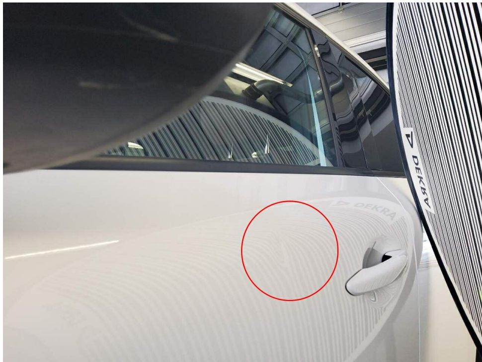
Bild 19 : Tür vorne links verformt
