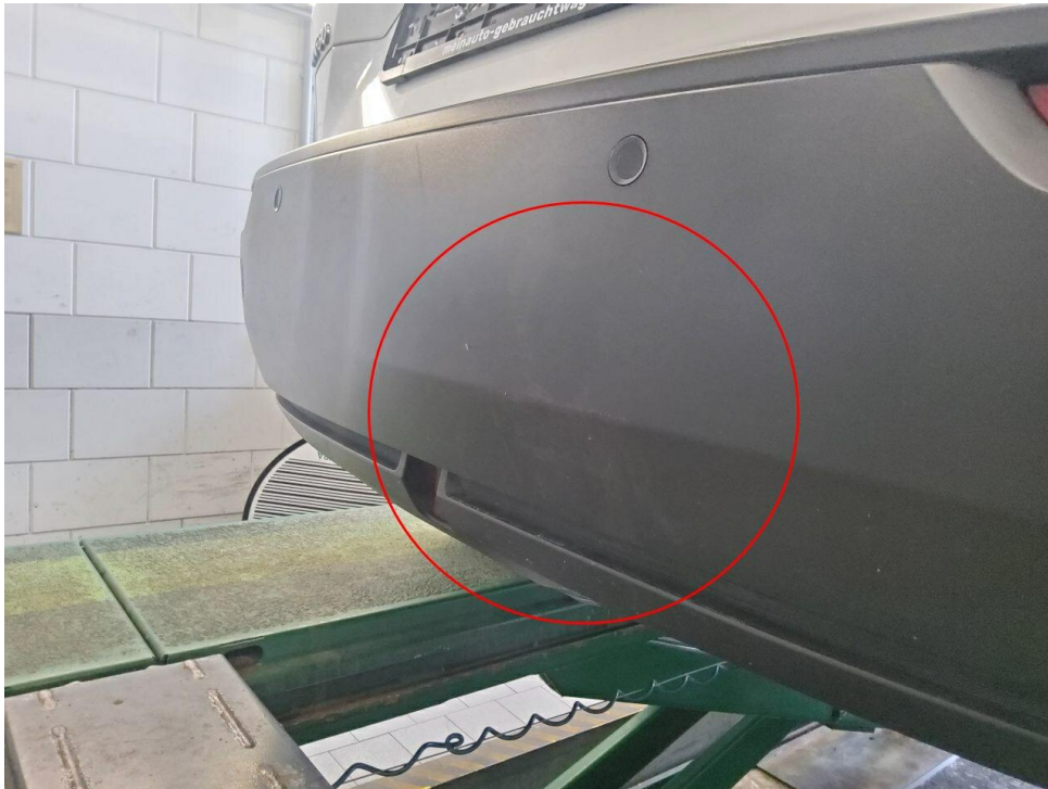
Bild 17 : Stoßfänger hinten Kratzer
