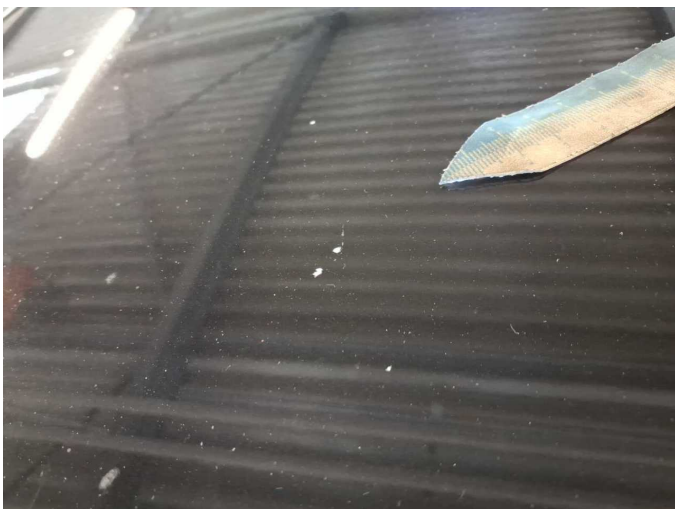
Damage 11: Bonnet: Bonnet (Sandstrahleffekt) - Stone chips - Paint
