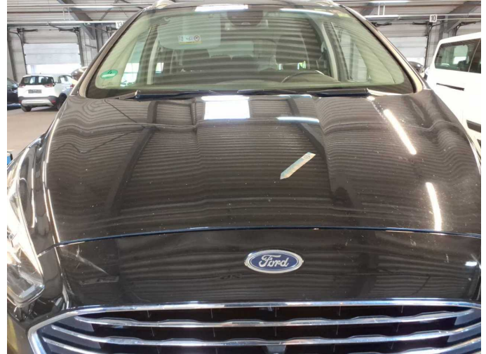
Damage 11: Bonnet: Bonnet (Sandstrahleffekt) - Stone chips - Paint
