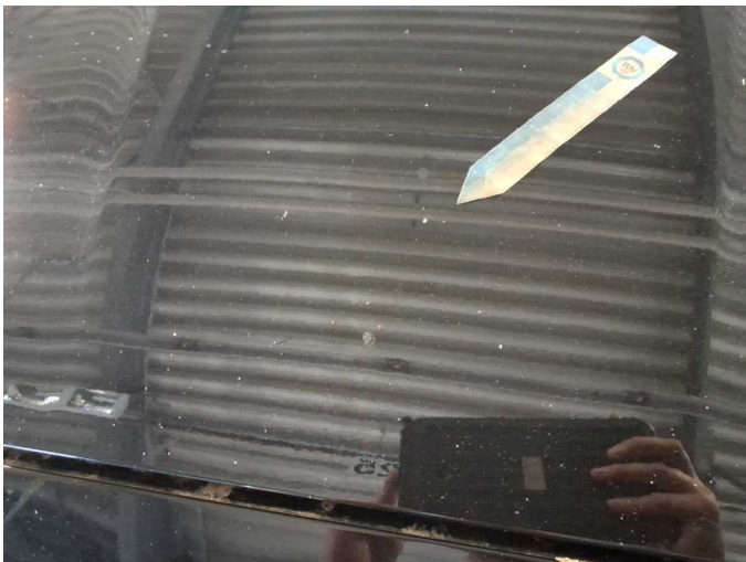
Damage 11: Bonnet: Bonnet (Sandstrahleffekt) - Stone chips - Paint
