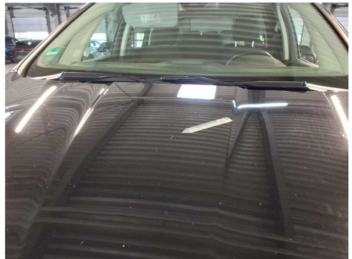
Damage 11: Bonnet: Bonnet (Sandstrahleffekt) - Stone chips - Paint
