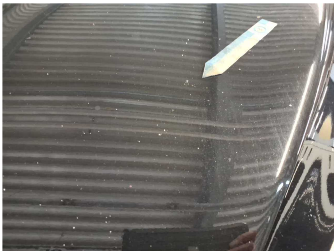
Damage 11: Bonnet: Bonnet (Sandstrahleffekt) - Stone chips - Paint
