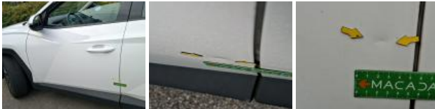
Door trim FL, Scratch(es), Replace
