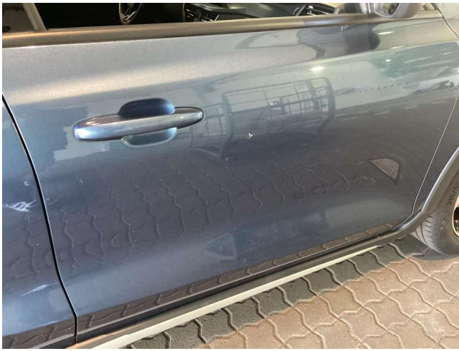
Tür vorne rechts - zerkratzt - Lackieren
