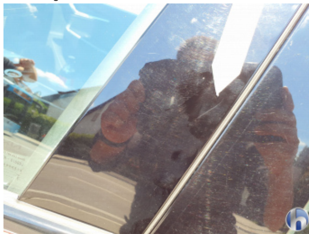
3. B-Säule Mitte - Links Beschädigt - Erneuern
