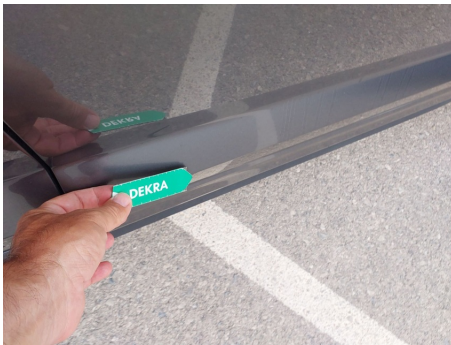
Puerta / Delantero Derecho / Abolladura
