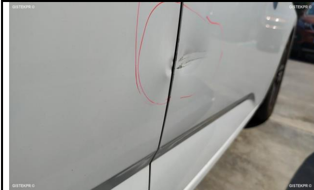
Foto daños externos 1
