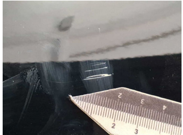
Beschädigung #6: Tür hinten rechts: Tür - Kratzer - lackieren
