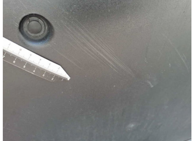
Beschädigung #3: Stossfänger vorn: Spoiler - verkratzt / verschürft - erneuern
