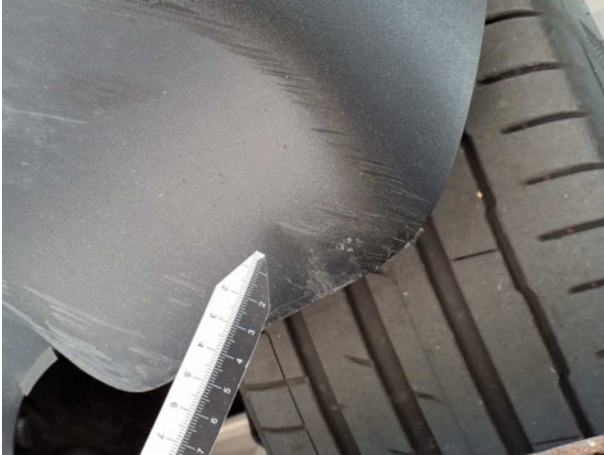
Beschädigung #3: Stossfänger vorn: Spoiler - verkratzt / verschürft - erneuern
