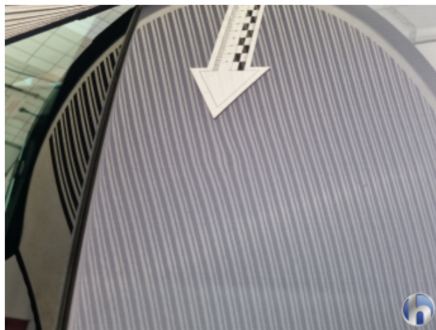
5. Dach 3 Dellen - Sanft Instandsetzen
