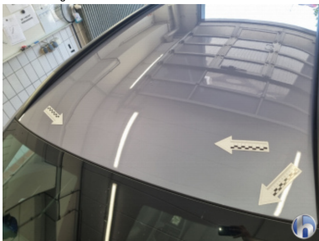
5. Dach 3 Dellen - Sanft Instandsetzen
