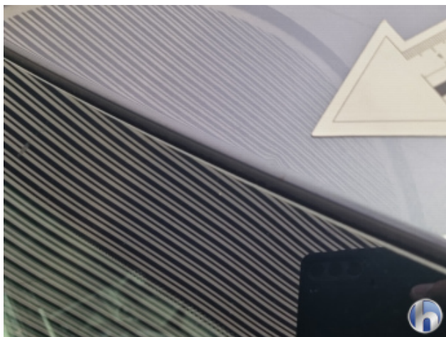
5. Dach 3 Dellen - Sanft Instandsetzen
