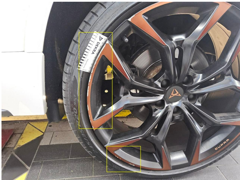
Bild 18 : Felge (Sommer) hinten links, zerkratzt
