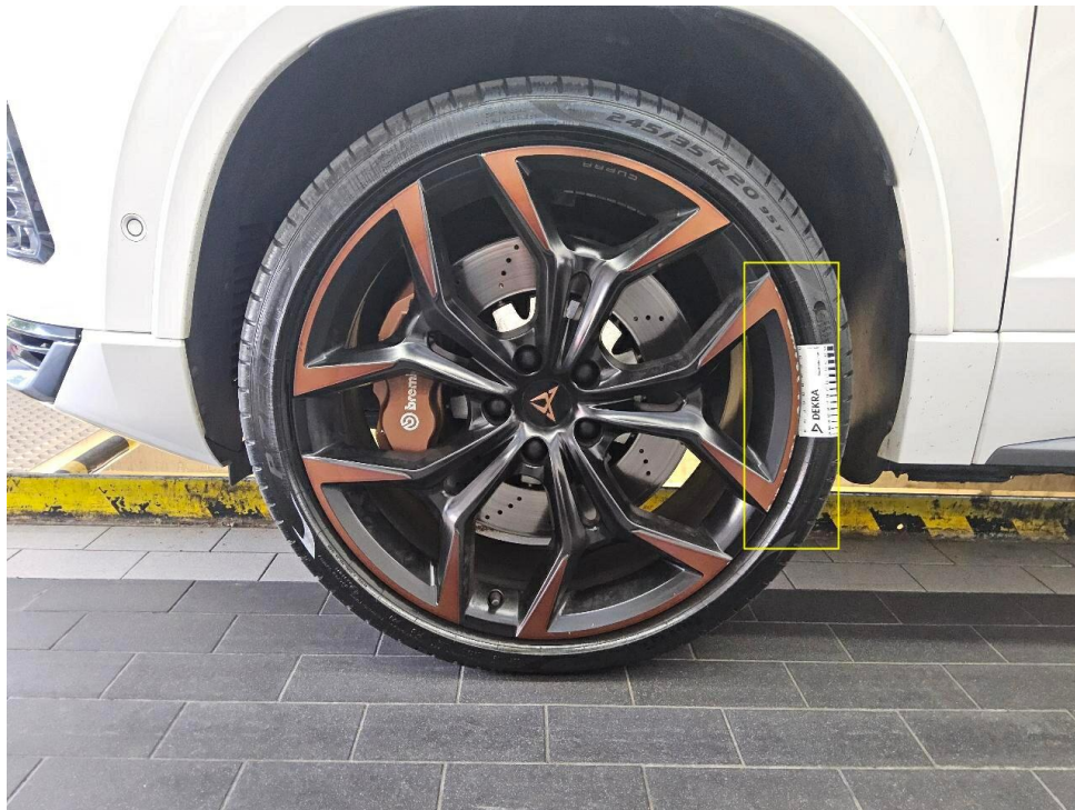
Bild 15 : Felge (Sommer) vorne links, zerkratzt
