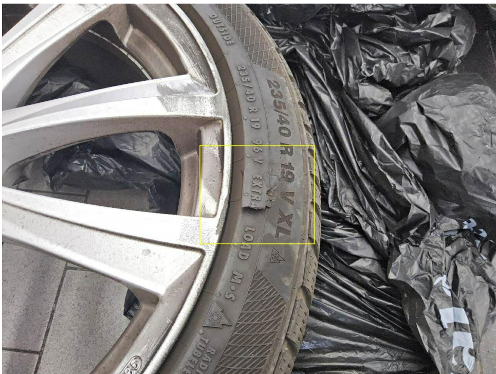
Bild 28 : Winterreifen vorne rechts, beschädigt
