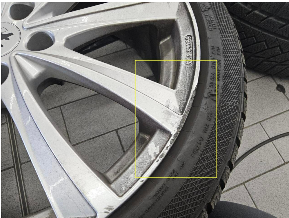
Bild 26 : Felge (Winter) hinten rechts, zerkratzt
