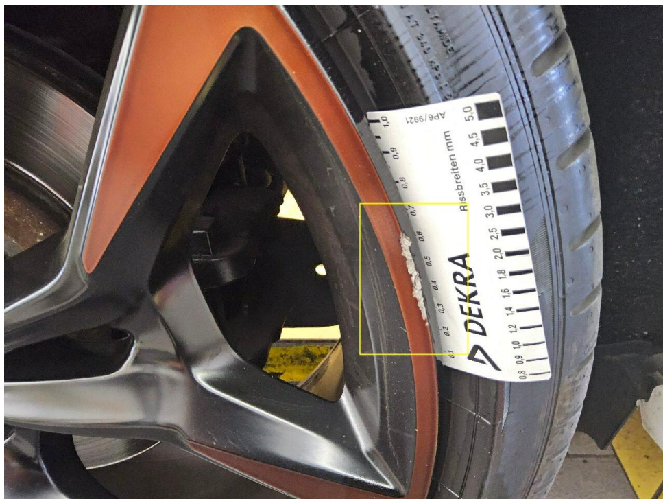
Bild 20 : Felge (Sommer) hinten rechts, zerkratzt
