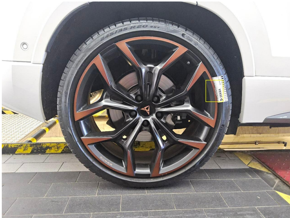
Bild 19 : Felge (Sommer) hinten rechts, zerkratzt
