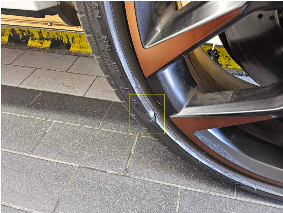
Bild 27 : Sommerreifen vorne rechts, eingerissen
