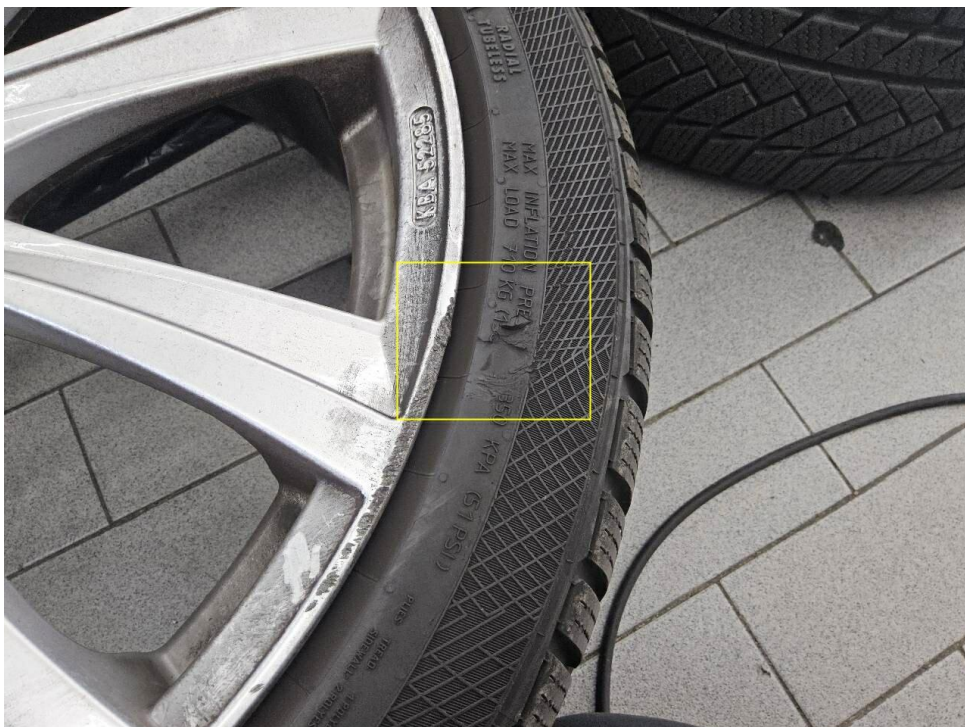
Bild 30 : Winterreifen hinten rechts, beschädigt
