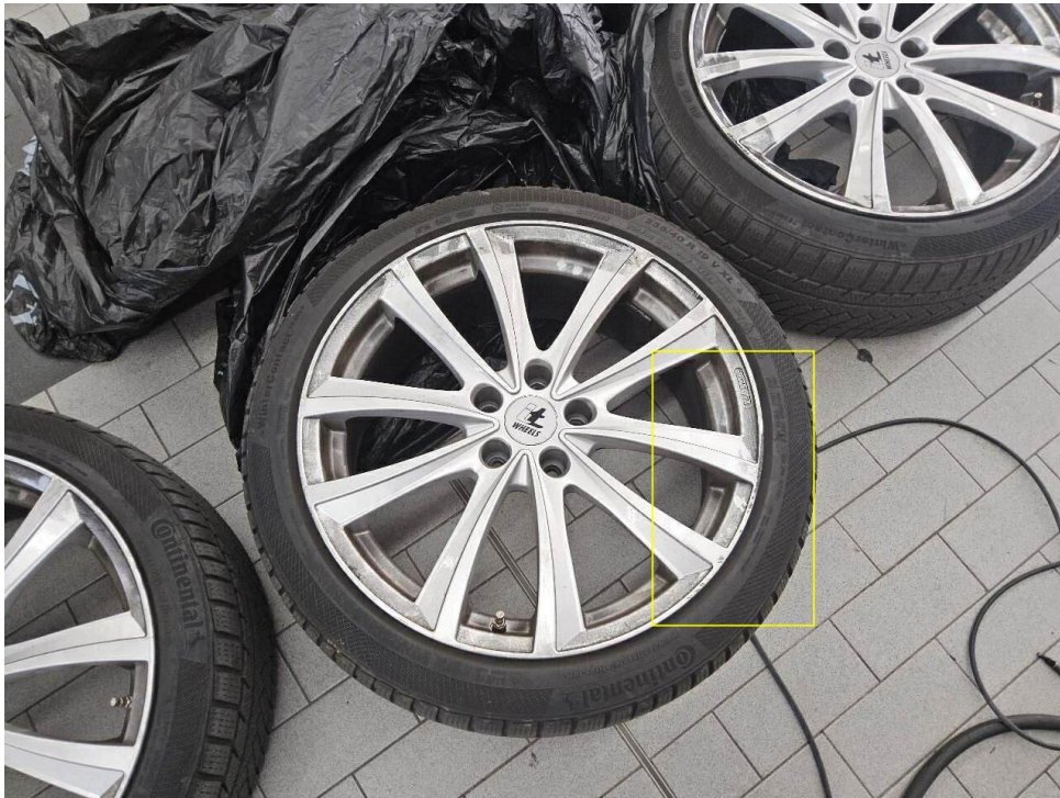
Bild 25 : Felge (Winter) hinten rechts, zerkratzt
