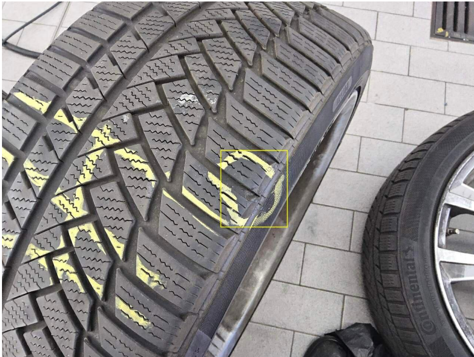
Bild 29 : Winterreifen hinten links, Fremdkörper im Reifen
