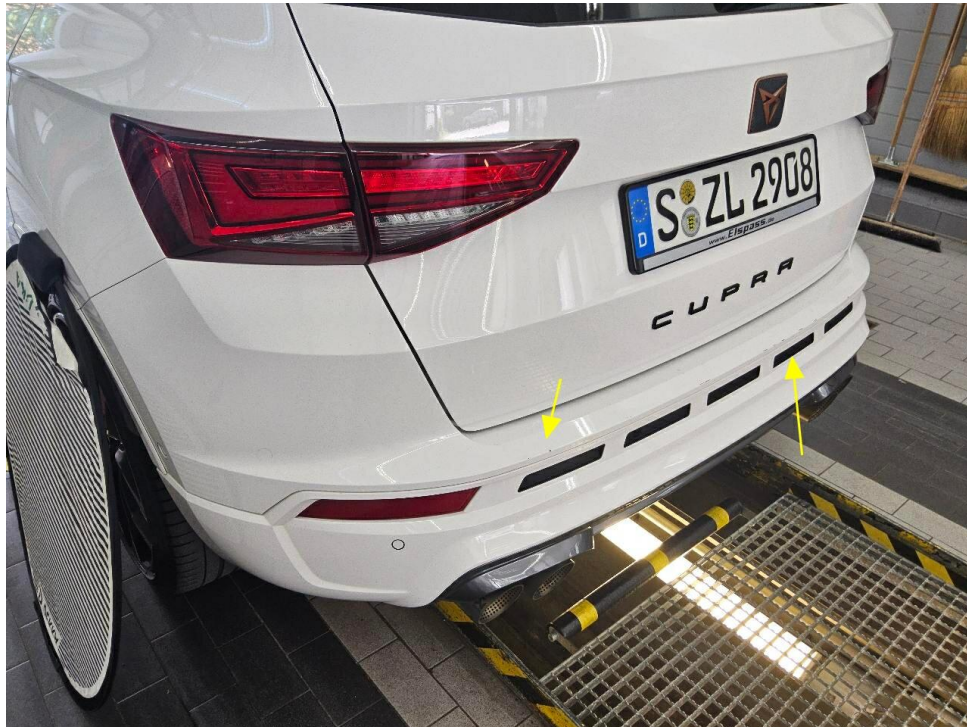
Bild 11 : Stoßfänger hinten Lackierung, zerkratzt, lackieren mit Lackaufbau
