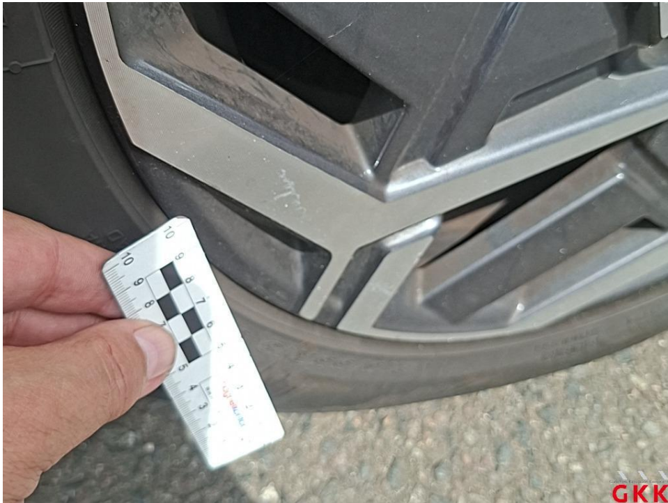
Bild 17. LM-Rad, vorne rechts, beschädigt, ersetzen
