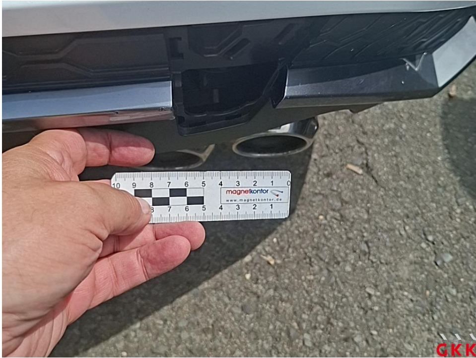
Bild 21. Stoßfänger hinten, Abdeckung Abschlepphaken, Steinschlag, ersetzen
