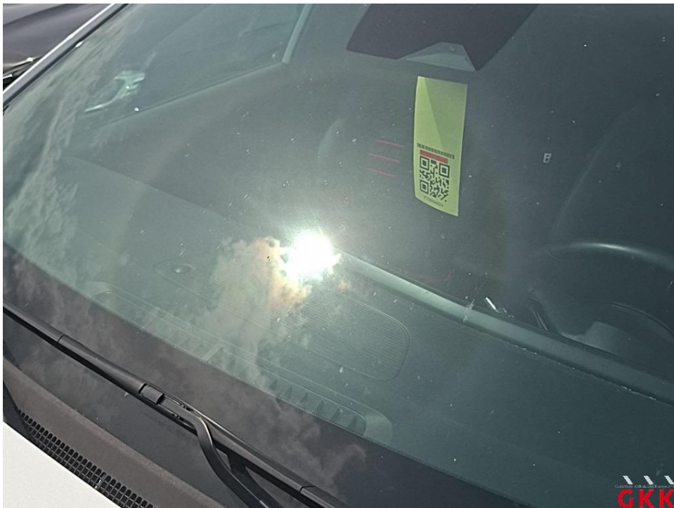
Bild 18. Frontscheibe, beheizt mit Regensensor und Frontkamera, Steinschlag, ersetzen
