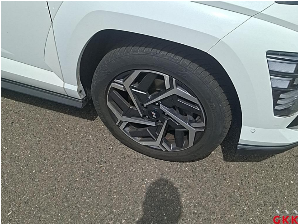
Bild 15. LM-Rad, vorne rechts, beschädigt, ersetzen
