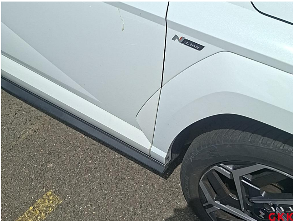
Bild 22. Tür vorne rechts, verkratzt, Smartrepair
