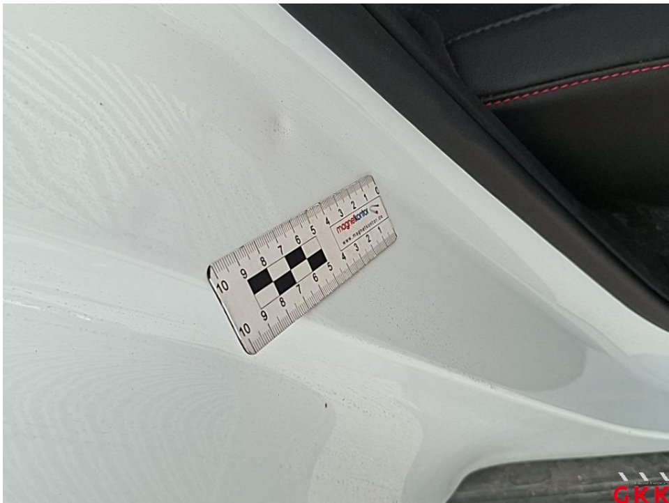
Bild 14. Tür hinten rechts, Einstieg, beschädigt, instand setzen - lackieren
