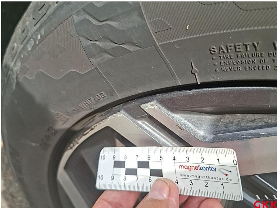
Bild 16. LM-Rad, vorne rechts, beschädigt, ersetzen
