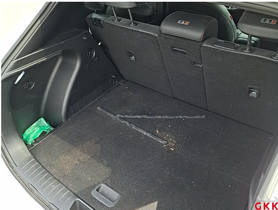
Bild 12. Laderaum, Abdeckung, fehlt, ersetzen
