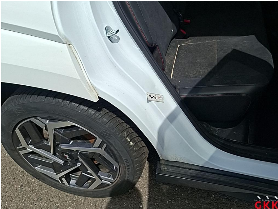
Bild 13. Tür hinten rechts, Einstieg, beschädigt, instand setzen - lackieren
