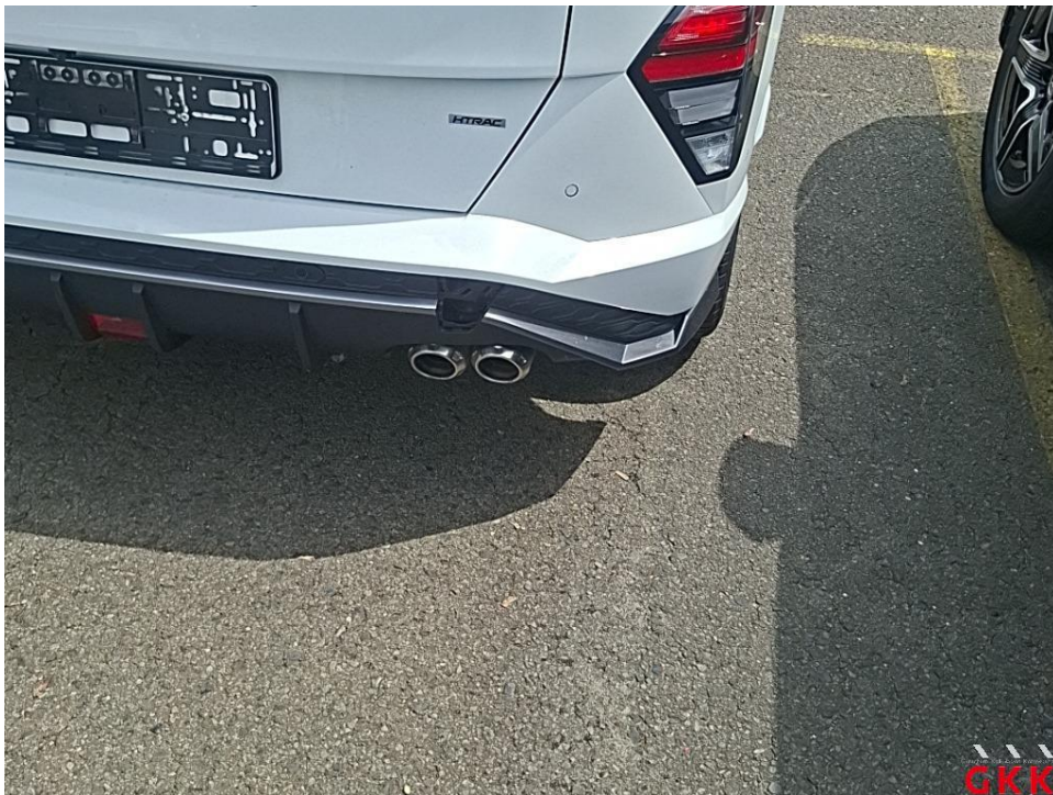
Bild 20. Stoßfänger hinten, Abdeckung Abschlepphaken, Steinschlag, ersetzen
