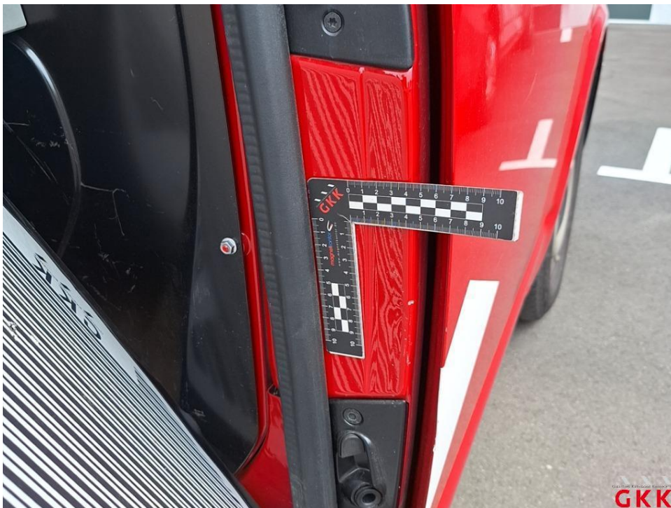
Bild 22. B- Säule rechts, beschädigt, instand setzen - lackieren
