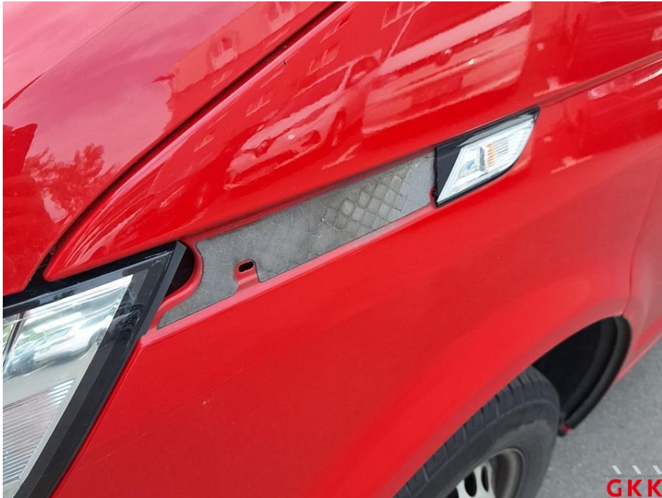
Bild 15. Kotflügel vorne links, Schriftzug -Motorvariante/Ausführung-, fehlt, ersetzen
