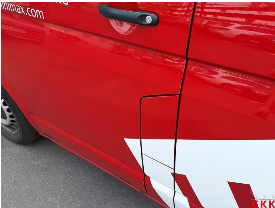
Bild 28. Tür vorne links, Kante, verkratzt, auslegen, schleifen, polieren
