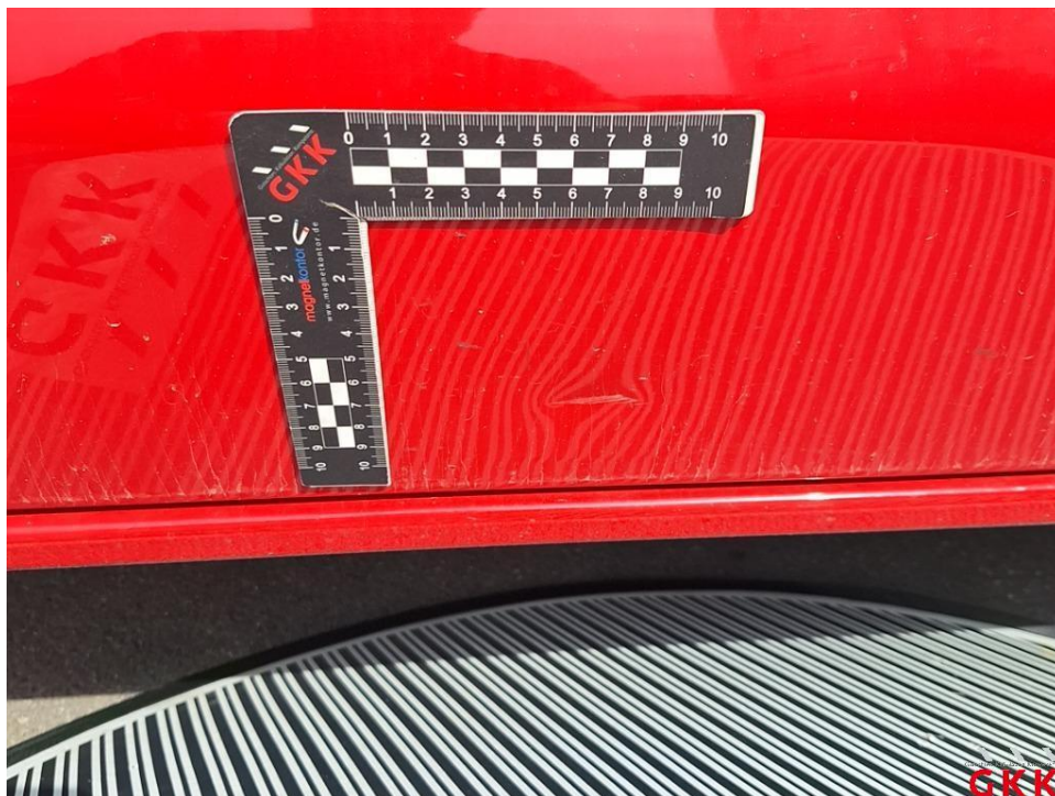
Bild 19. Tür vorne rechts, beschädigt, instand setzen - lackieren
