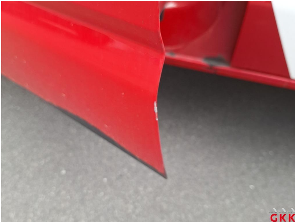
Bild 30. Tür vorne links, Kante, verkratzt, auslegen, schleifen, polieren
