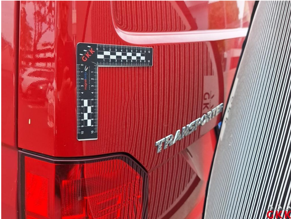
Bild 23. Heckklappe, 4 bis 10 Dellen / Bauteil, kalt drücken
