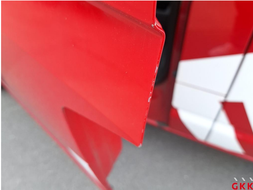
Bild 29. Tür vorne links, Kante, verkratzt, auslegen, schleifen, polieren
