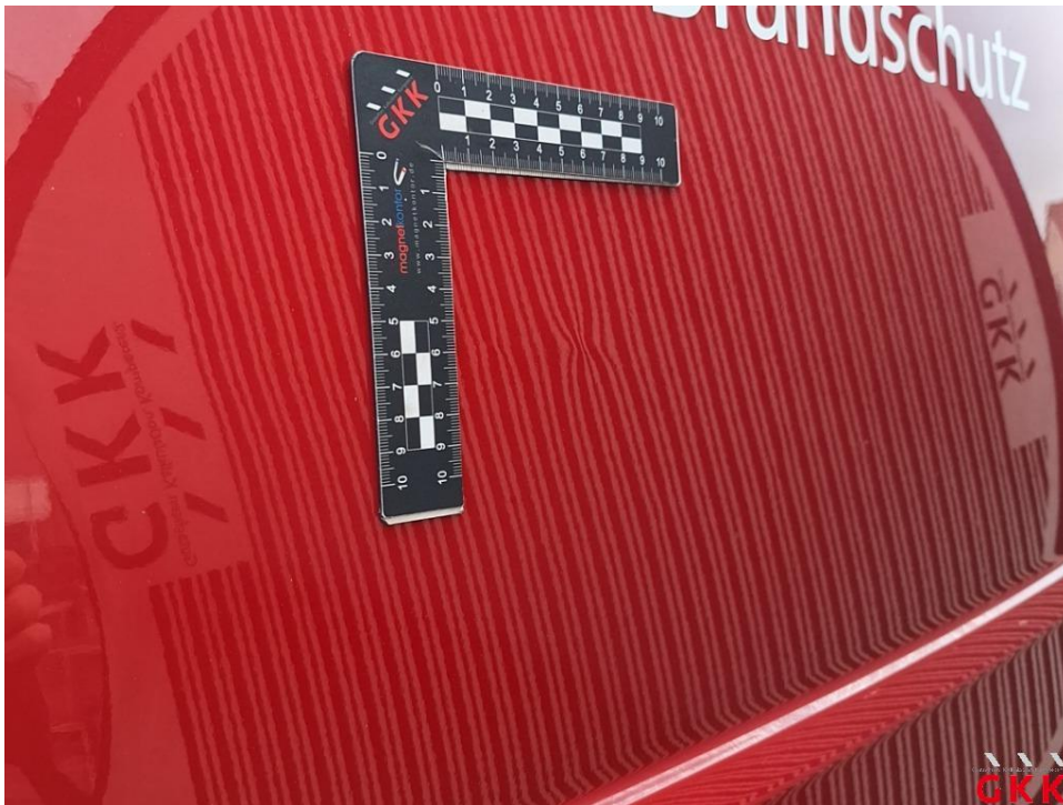
Bild 25. Heckklappe, 4 bis 10 Dellen / Bauteil, kalt drücken
