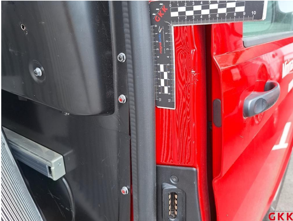
Bild 21. B- Säule rechts, beschädigt, instand setzen - lackieren
