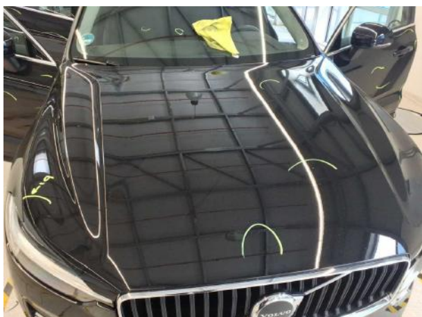
Beschädigung #19: Motorhaube: Motorhaube (Anätzung) - Kratzer - lackieren
