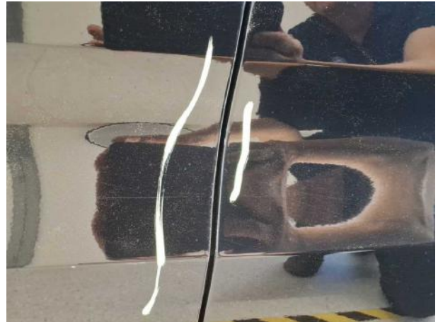
Beschädigung #15: Tür hinten links: Tür - Kratzer - lackieren
