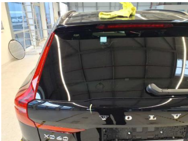
Beschädigung #7: Verglasung: Heckscheibe - verkratzt / verschürft - Wertminderung
