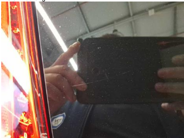
Beschädigung #7: Verglasung: Heckscheibe - verkratzt / verschürft - Wertminderung
