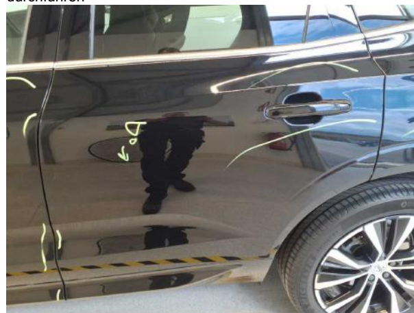
Beschädigung #15: Tür hinten links: Tür - Kratzer - lackieren
