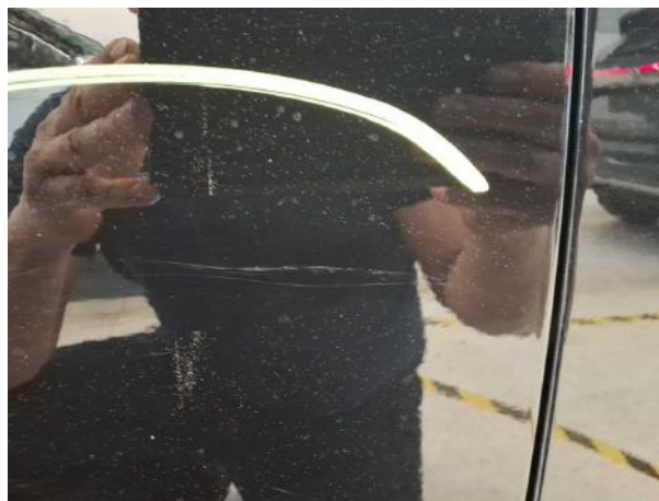
Beschädigung #17: Tür vorn rechts: Tür - Kratzer - lackieren
