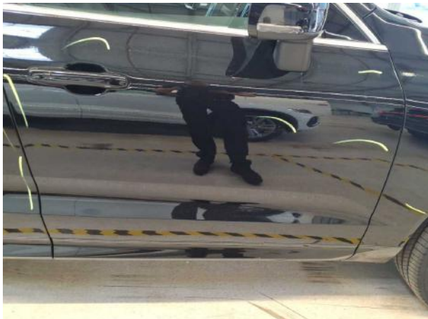
Beschädigung #17: Tür vorn rechts: Tür - Kratzer - lackieren
