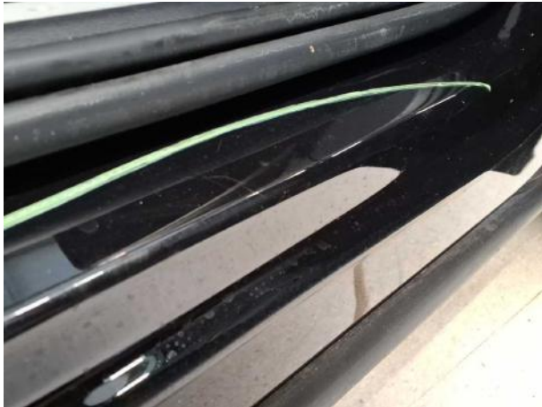
Beschädigung #4: Schweller rechts: Einstieg - Kratzer - Smart Repair
