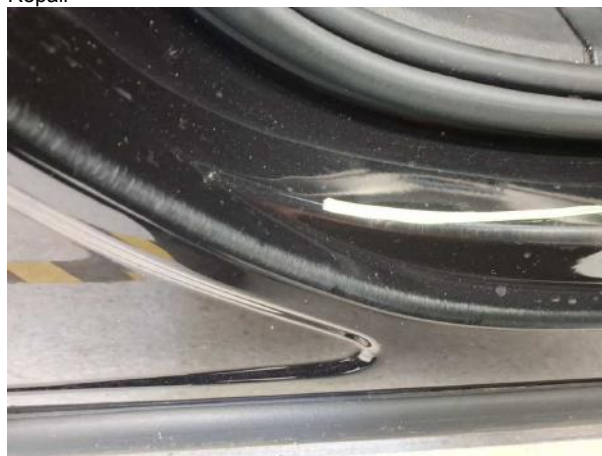
Beschädigung #4: Schweller rechts: Einstieg - Kratzer - Smart Repair
