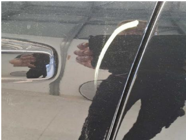
Beschädigung #16: Tür vorn links: Tür - Kratzer - lackieren
