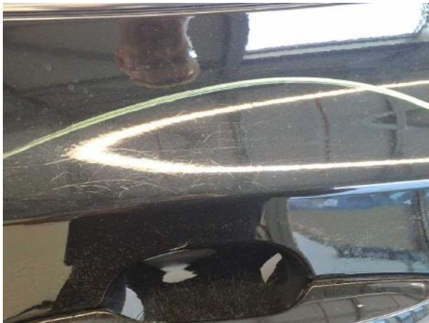
Beschädigung #15: Tür hinten links: Tür - Kratzer - lackieren
