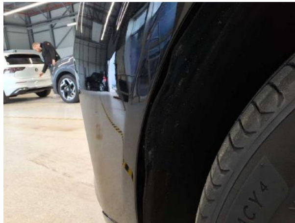
Beschädigung #1: Kotflügel links: Innenkotflügel - Fehlstellung - instandsetzen
