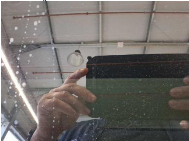
Beschädigung #7: Verglasung: Heckscheibe - verkratzt / verschürft - Wertminderung
