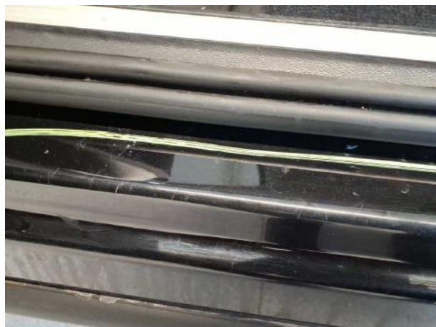
Beschädigung #3: Schweller links: Einstieg - Kratzer - Smart Repair
