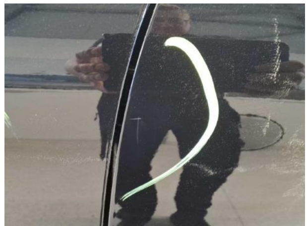
Beschädigung #16: Tür vorn links: Tür - Kratzer - lackieren
