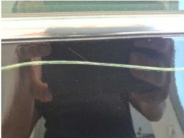
Beschädigung #16: Tür vorn links: Tür - Kratzer - lackieren
