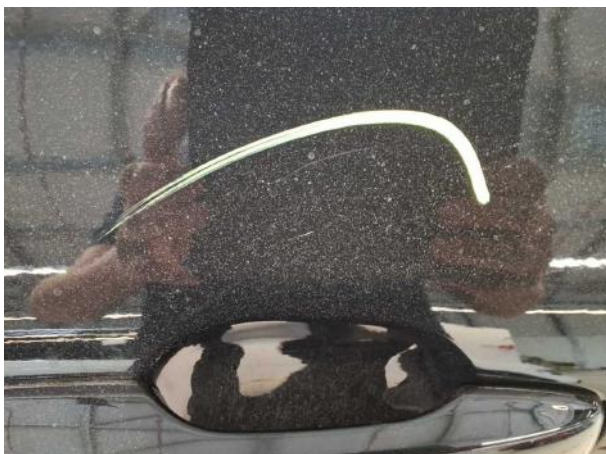
Beschädigung #17: Tür vorn rechts: Tür - Kratzer - lackieren
