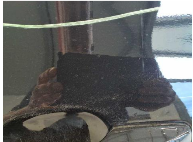
Beschädigung #16: Tür vorn links: Tür - Kratzer - lackieren
