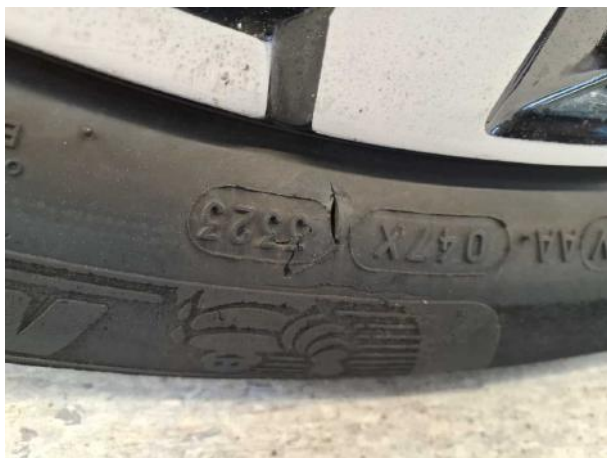
Beschädigung #9: Rad/Reifen: Reifen vorn rechts - beschädigt - erneuern
