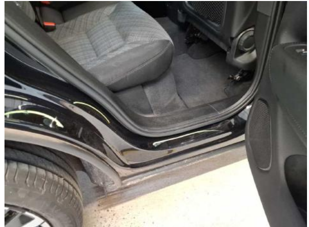
Beschädigung #5: Seitenwand rechts: Einstieg - Kratzer - Smart Repair
