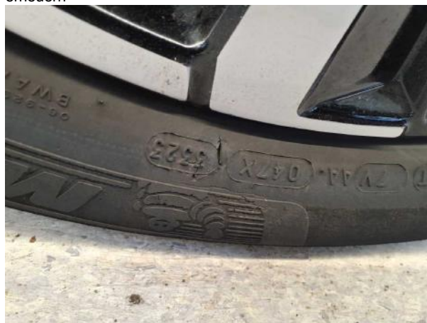
Beschädigung #9: Rad/Reifen: Reifen vorn rechts - beschädigt - erneuern
