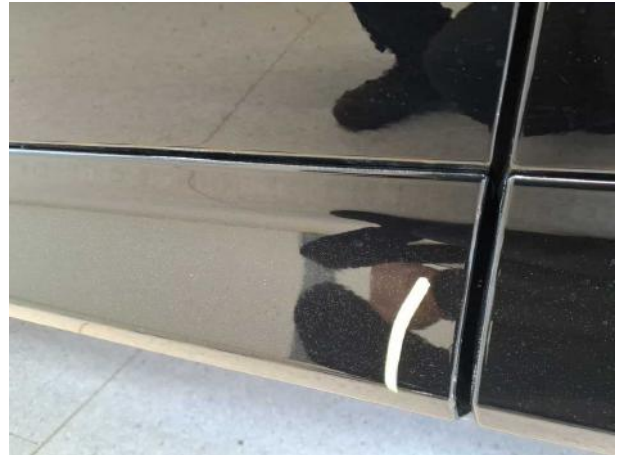
Beschädigung #16: Tür vorn links: Tür - Kratzer - lackieren
