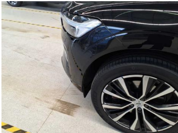
Beschädigung #1: Kotflügel links: Innenkotflügel - Fehlstellung - instandsetzen
