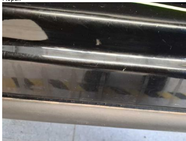
Beschädigung #3: Schweller links: Einstieg - Kratzer - Smart Repair
