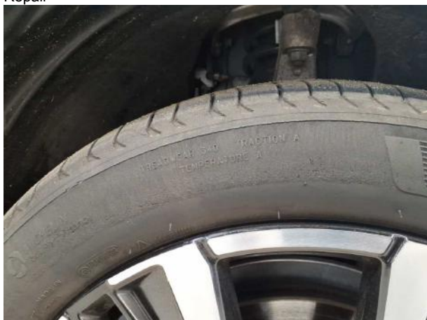
Beschädigung #9: Rad/Reifen: Reifen vorn rechts - beschädigt - erneuern
