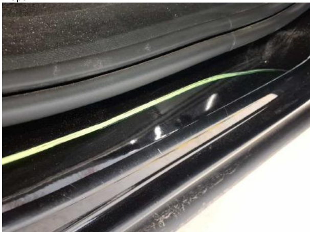
Beschädigung #5: Seitenwand rechts: Einstieg - Kratzer - Smart Repair
