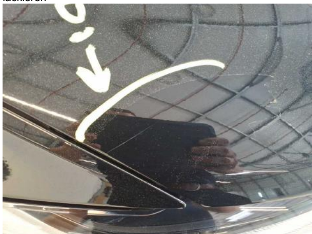
Beschädigung #19: Motorhaube: Motorhaube (Anätzung) - Kratzer - lackieren
