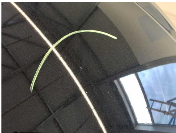
Beschädigung #19: Motorhaube: Motorhaube (Anätzung) - Kratzer - lackieren
