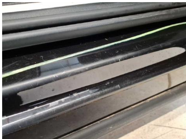
Beschädigung #4: Schweller rechts: Einstieg - Kratzer - Smart Repair
