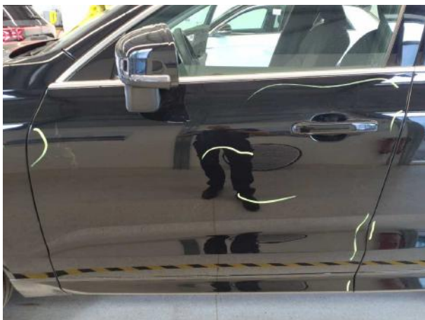
Beschädigung #16: Tür vorn links: Tür - Kratzer - lackieren
