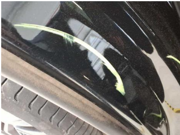
Beschädigung #5: Seitenwand rechts: Einstieg - Kratzer - Smart Repair
