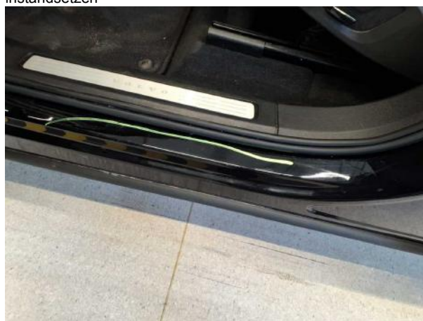
Beschädigung #3: Schweller links: Einstieg - Kratzer - Smart Repair
