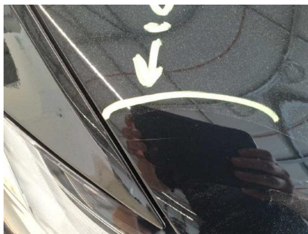
Beschädigung #19: Motorhaube: Motorhaube (Anätzung) - Kratz... - lackieren
