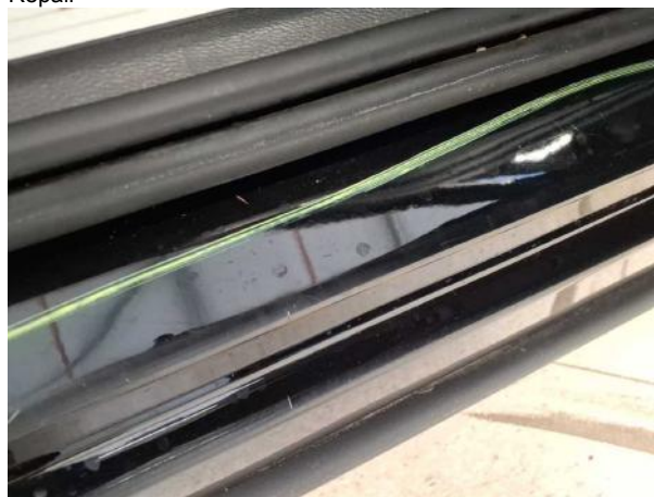
Beschädigung #4: Schweller rechts: Einstieg - Kratzer - Smart Repair
