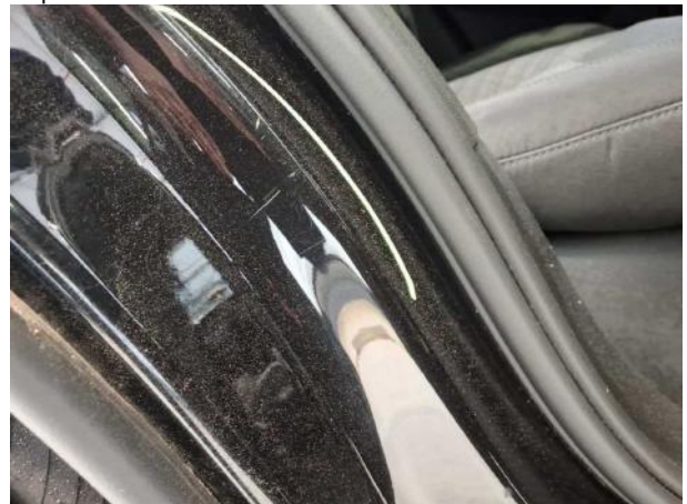
Beschädigung #5: Seitenwand rechts: Einstieg - Kratzer - Smart Repair
