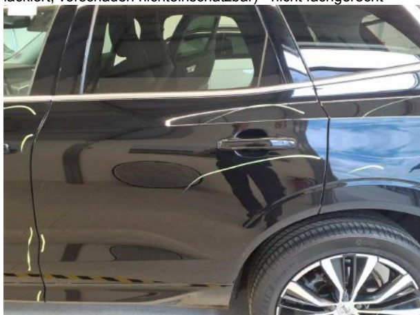
Beschädigung #15: Tür hinten links: Tür - Kratzer - lackieren
