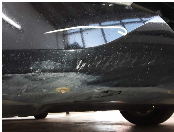
Beschädigung #1: Stossfänger vorn: Stossfänger vorn - verkratzt / verschürft - Wertminderung
