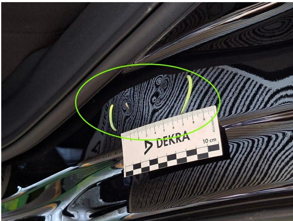
Bild 20 : Türeinstieg hinten links mittig eingedellt und verschrammt
