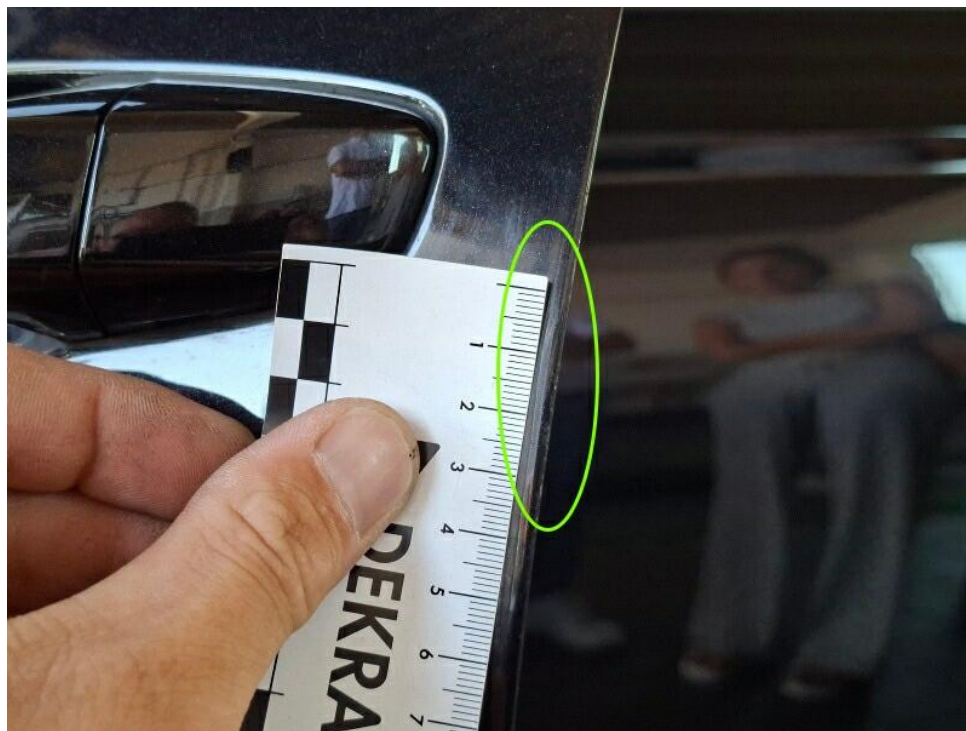
Bild 18 : Türkante Tür vorne links verschrammt
