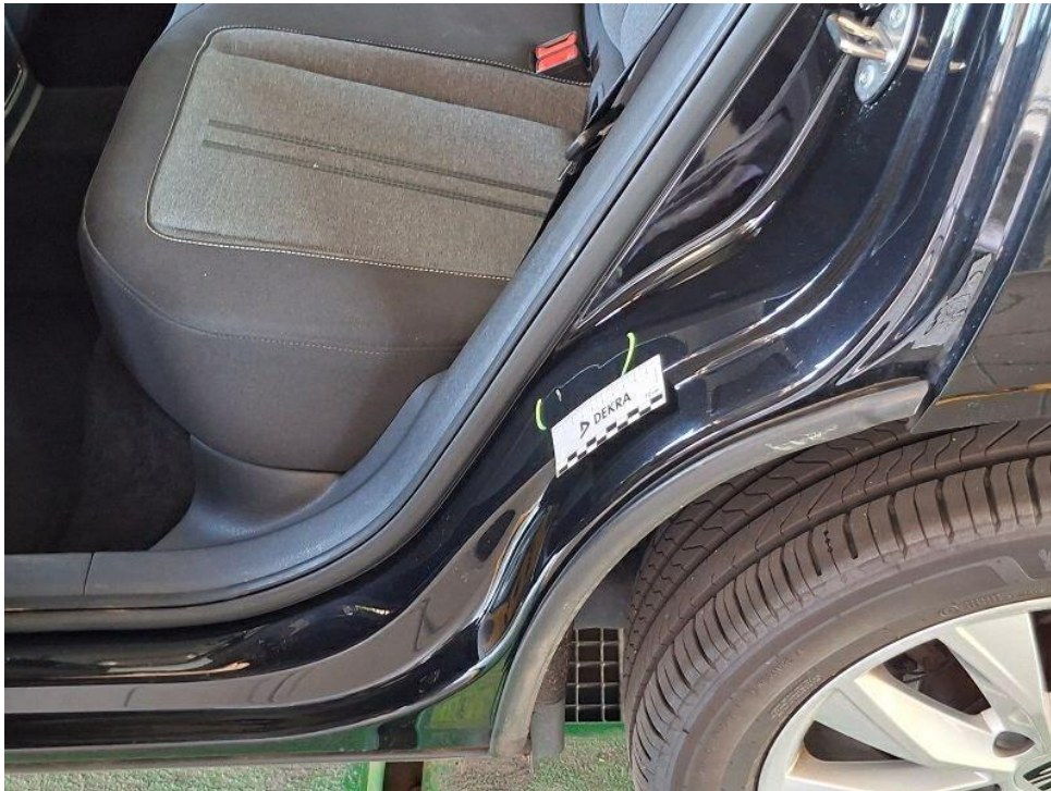
Bild 19 : Türeinstieg hinten links mittig eingedellt und verschrammt
