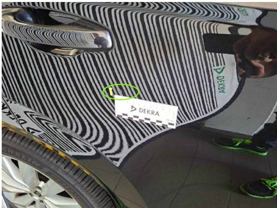
Bild 24 : Tür hinten rechts mittig punktuell eingedellt
