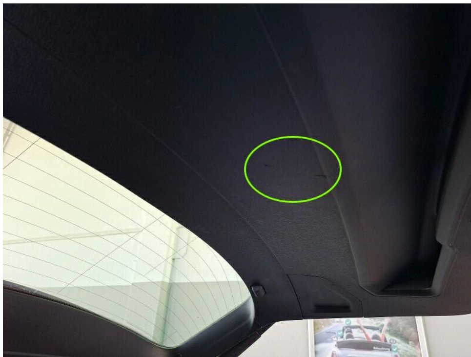
Bild 22 : Heckklappenverkleidung punktuell zerkratzt
