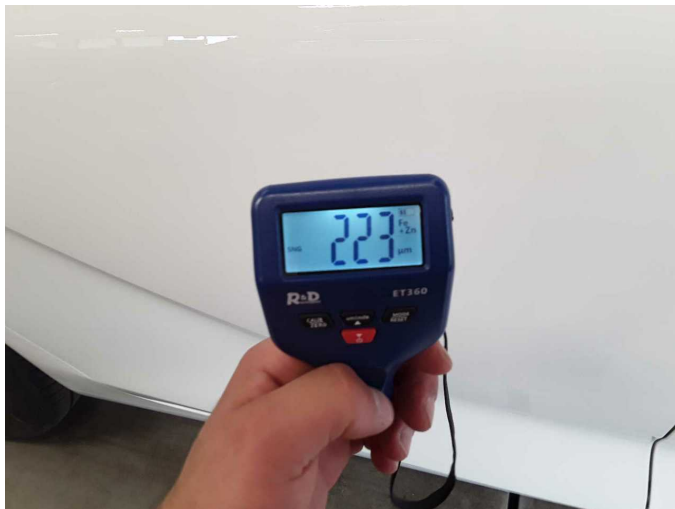
Door - front right side: 223 µm
