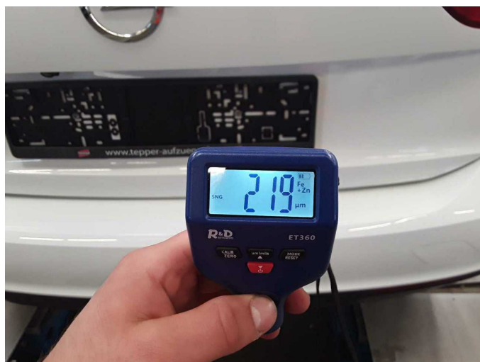
Boot lid / rear door: 219 µm
