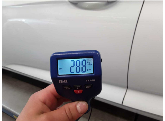
Door - front left side: 288 µm
