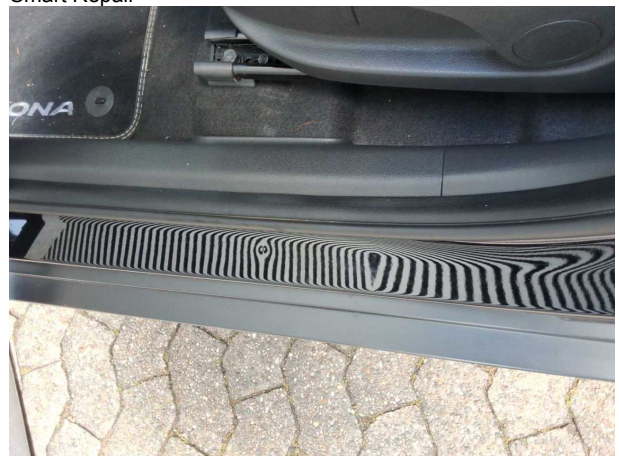
Beschädigung #2: Schweller links: Einstieg - Delle(n) - sanft instandsetzen
