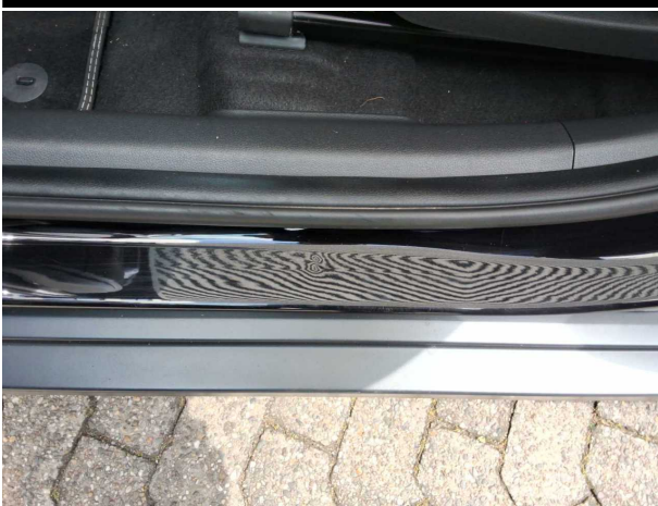
Beschädigung #2: Schweller links: Einstieg - Delle(n) - sanft instandsetzen
