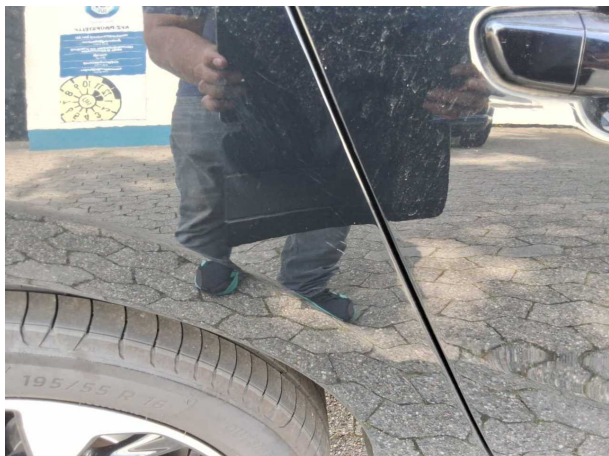
Beschädigung #1: Seitenwand rechts: Seitenwand - Kratzer - Smart Repair
