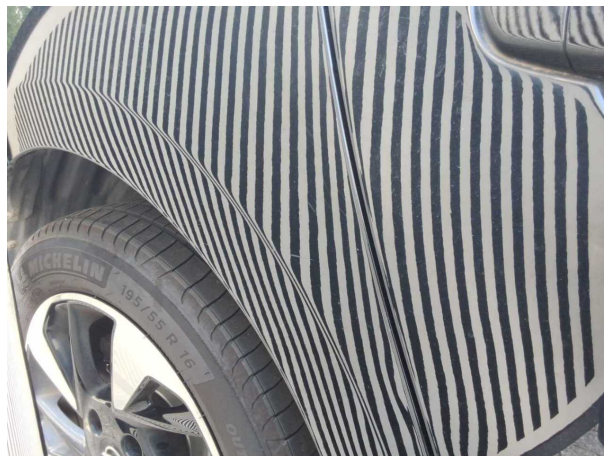
Beschädigung #1: Seitenwand rechts: Seitenwand - Kratzer - Smart Repair
