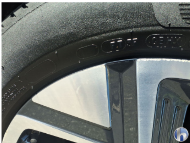
1. Felge Vorne - Rechts Kratzer - Erneuern
