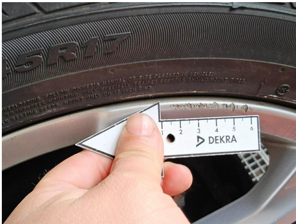
Bild 19 : Felge vorne rechts Lackierung, zerkratzt, lackieren
