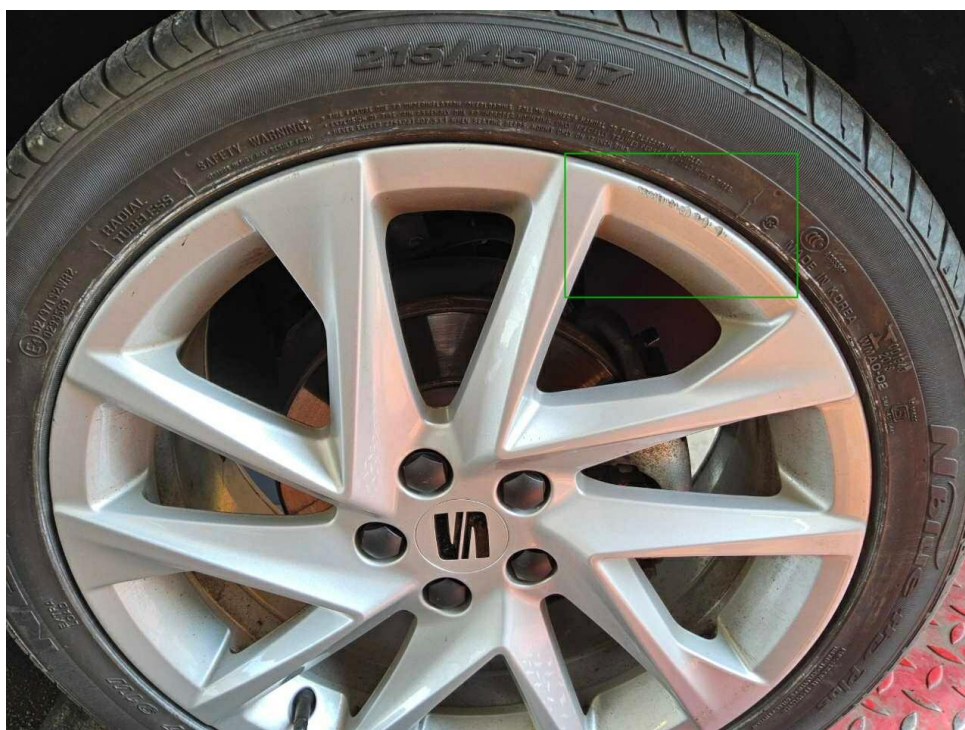
Bild 18 : Felge vorne rechts Lackierung, zerkratzt, lackieren
