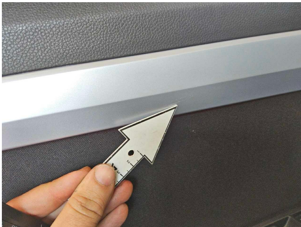
Bild 13 : Verkleidung Tür vorne links, zerkratzt, Gebrauchsspur
