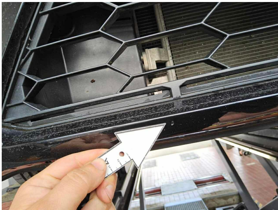
Bild 15 : Stoßfänger vorne Lackierung, Steinschlag, Gebrauchsspur
