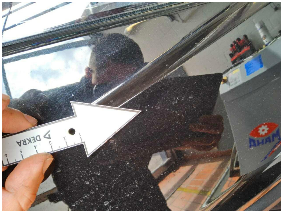
Bild 14 : Stoßfänger vorne Lackierung, Steinschlag, Gebrauchsspur
