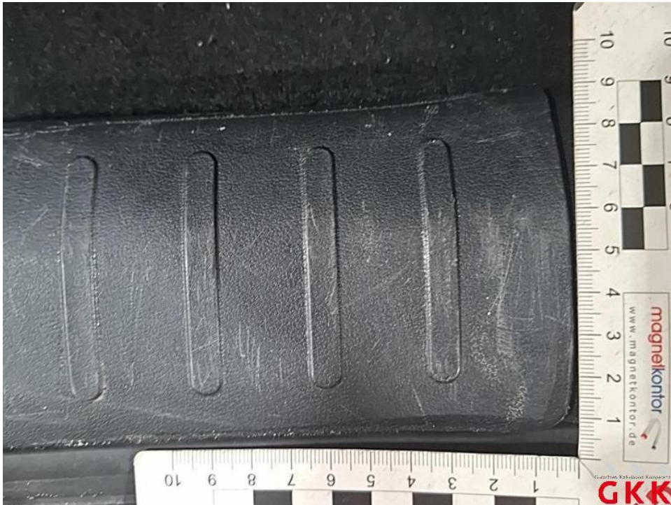
Bild 58. Ladekante, Abdeckung, beschädigt, ersetzen
