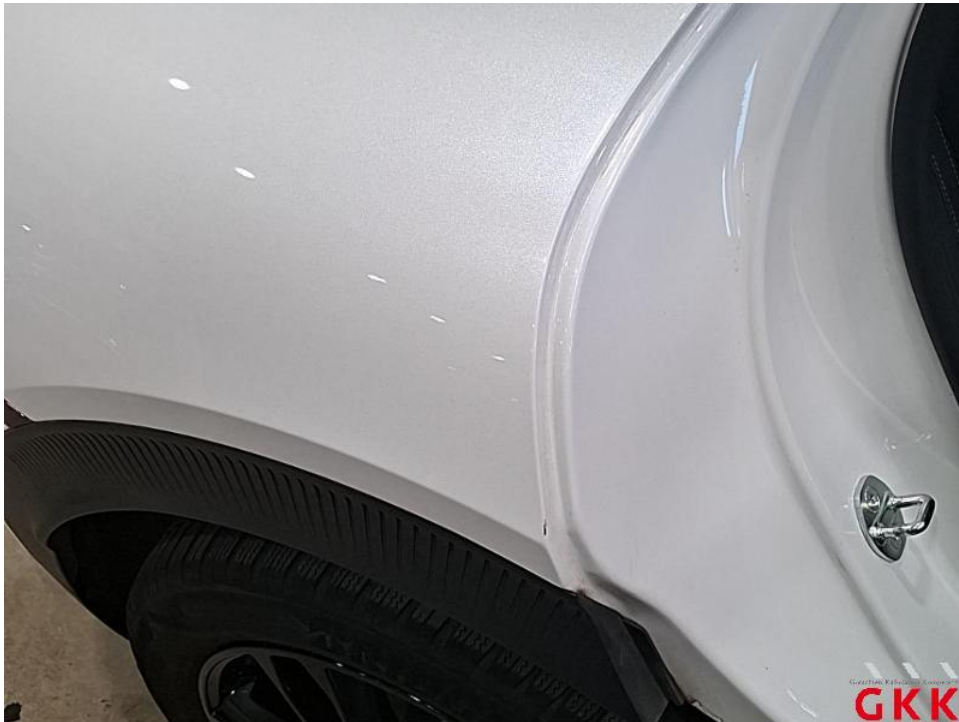
Bild 68. Seitenwand rechts, verkratzt, Smartrepair
