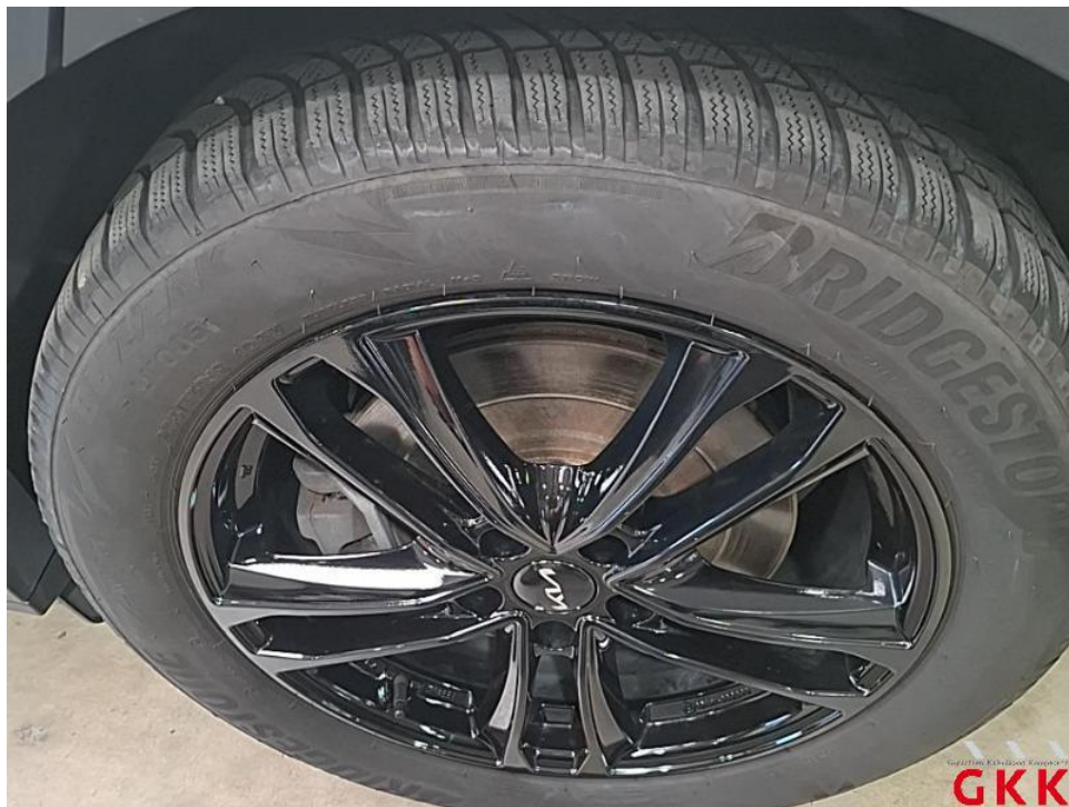
Bild 76. Reifen, hinten links, porös, ersetzen
