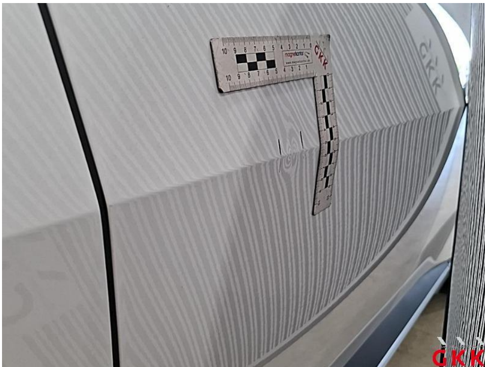
Bild 80. Tür vorne rechts, beschädigt, instand setzen - lackieren
