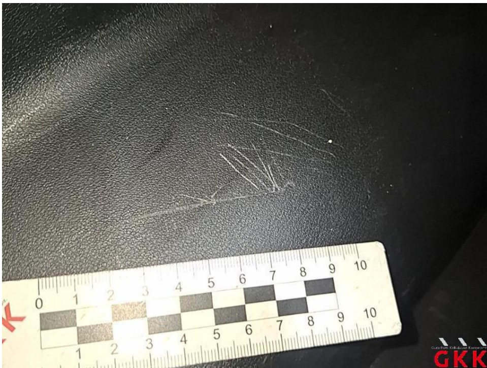
Bild 52. Seitenwand links, Innenverkleidung, verkratzt, ersetzen
