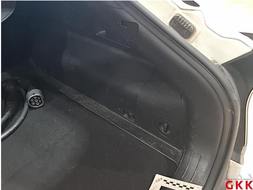
Bild 53. Seitenwand rechts, Innenverkleidung, beschädigt, ersetzen
