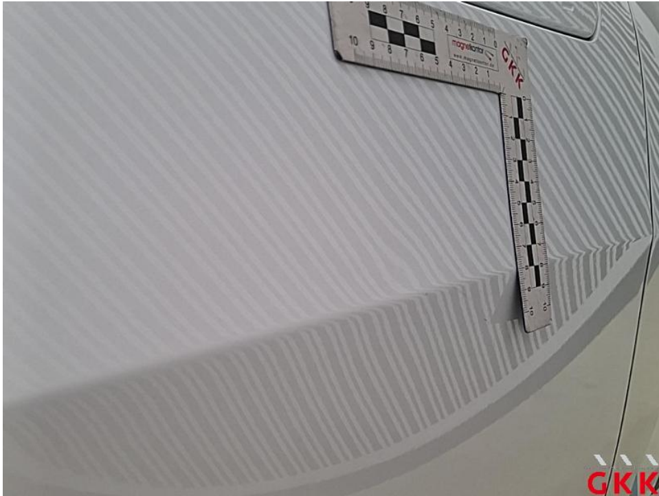
Bild 33. Tür vorne links, beschädigt, instand setzen - lackieren
