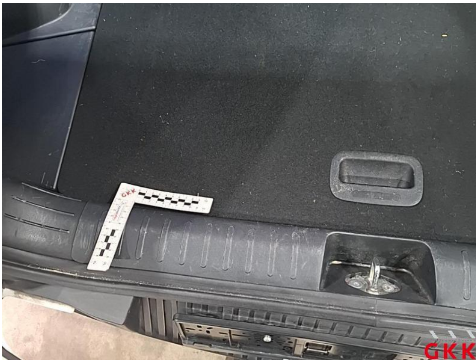
Bild 56. Ladekante, Abdeckung, beschädigt, ersetzen
