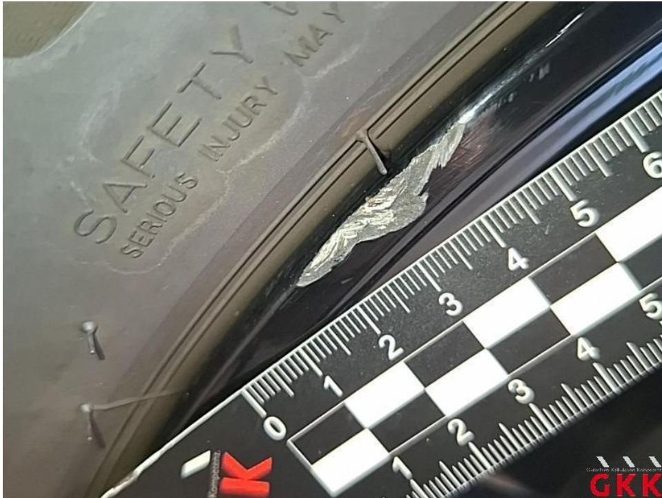
Bild 19. LM-Rad, vorne rechts, Materialabtrag, ersetzen
