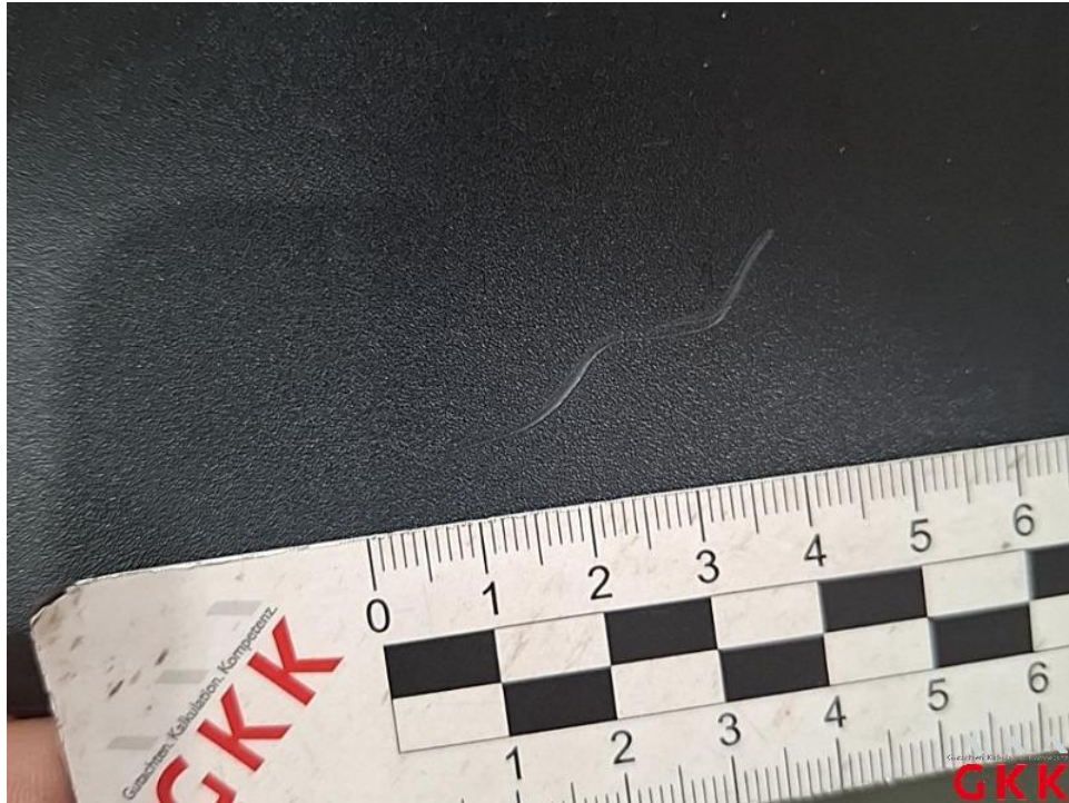
Bild 63. Stoßfänger hinten, Spoiler -unlackiert-, verkratzt, Smartrepair
