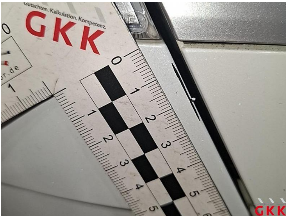
Bild 60. Stoßfänger hinten, Ecke links -lackiert-, verkratzt, lackieren
