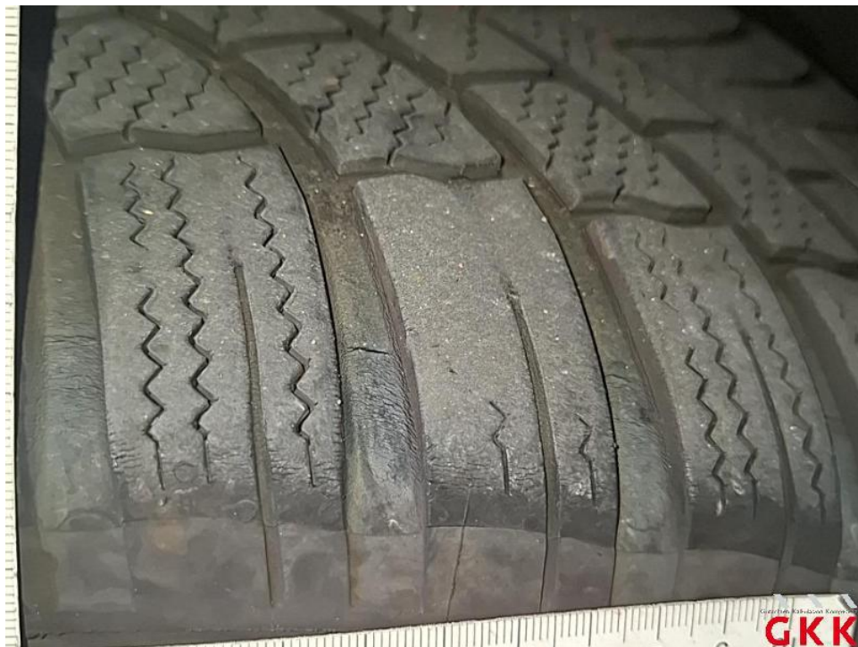
Bild 78. Reifen, hinten links, porös, ersetzen
