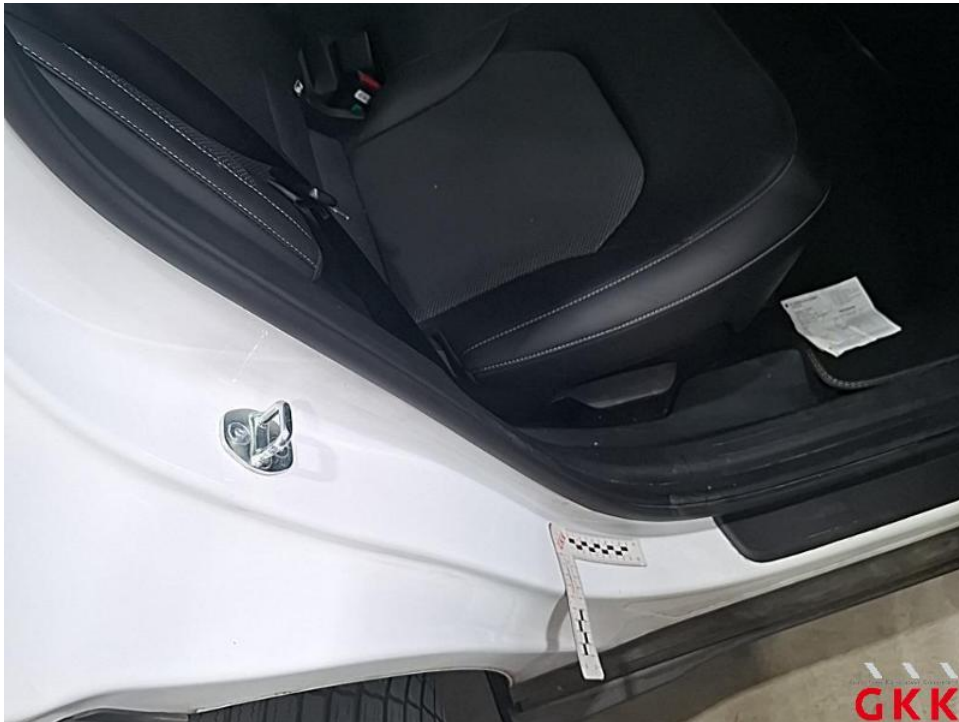
Bild 70. Tür hinten rechts, Einstieg, beschädigt, instand setzen - lackieren
