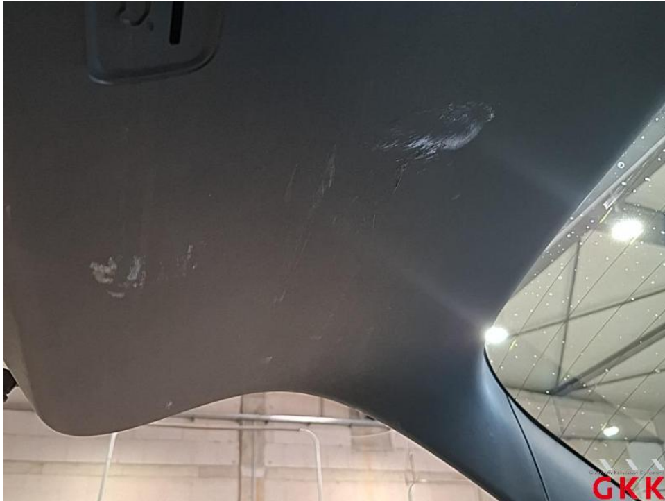
Bild 47. Heckklappe, Innenverkleidung, beschädigt, ersetzen
