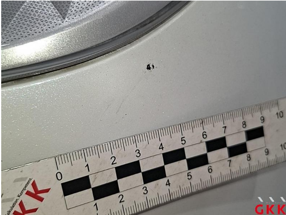
Bild 67. Stoßfänger hinten, Ecke rechts -lackiert-, verkratzt, lackieren
