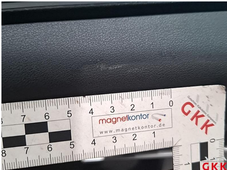
Bild 38. Tür hinten links, Innenverkleidung -Standard-, verkratzt, Smartrepair
