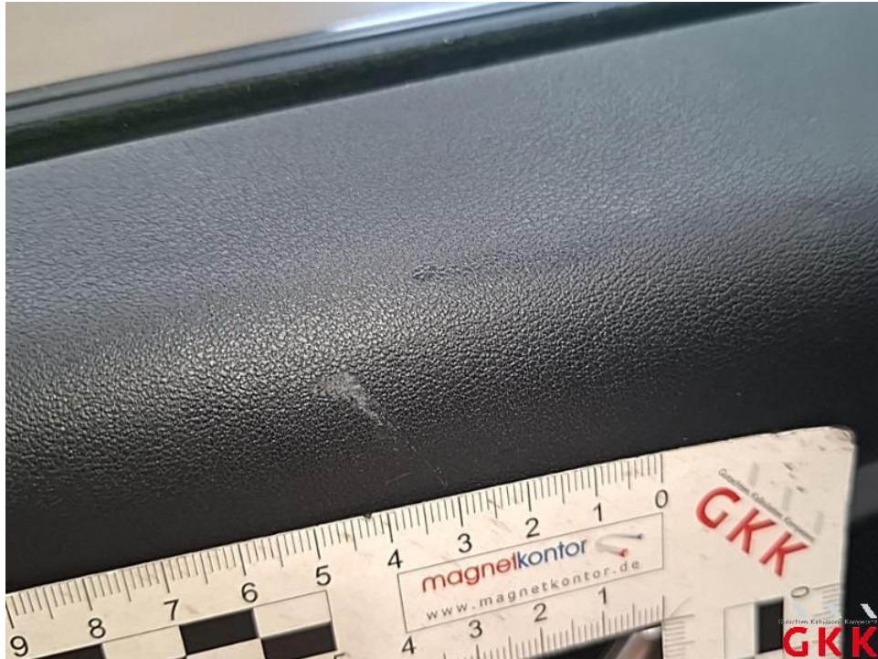
Bild 37. Tür hinten links, Innenverkleidung -Standard-, verkratzt, Smartrepair
