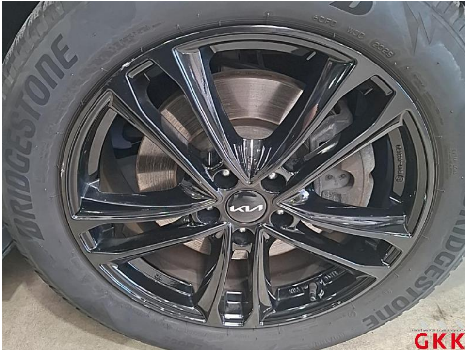
Bild 17. LM-Rad, vorne rechts, Materialabtrag, ersetzen
