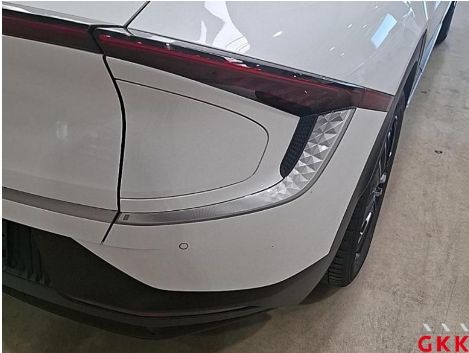
Bild 65. Stoßfänger hinten, Ecke rechts -lackiert-, verkratzt, lackieren
