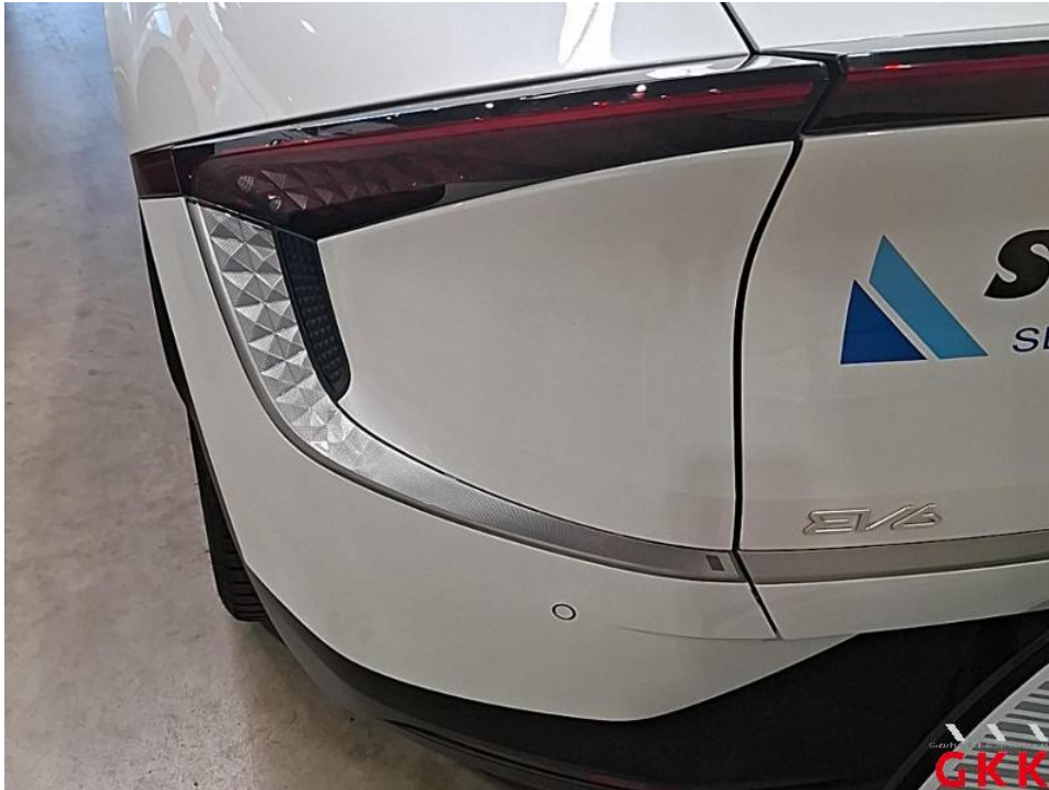
Bild 59. Stoßfänger hinten, Ecke links -lackiert-, verkratzt, lackieren
