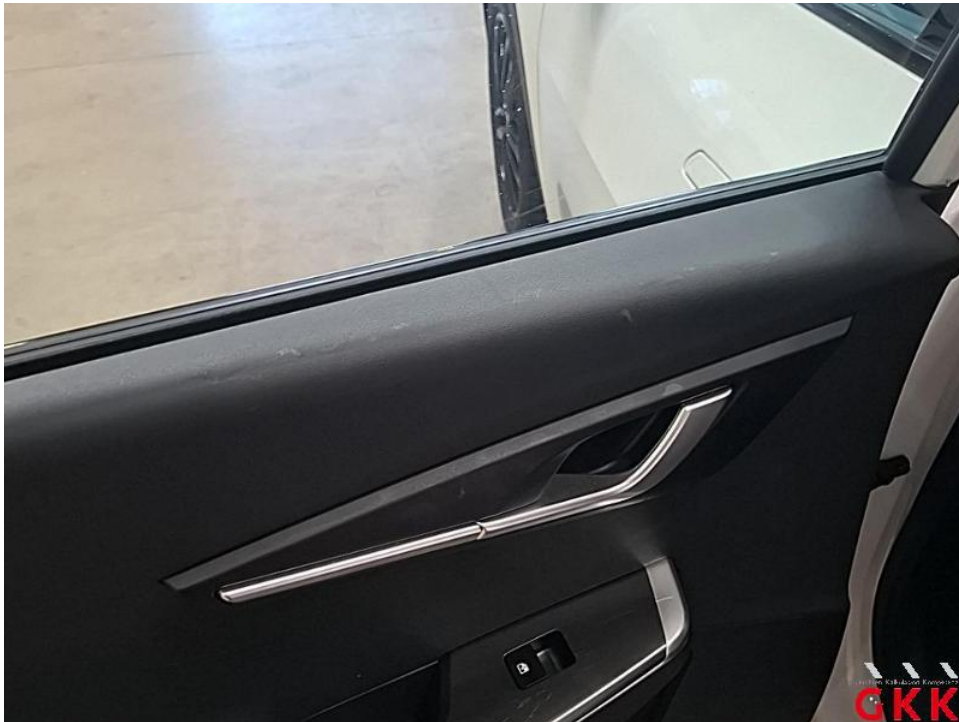
Bild 36. Tür hinten links, Innenverkleidung -Standard-, verkratzt, Smartrepair
