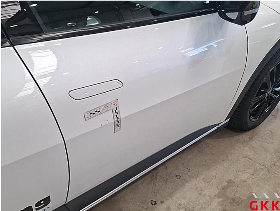
Bild 79. Tür vorne rechts, beschädigt, instand setzen - lackieren
