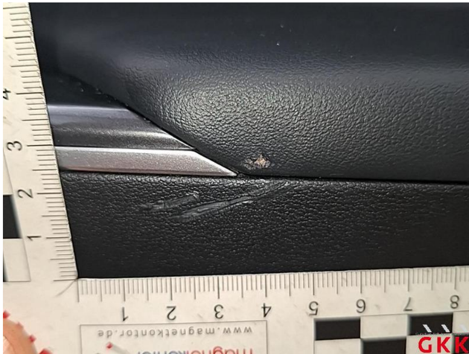
Bild 83. Tür vorne rechts, Innenverkleidung -Abdeckung-, beschädigt, ersetzen
