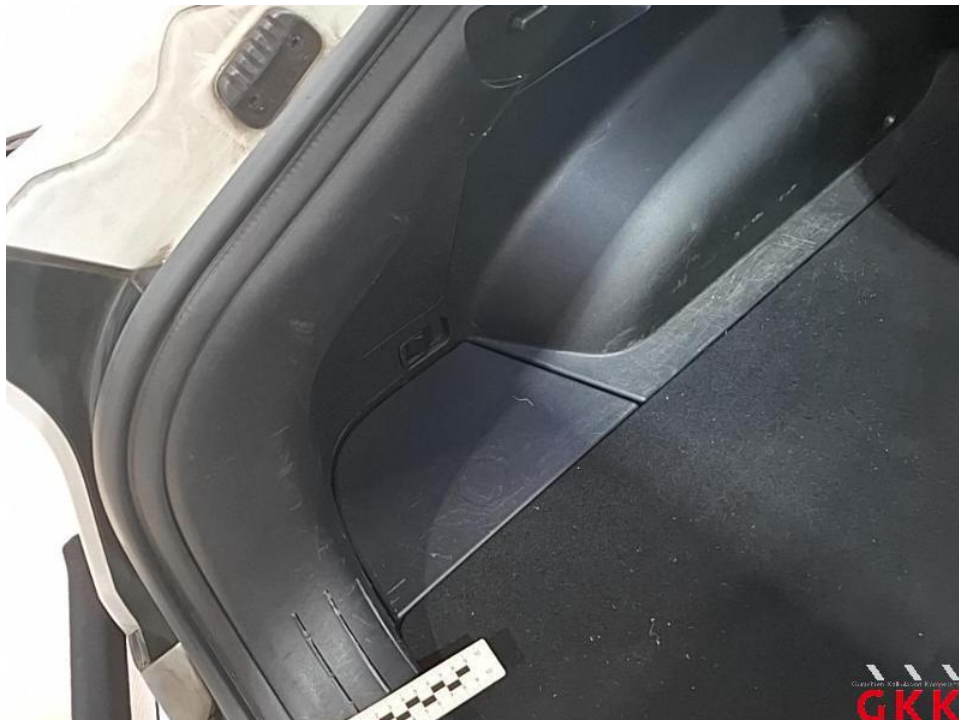
Bild 50. Seitenwand links, Innenverkleidung, verkratzt, ersetzen
