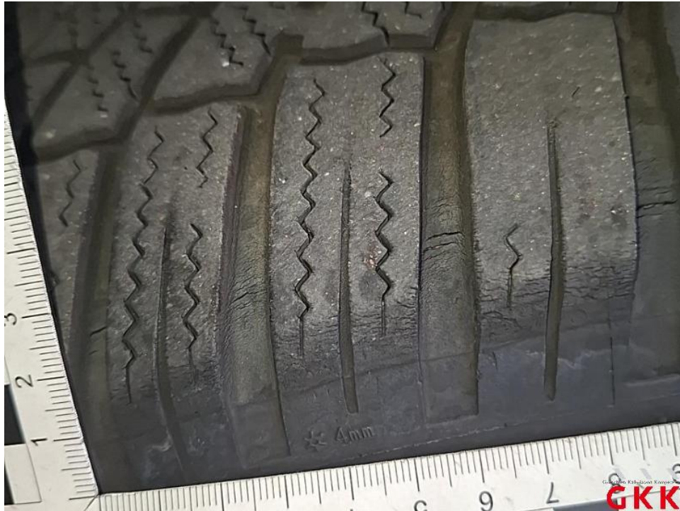
Bild 75. Reifen, hinten rechts, beschädigt, ersetzen
