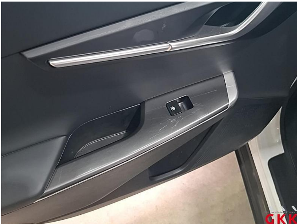
Bild 39. Tür hinten links, Innenverkleidung -Standard-, verkratzt, ersetzen
