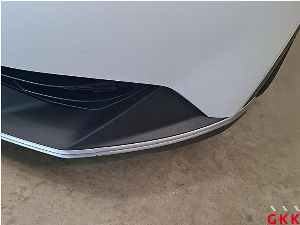
Bild 27. Stoßfänger vorne, Spoiler -unlackiert-, Steinschlag und Kratzer, ersetzen
