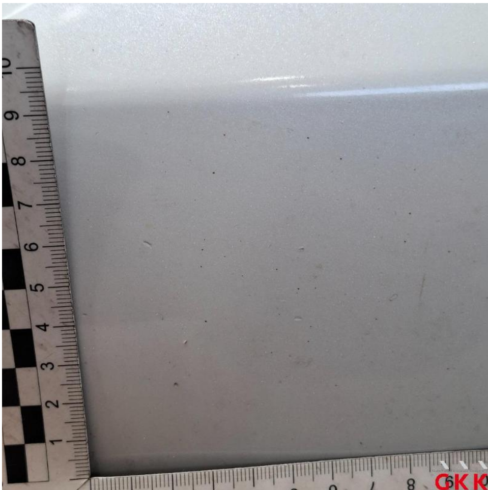
Bild 24. Stoßfänger vorne, Verkleidung oberhalb -lackiert-, verkratzt, lackieren
