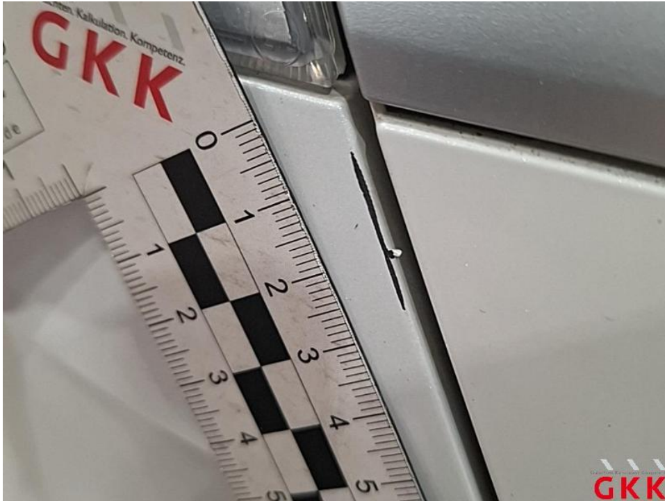
Bild 61. Stoßfänger hinten, Ecke links -lackiert-, verkratzt, lackieren
