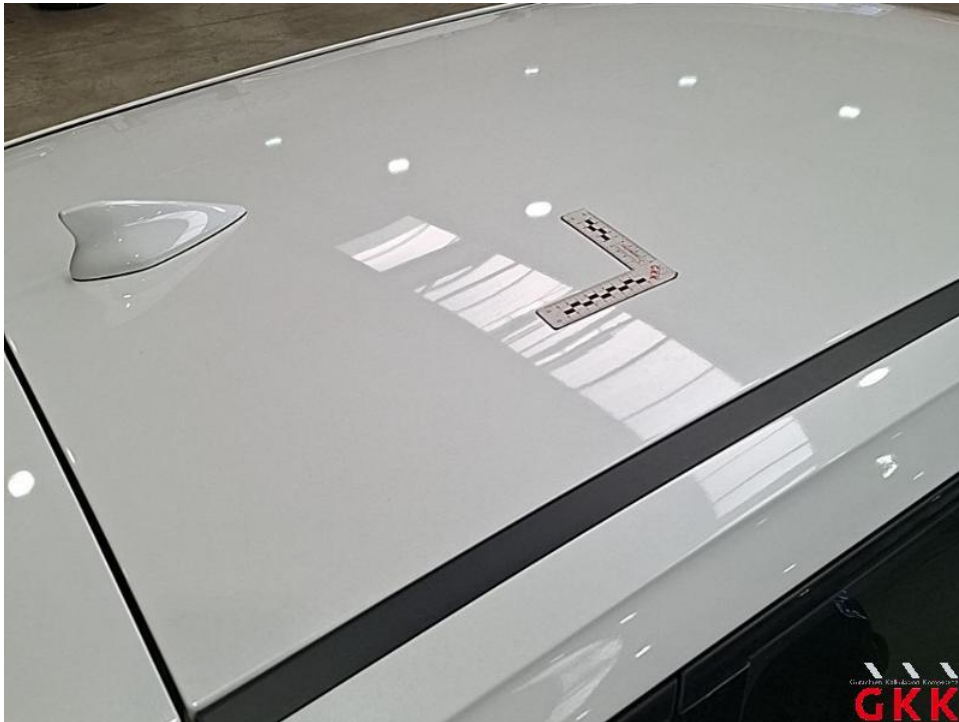
Bild 42. Dach, Hagelschaden, kalt drücken
