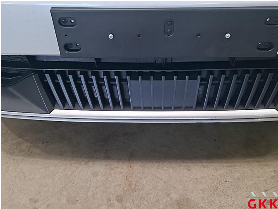
Bild 26. Stoßfänger vorne, Spoiler -unlackiert-, Steinschlag und Kratzer, ersetzen
