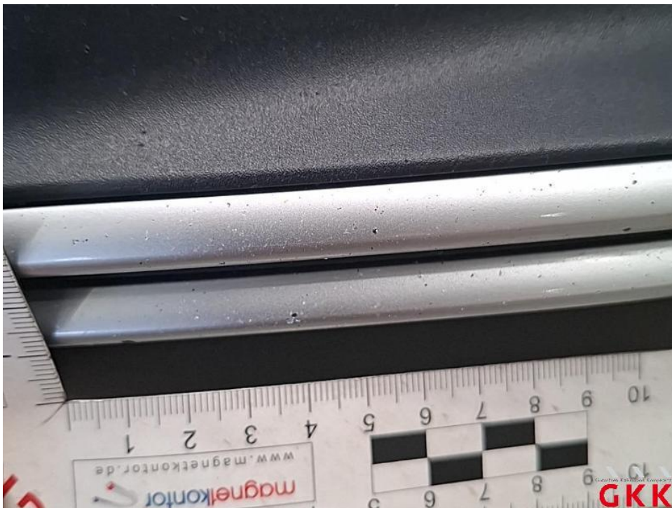
Bild 28. Stoßfänger vorne, Spoiler -unlackiert-, Steinschlag und Kratzer, ersetzen
