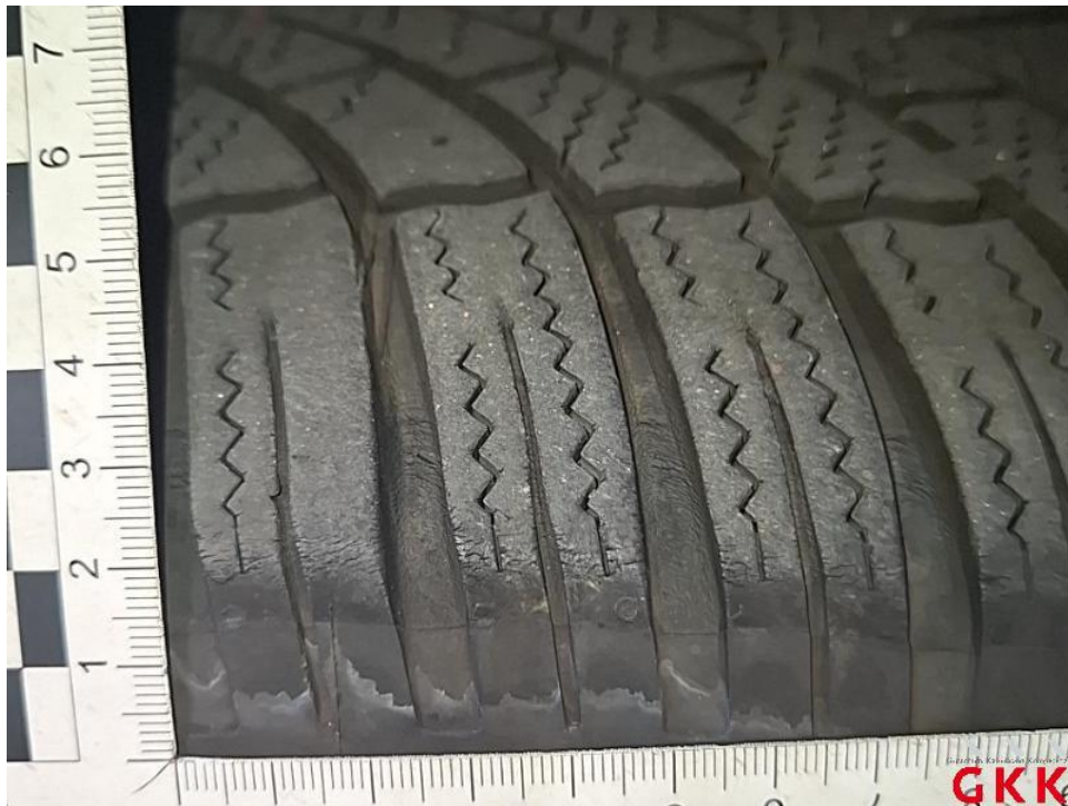
Bild 77. Reifen, hinten links, porös, ersetzen
