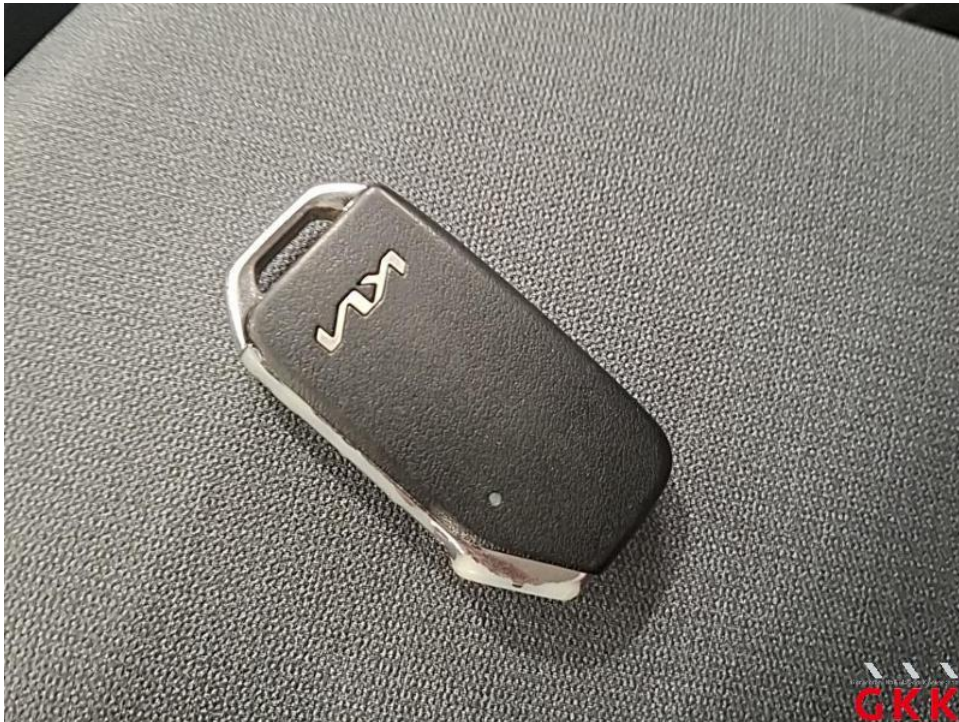
Bild 14. Hauptschlüssel, mit Fernbedienung, beschädigt, ersetzen
