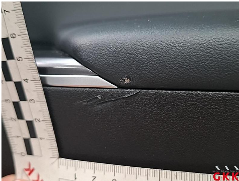
Bild 84. Tür vorne rechts, Innenverkleidung -Abdeckung-, beschädigt, ersetzen
