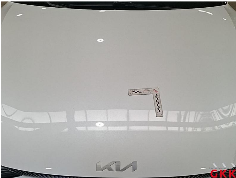
Bild 20. Motorhaube, Steinschlag und Kratzer, instand setzen - lackieren
