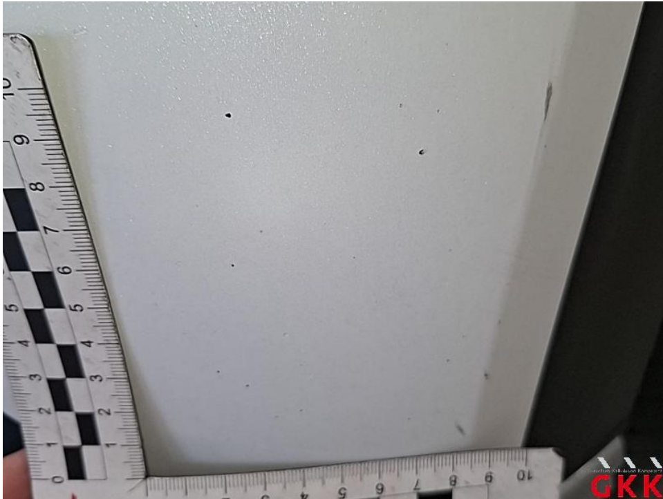
Bild 25. Stoßfänger vorne, Verkleidung oberhalb -lackiert-, verkratzt, lackieren
