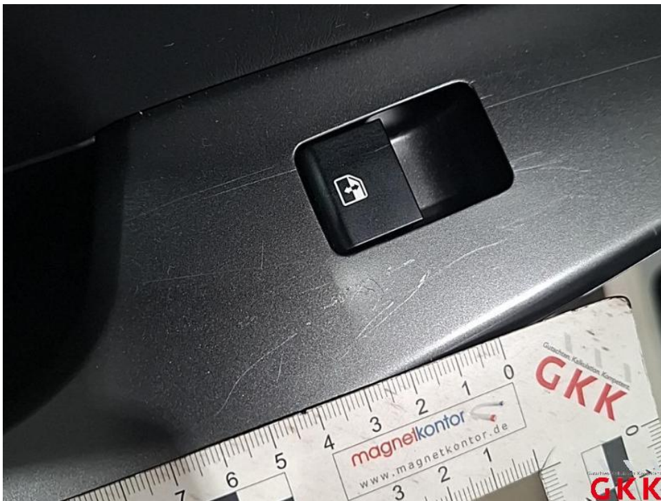
Bild 40. Tür hinten links, Innenverkleidung -Standard-, verkratzt, ersetzen
