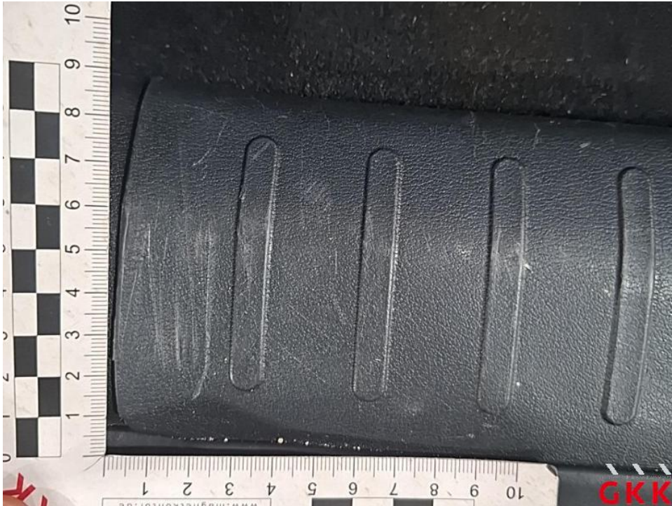
Bild 57. Ladekante, Abdeckung, beschädigt, ersetzen
