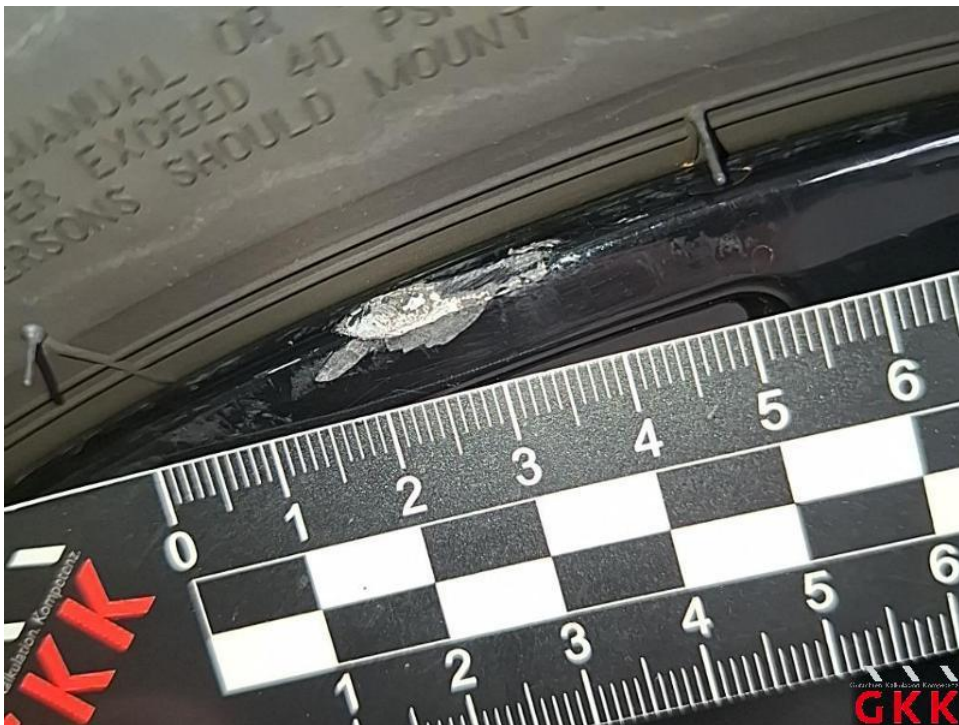
Bild 18. LM-Rad, vorne rechts, Materialabtrag, ersetzen
