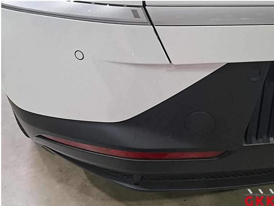
Bild 62. Stoßfänger hinten, Spoiler -unlackiert-, verkratzt, Smartrepair
