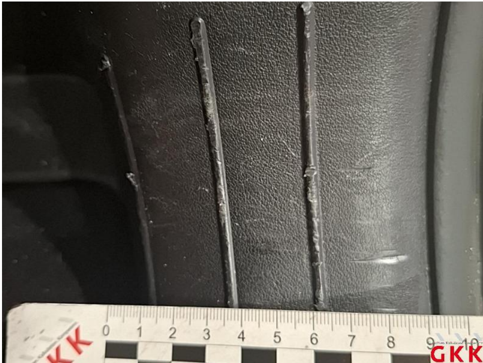
Bild 54. Seitenwand rechts, Innenverkleidung, beschädigt, ersetzen
