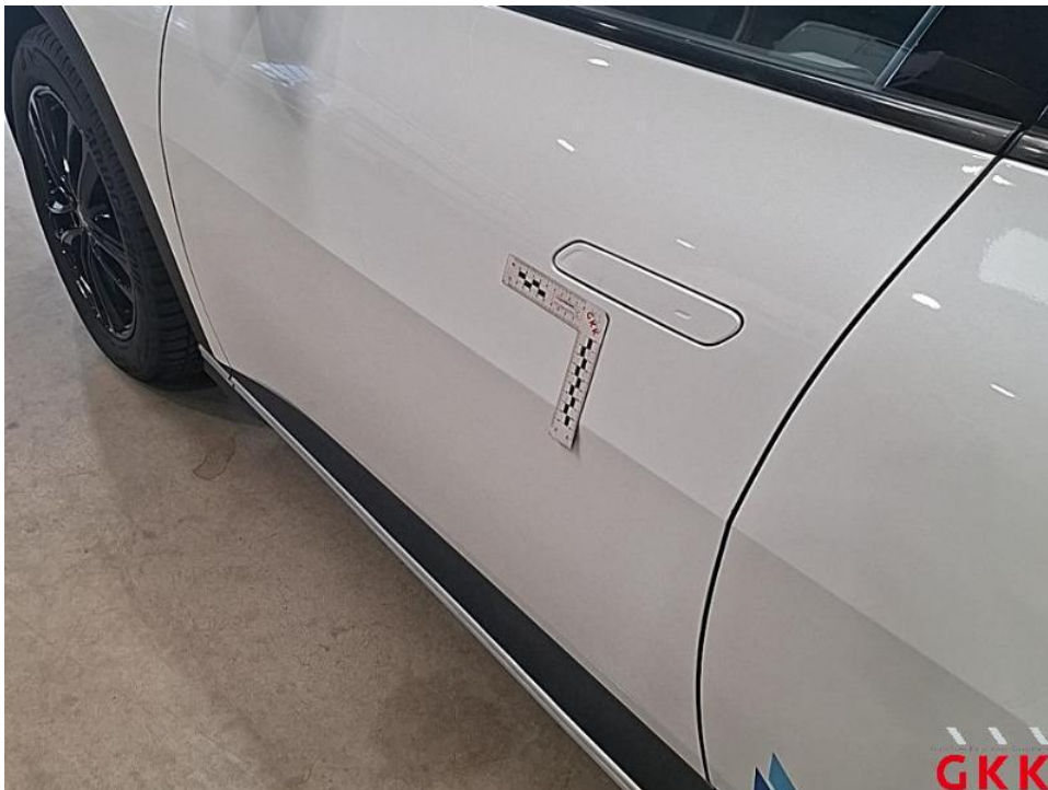
Bild 31. Tür vorne links, beschädigt, instand setzen - lackieren
