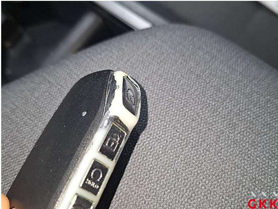
Bild 16. Hauptschlüssel, mit Fernbedienung, beschädigt, ersetzen
