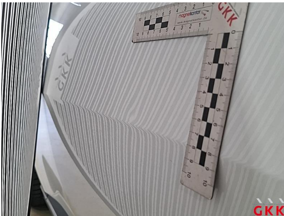
Bild 32. Tür vorne links, beschädigt, instand setzen - lackieren
