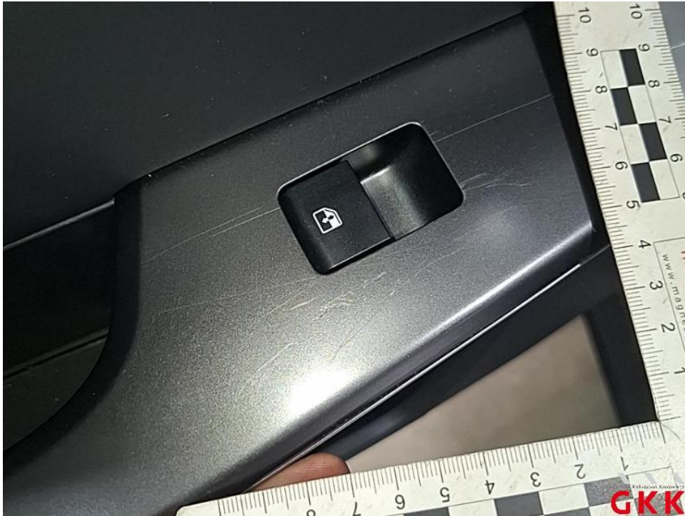
Bild 41. Tür hinten links, Innenverkleidung -Standard-, verkratzt, ersetzen
