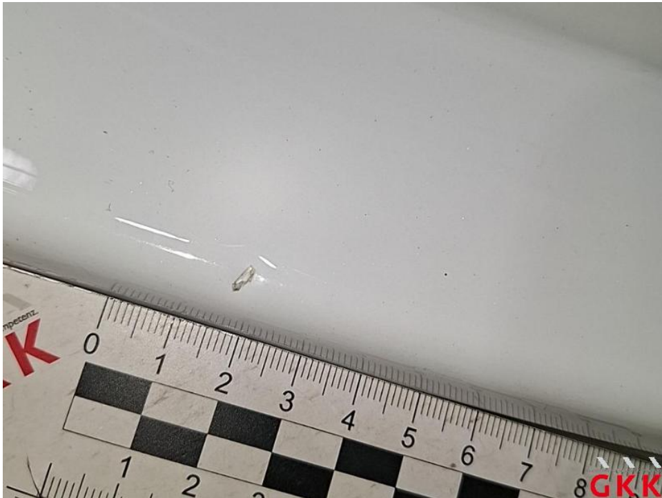
Bild 72. Tür hinten rechts, Einstieg, beschädigt, instand setzen - lackieren
