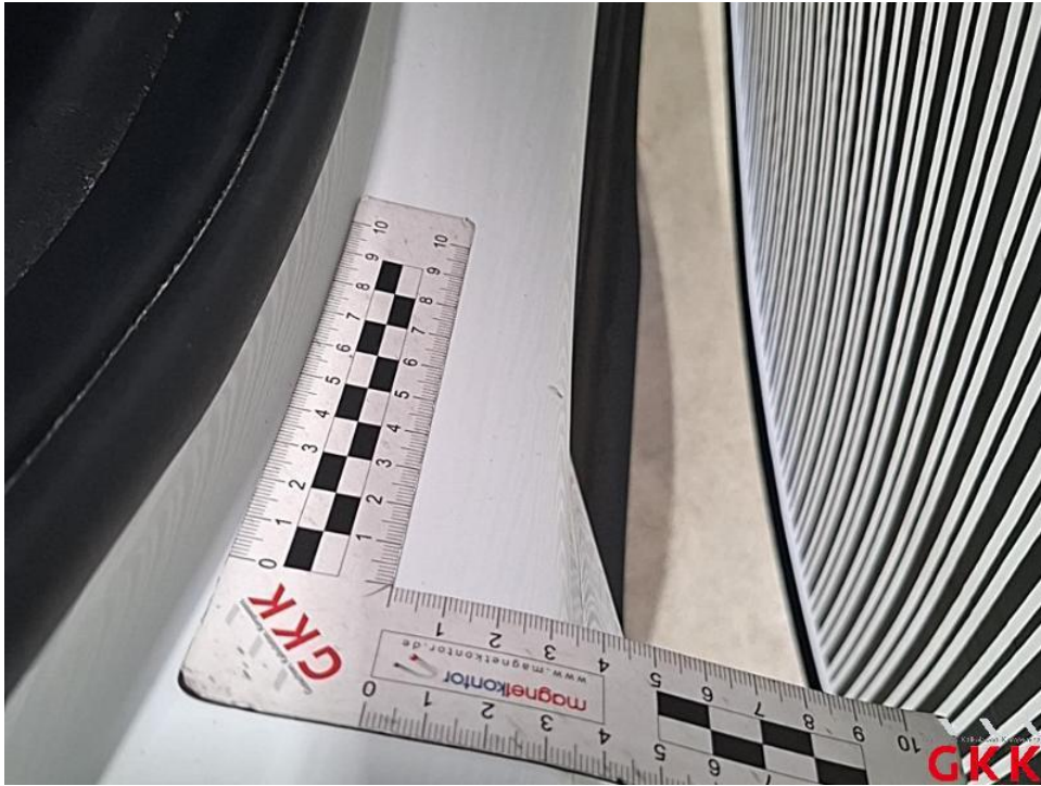
Bild 71. Tür hinten rechts, Einstieg, beschädigt, instand setzen - lackieren
