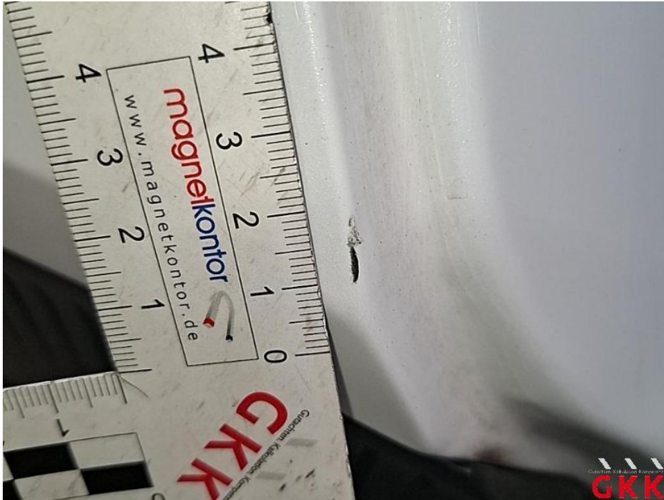
Bild 69. Seitenwand rechts, verkratzt, Smartrepair
