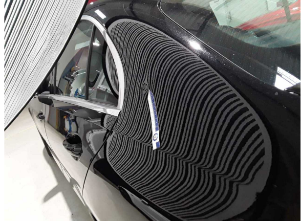
Beschädigung #1: Seitenwand links: Seitenwand - Delle(n) - sanft instandsetzen
