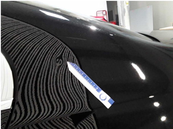
Beschädigung #1: Seitenwand links: Seitenwand - Delle(n) - sanft instandsetzen
