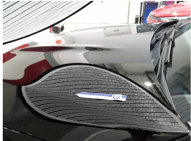
Beschädigung #2: Motorhaube: Motorhaube - Delle(n) - sanft instandsetzen
