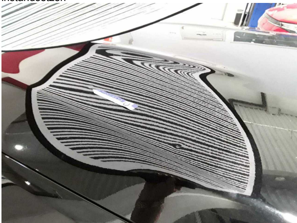
Beschädigung #2: Motorhaube: Motorhaube - Delle(n) - sanft instandsetzen
