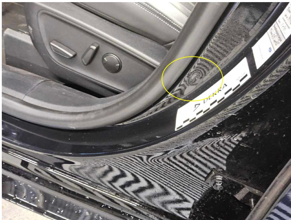
Bild 15 : Tür vorne links Einstieg, eingedellt, smart repair
