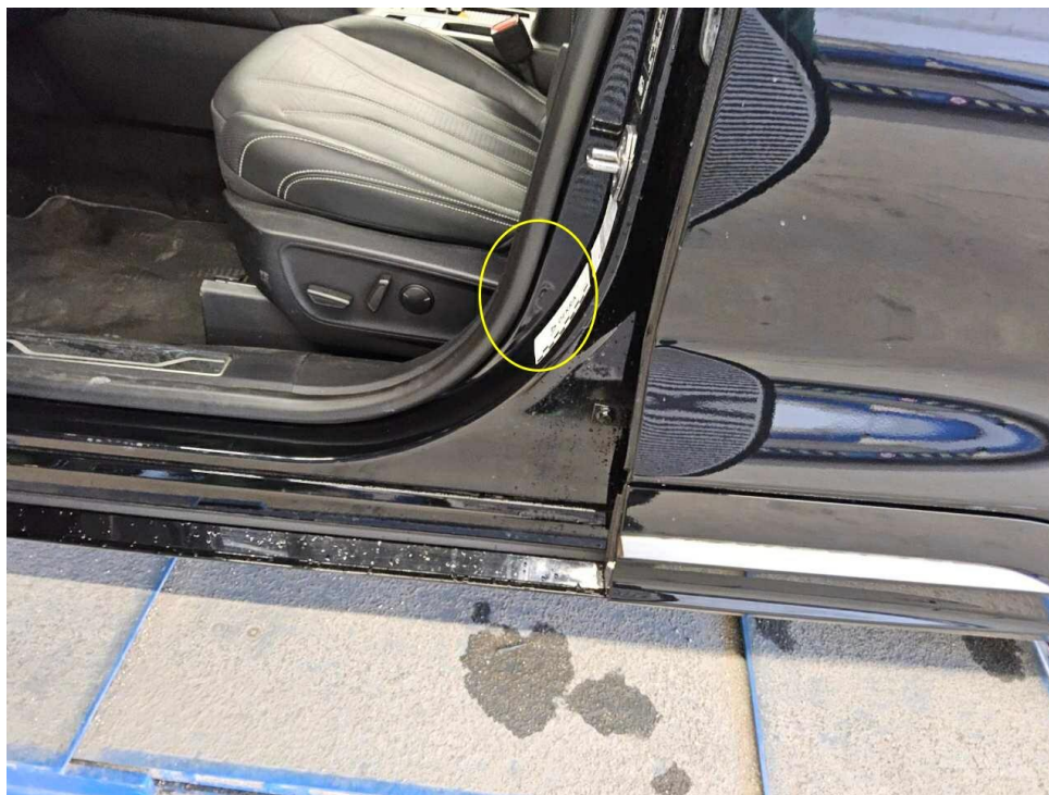
Bild 14 : Tür vorne links Einstieg, eingedellt, smart repair
