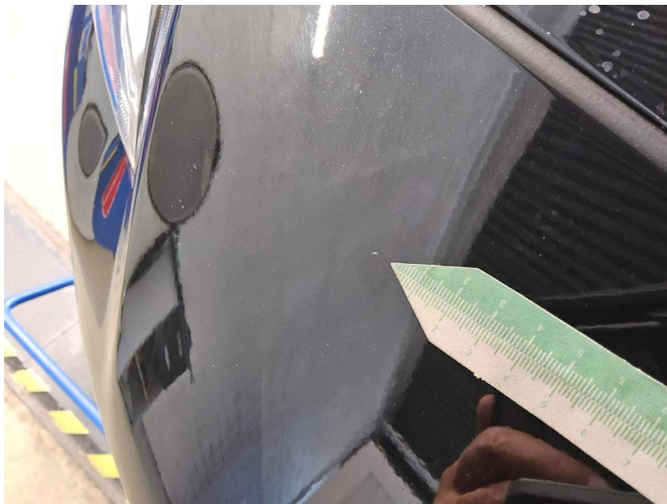
Bild 23 : Stoßfänger vorne Lackierung, Steinschlag, Gebrauchsspur
