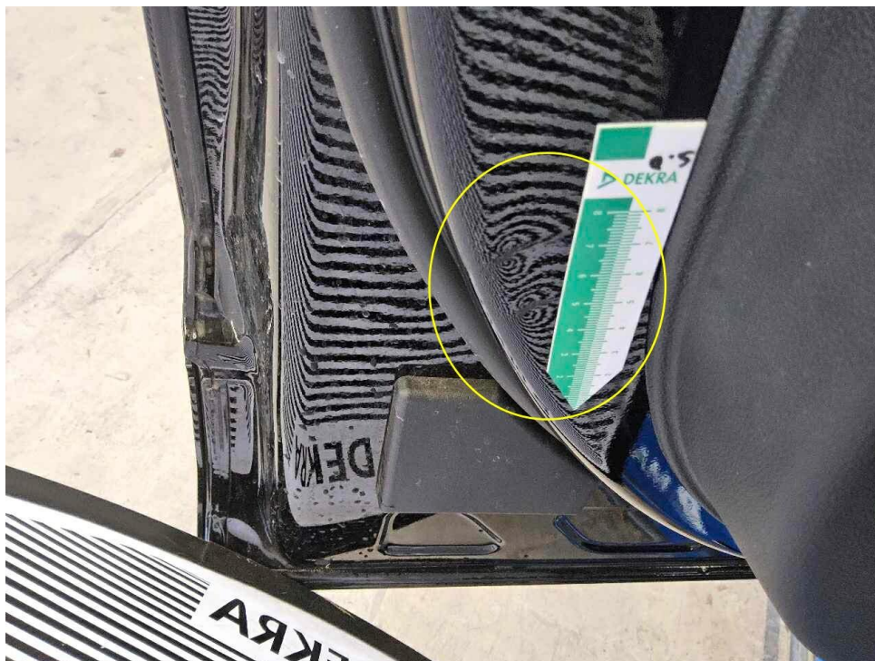
Bild 29 : Türrahmen vorne links eingedellt
