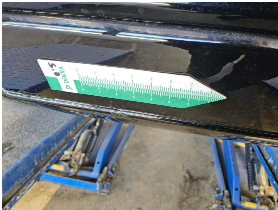
Bild 21 : Heckschürze hinten unten Lackierung, zerkratzt, Gebrauchsspur
