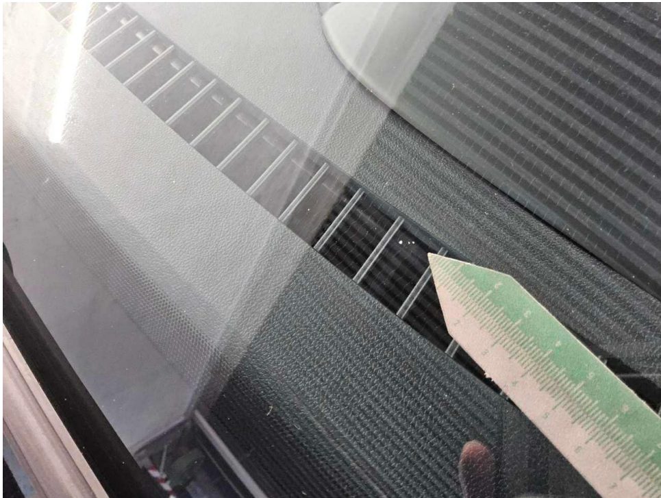
Bild 27 : Frontscheibe, Steinschlag, Gebrauchsspur
