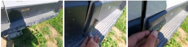
Boot door lining R, Broken, Replace
