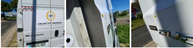
Boot door lining R, Broken, Replace
