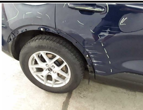
Beschädigung #8: Seitenwand rechts: Radhausverbreiterung... gebrochen / gerissen - erneuern
