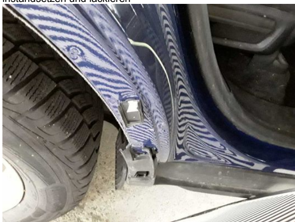
Beschädigung #13: Seitenwand rechts: Einstieg - verformt - instandsetzen und lackieren
