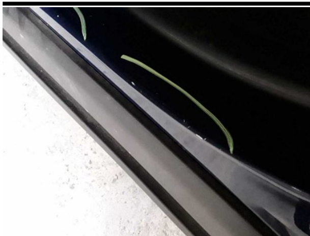
Beschädigung #7: Seitenwand links: Einstieg - verkratzt / verschürft - Smart Repair
