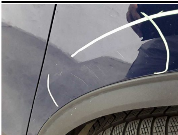
Beschädigung #14: Kotflügel rechts: Kotflügel rechts - Delle / Lackschaden - instandsetzen und lackieren
