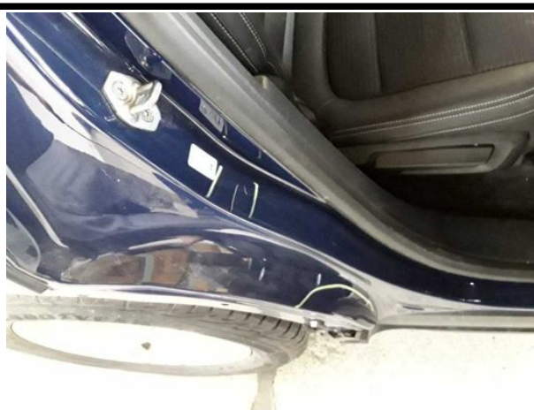
Beschädigung #13: Seitenwand rechts: Einstieg - verformt - instandsetzen und lackieren
