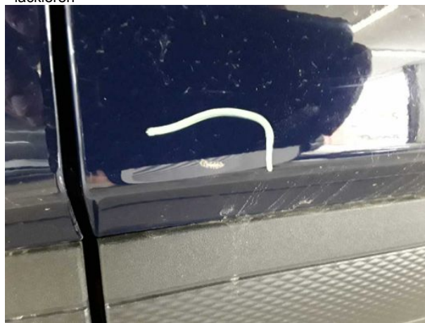
Beschädigung #16: Tür hinten links: Tür - verkratzt / verschürft - lackieren
