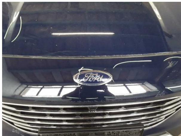
Beschädigung #2: Motorhaube: Emblem - verkratzt / verschürft - erneuern
