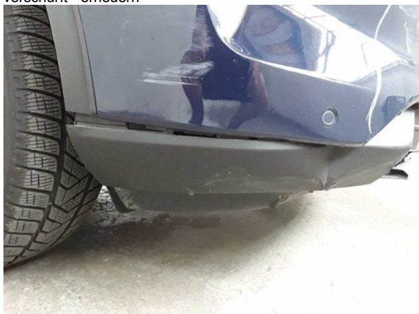
Beschädigung #11: Stossfänger vorn: Spoiler - verformt - erneuern
