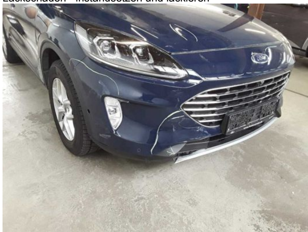
Beschädigung #21: Stossfänger vorn: Stossfänger vorn - verformt - erneuern
