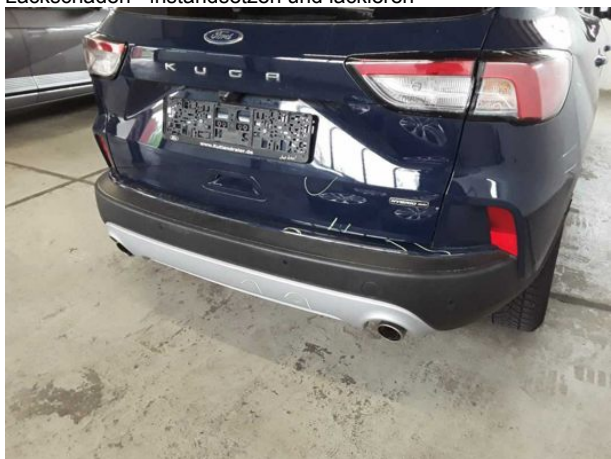
Beschädigung #15: Stossfänger hinten: Stossfänger hinten - verkratzt / verschürft - lackieren
