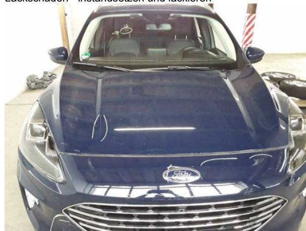
Beschädigung #19: Motorhaube: Motorhaube - verkratzt / verschürft - lackieren
