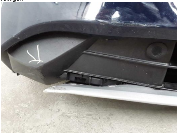
Beschädigung #6: Stossfänger vorn: Lufteinlassgitter - beschädigt - erneuern
