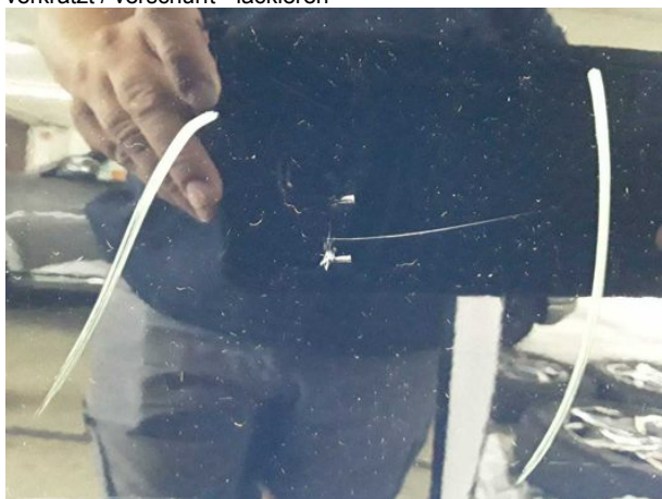
Beschädigung #16: Tür hinten links: Tür - verkratzt / verschürft - lackieren
