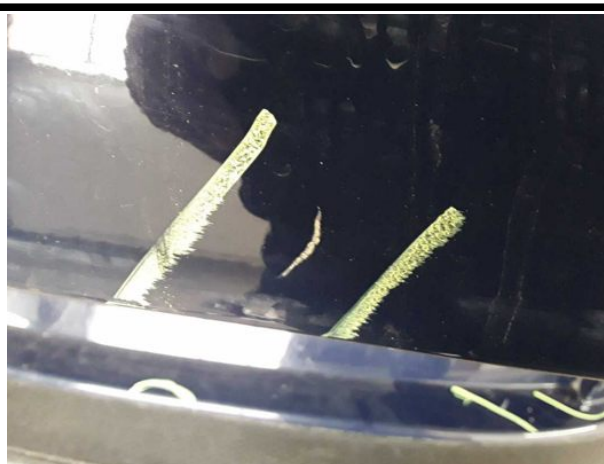
Beschädigung #20: Heckklappe/-tür: Heckklappe - Delle / Lackschaden - instandsetzen und lackieren
