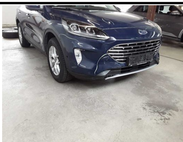
Beschädigung #11: Stossfänger vorn: Spoiler - verformt - erneuern
