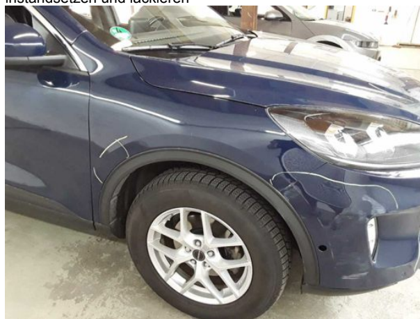
Beschädigung #14: Kotflügel rechts: Kotflügel rechts - Delle / Lackschaden - instandsetzen und lackieren
