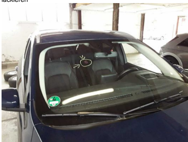
Beschädigung #17: Verglasung: Frontscheibe (Rissbildung) - Steinschlag - erneuern
