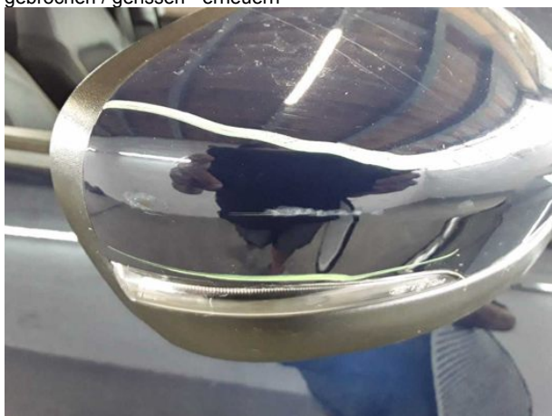
Beschädigung #9: Außenspiegel rechts: Abdeckkappe - verkratzt / verschürft - lackieren
