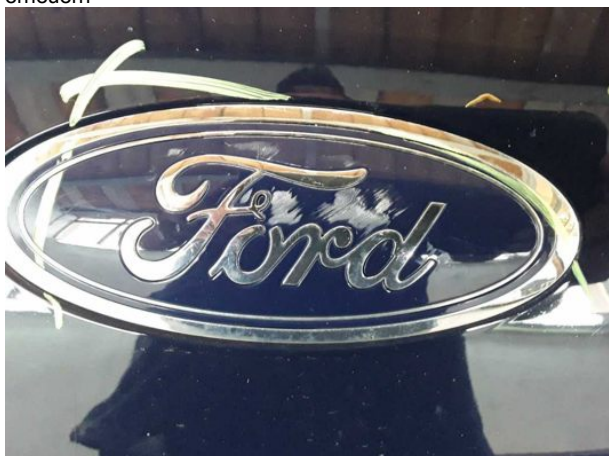
Beschädigung #2: Motorhaube: Emblem - verkratzt / verschürft - erneuern
