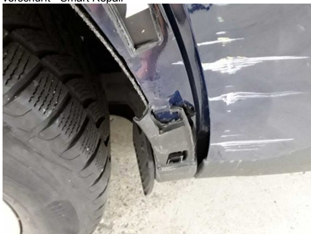
Beschädigung #8: Seitenwand rechts: Radhausverbreiterung - gebrochen / gerissen - erneuern
