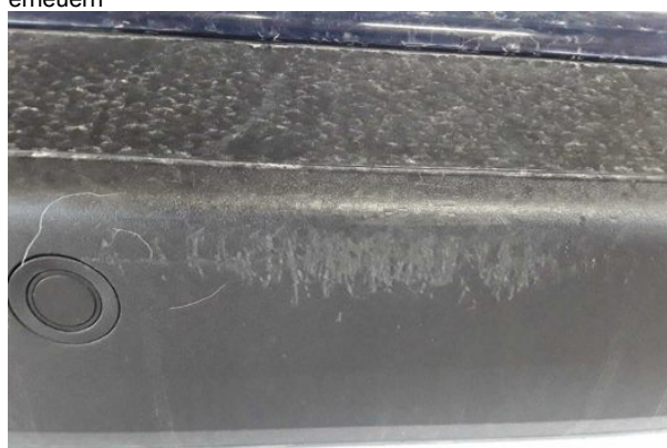
Beschädigung #11: Stossfänger vorn: Spoiler - verformt - erneuern
