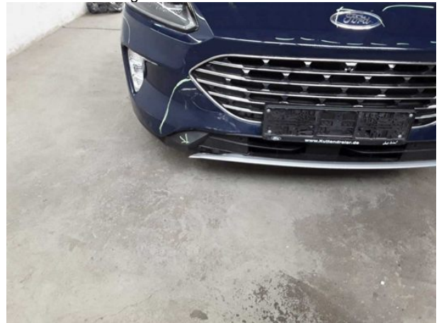
Beschädigung #6: Stossfänger vorn: Lufteinlassgitter - beschädigt - erneuern
