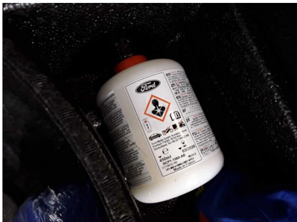
Beschädigung #1: Ausrüstung: Tirefit Füllmittel - abgelaufen - erneuern
