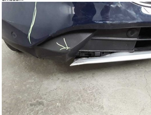
Beschädigung #11: Stossfänger vorn: Spoiler - verformt - erneuern
