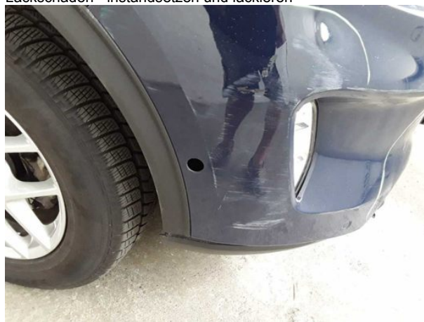
Beschädigung #21: Stossfänger vorn: Stossfänger vorn - verformt - erneuern
