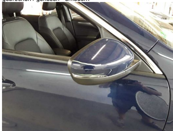
Beschädigung #9: Außenspiegel rechts: Abdeckkappe - verkratzt / verschürft - lackieren
