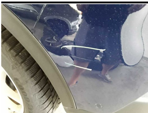
Beschädigung #15: Stossfänger hinten: Stossfänger hinten - verkratzt / verschürft - lackieren
