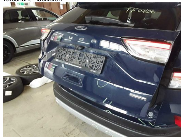
Beschädigung #20: Heckklappe/-tür: Heckklappe - Delle / Lackschaden - instandsetzen und lackieren
