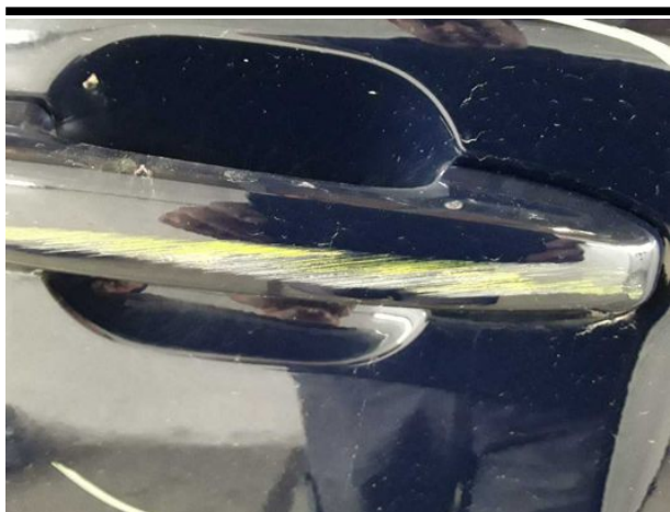
Beschädigung #10: Tür hinten rechts: Griff außen - verkratzt / verschürft - erneuern
