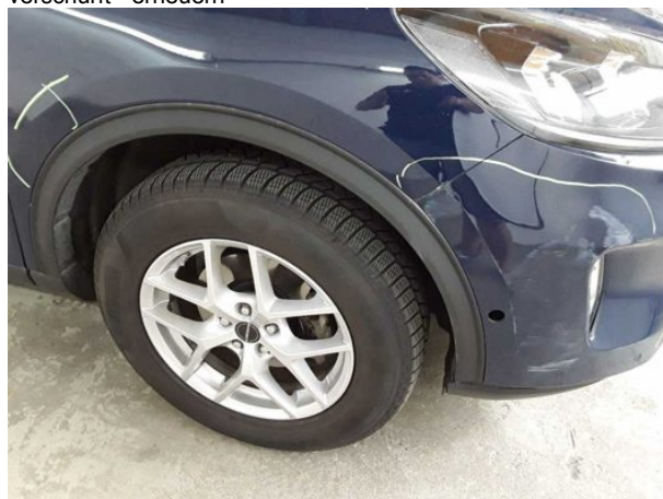
Beschädigung #3: Kotflügel rechts: Radhausverbreiterung - verkratzt / verschürft - Wertminderung
