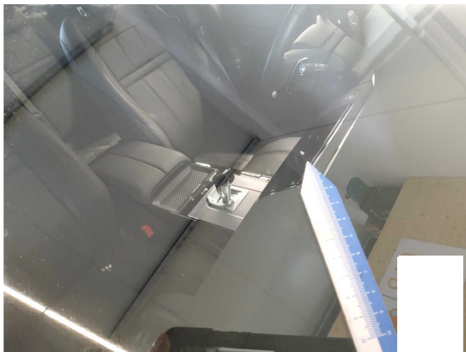
Gebrauchsspur 1: Verglasung: Frontscheibe mit Spurhalteassistent (Mikrosteinschläge) - Steinschlag
