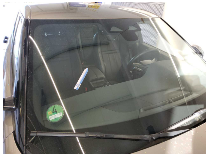
Gebrauchsspur 1: Verglasung: Frontscheibe mit Spurhalteassistent (Mikrosteinschläge) - Steinschlag
