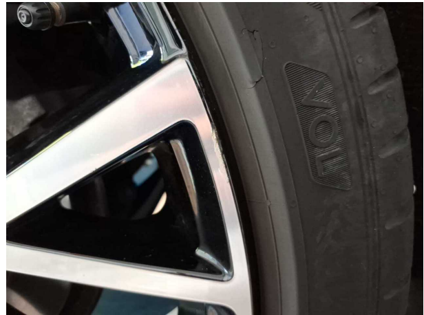
Beschädigung #4: Rad/Reifen: Reifen hinten rechts - gebrochen / gerissen - erneuern
