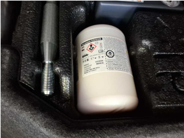
Beschädigung #1: Ausrüstung: Tirefit Füllmittel - abgelaufen - erneuern
