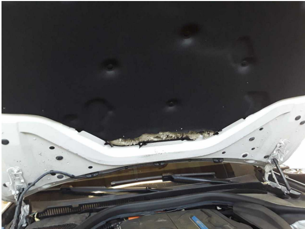
Beschädigung #1: Motorhaube: Dämmmatte - beschädigt - erneuern
