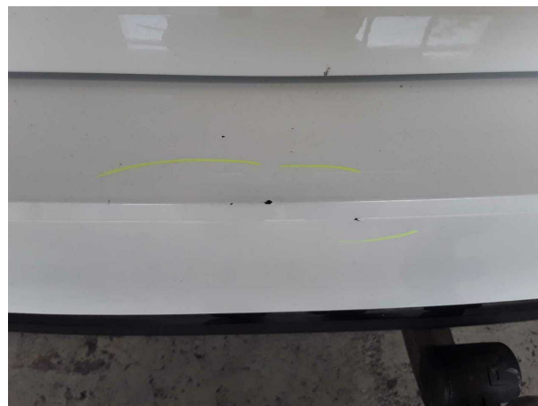
Beschädigung #6: Stossfänger hinten: Stossfänger hinten - verformt - erneuern
