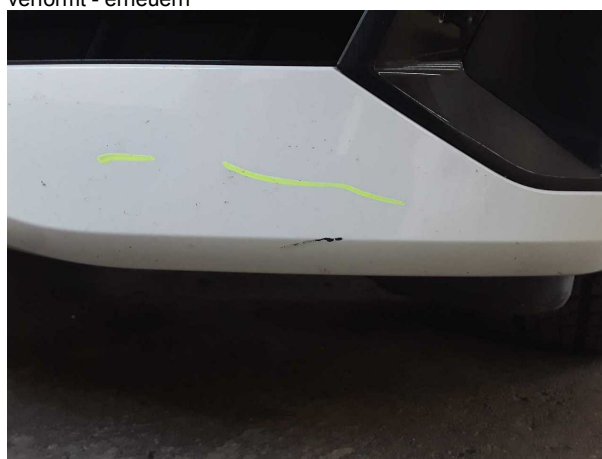
Beschädigung #7: Stossfänger vorn: Stossfänger vorn - verformt - erneuern
