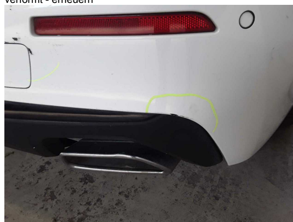
Beschädigung #6: Stossfänger hinten: Stossfänger hinten - verformt - erneuern
