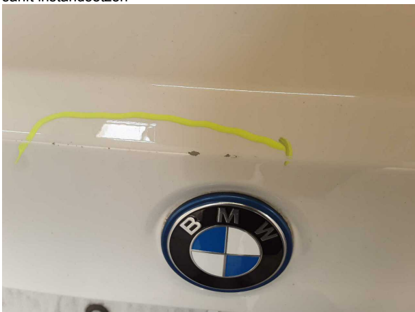
Beschädigung #4: Heckklappe/-tür: Heckklappe - verkratzt / verschürft - Smart Repair
