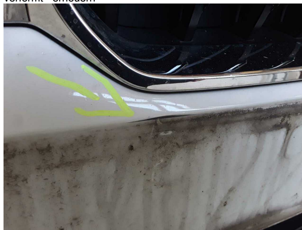
Beschädigung #7: Stossfänger vorn: Stossfänger vorn - verformt - erneuern
