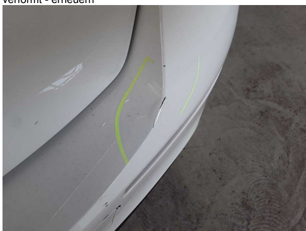
Beschädigung #6: Stossfänger hinten: Stossfänger hinten - verformt - erneuern
