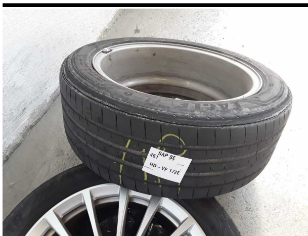
Beschädigung #5: 2.Radsatz: 2 Reifen - beschädigt - erneuern
