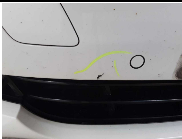
Beschädigung #7: Stossfänger vorn: Stossfänger vorn - verformt - erneuern
