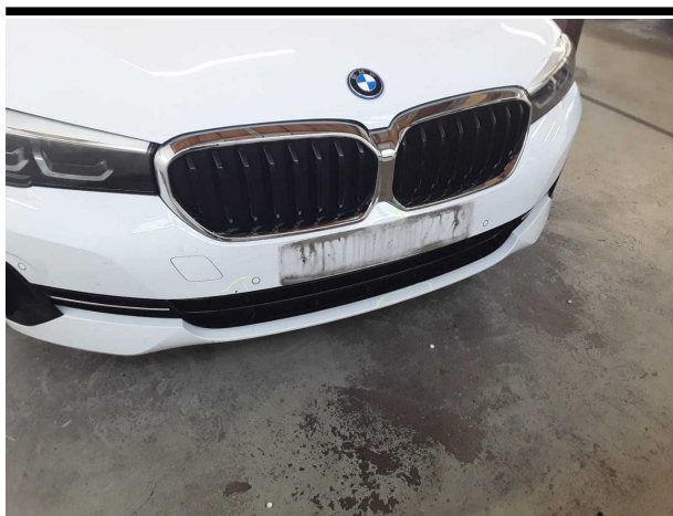
Beschädigung #7: Stossfänger vorn: Stossfänger vorn - verformt - erneuern
