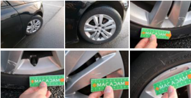
Jante alum. ARD, Déformé / Forcé, E - Remplacer
