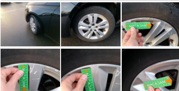
Jante alum. AVG, Déformé / Forcé, E - Remplacer
