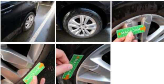
Jante alum. AVG, Déformé / Forcé, E - Remplacer
