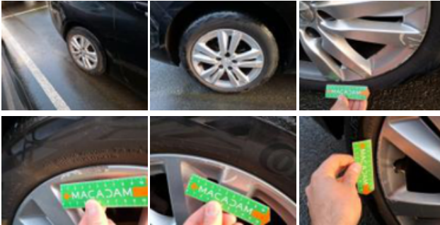
Jante alum. ARG, Déformé / Forcé, E - Remplacer
