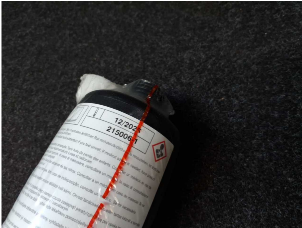
Beschädigung #1: Ausrüstung: Tirefit Füllmittel (12.2025) - abgelaufen - erneuern
