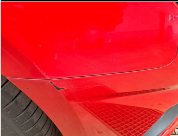
Beschädigung #5: Kotflügel rechts: Kotflügel rechts - Kratzer - lackieren
