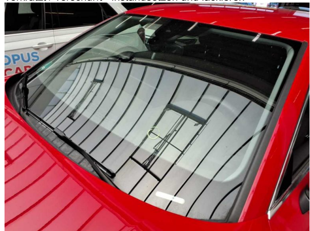
Beschädigung #8: Verglasung: Frontscheibe mit Regensensor (Mit rissbildung) - Steinschlag - erneuern
