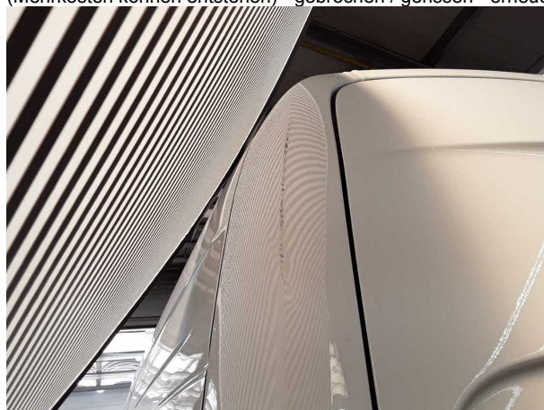
Beschädigung #6: Karosserie: Eckbeplankung links - verformt - instandsetzen und lackieren
