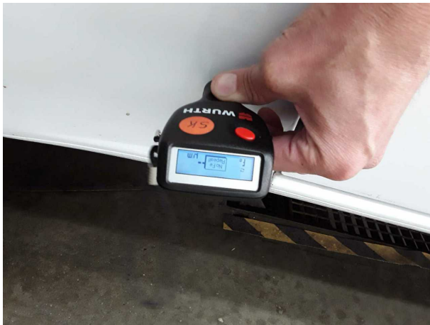
Beschädigung #9: Seitenwand rechts: Seitenwand (Nicht messbar/ Mehrkosten können entstehen) - nicht fachgerecht instandgesetzt -
