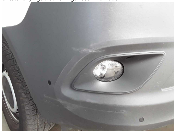
Beschädigung #8: Stossfänger vorn: Stossfänger mit Parktronic (Mehrkosten können entstehen) - verkratzt / verschürft - erneuern
