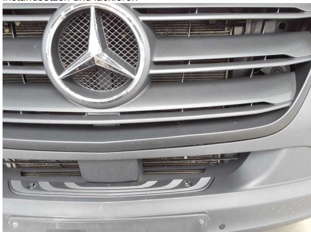
Beschädigung #7: Motorhaube: Kühlergrill (Mehrkosten können entstehen) - gebrochen / gerissen - erneuern
