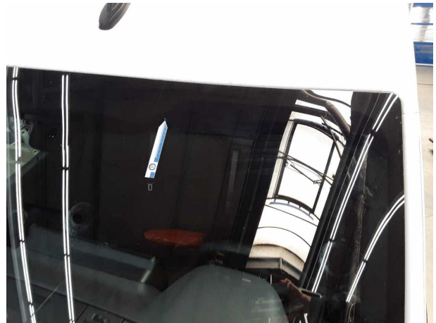
Beschädigung #10: Verglasung: Frontscheibe mit Spurhalteassistent - Steinschlag - erneuern
