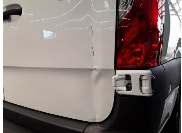
Beschädigung #11: Heckklappe/-tür: Hecktür rechts (Mehrkosten können entstehen) - verformt - erneuern
