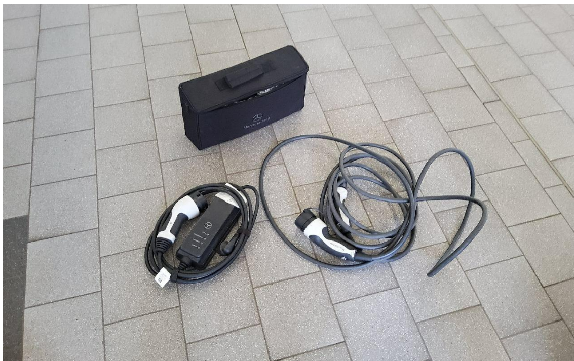
Bild 7 : Ladekabel beim E-Fahrzeug
