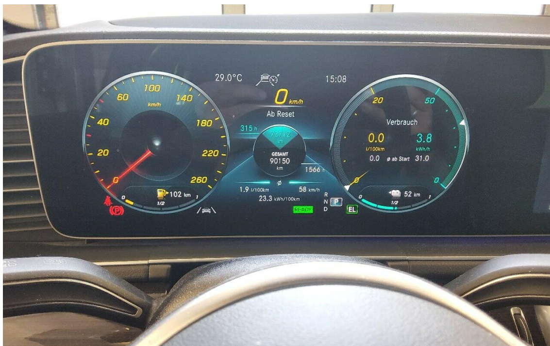
Bild 4 : Kombiinstrument (betriebsbereit) mit Km-Stand
