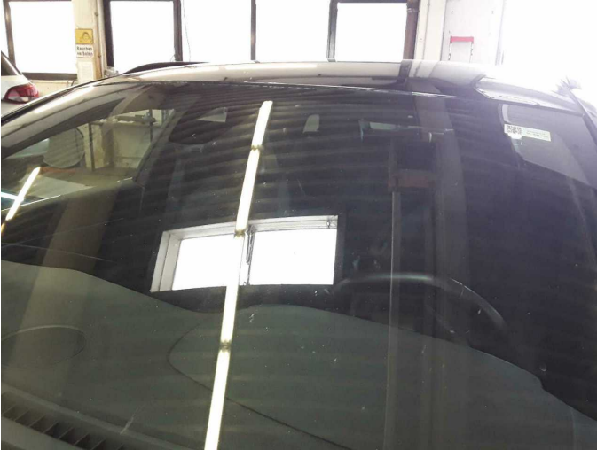
Damage 8: Vehicle glazing: Windscreen (Zu viele Steinschläge) - Stone chips - Replace
