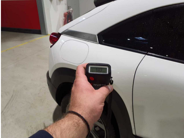
Nachlackierung 1: Seitenwand rechts
