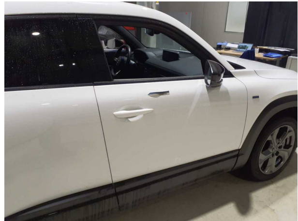
Beschädigung #4: Tür vorn rechts: Tür - Delle / Lackschade... instandsetzen und lackieren
