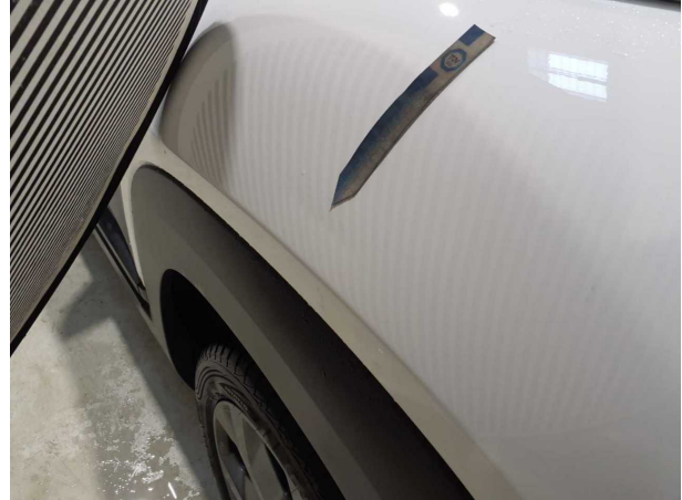
Beschädigung #1: Seitenwand links: Seitenwand (Druckstelle) - Delle(n) - sanft instandsetzen
