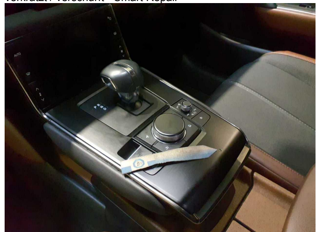
Beschädigung #3: Verkleidungen/Abdeckungen: Zierleiste / Dekorleiste - beschädigt - erneuern
