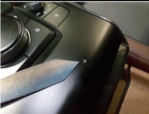
Beschädigung #3: Verkleidungen/Abdeckungen: Zierleiste / Dekorleiste - beschädigt - erneuern
