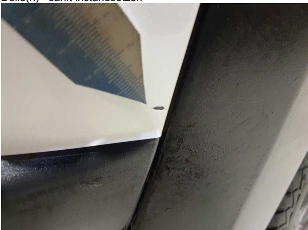
Beschädigung #2: Stossfänger vorn: Stossfänger vorn links - verkratzt / verschürft - Smart Repair
