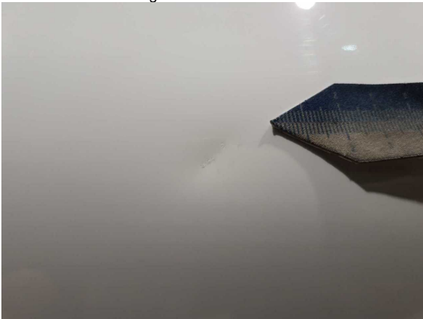
Beschädigung #4: Tür vorn rechts: Tür - Delle / Lackschaden - instandsetzen und lackieren
