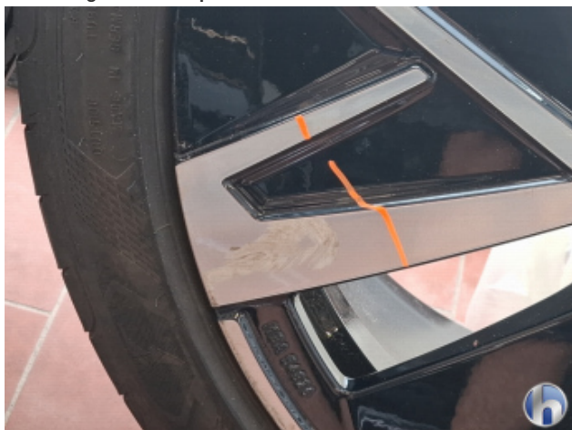
2. 2. Radsatz Beschädigt - Smart Repair
