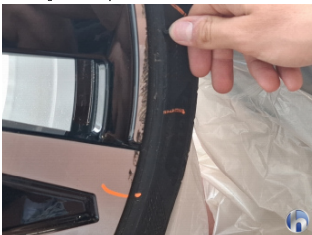
2. 2. Radsatz Beschädigt - Smart Repair
