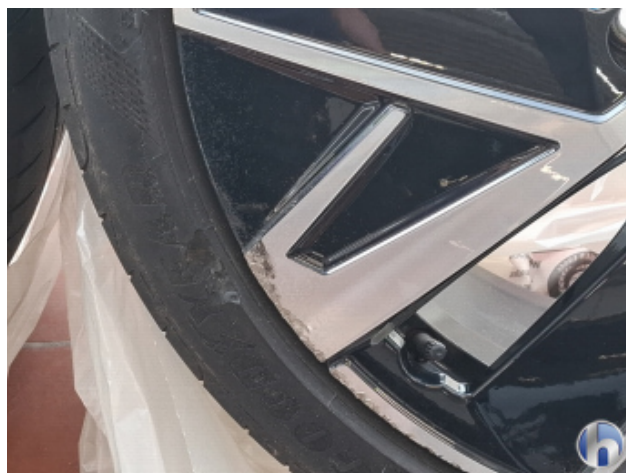
2. 2. Radsatz Beschädigt - Smart Repair
