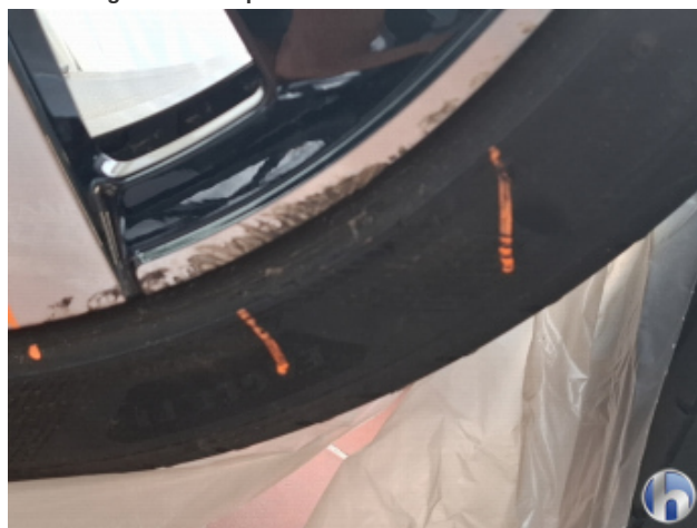
2. 2. Radsatz Beschädigt - Smart Repair
