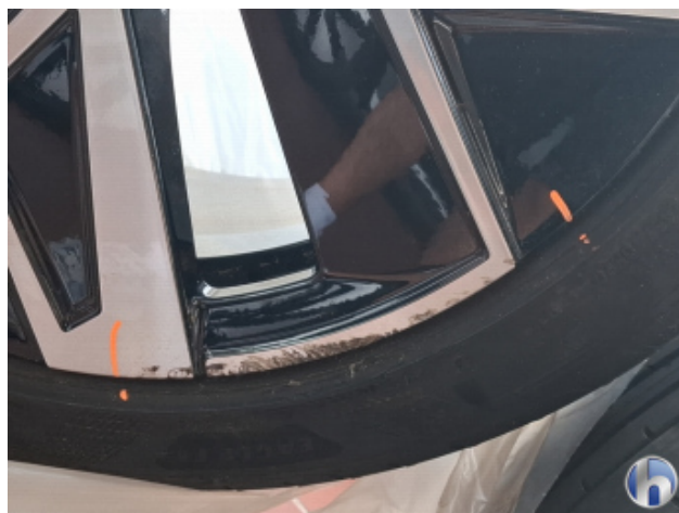
2. 2. Radsatz Beschädigt - Smart Repair
