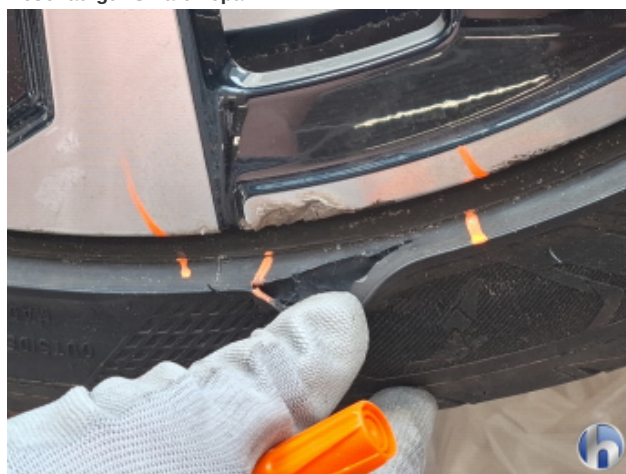
2. 2. Radsatz Beschädigt - Smart Repair
