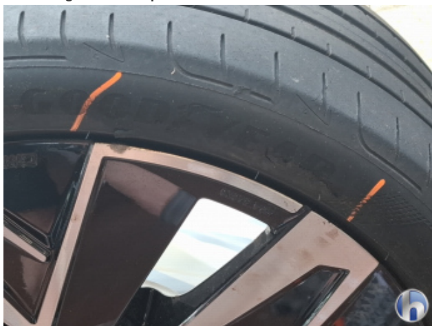
2. 2. Radsatz Beschädigt - Smart Repair
